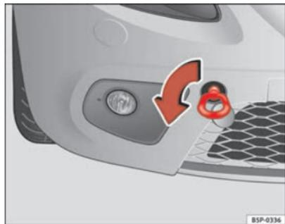
**Fig. 198** Lato anteriore destro del veicolo: montaggio dell'anello per traino anteriore
