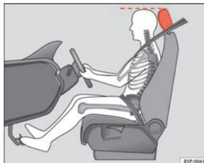
**Fig. 2** Corretto posizionamento del poggiatesta del conducente
