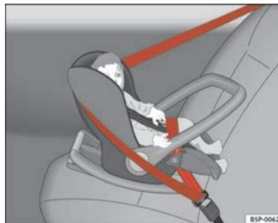
**Fig. 28** Seggiolino per bambini del gruppo 0, montato sul sedile posteriore e disposto nel senso contrario a quello di marcia
