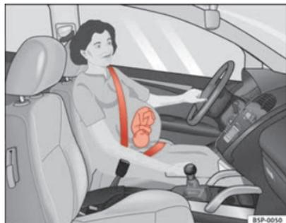
**Fig. 15** Posizione della cintura di sicurezza per donne in stato di gravidanza
