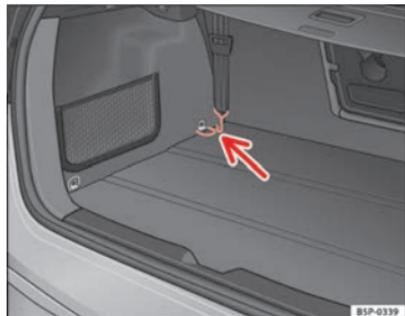
Fig. 125 Anelli di fissaggio per tendere la rete di separazione
