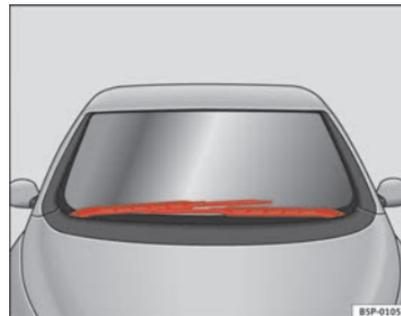
**Fig. 161** Tergicristallo in posizione di manutenzione
