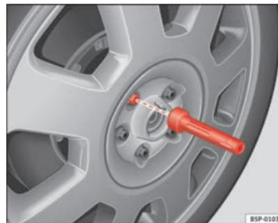
Fig. 173 Cambio di una ruota: utensile ad esagono cavo per svitare le viti
