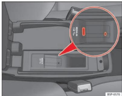
Fig. 121 Connessione nel bracciolo centrale
