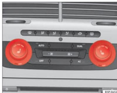
**Fig. 95** Riscaldamento sedili anteriori con Climatronic
