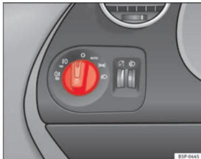
Fig. 71 Dettaglio della plancia portastrumenti: interruttore luci, fari fendinebbia e retronebbia
