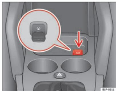
Fig. 119 Connettore per l'ingresso audio ausiliare
