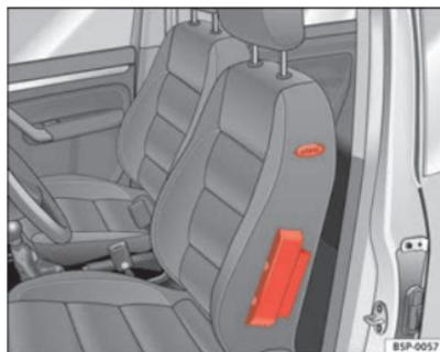
**Fig. 22** Airbag laterale all'interno del sedile del conducente
