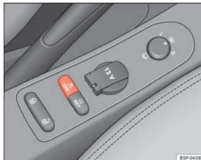
**Fig. 136** Dettaglio della console centrale: tasto ESP
