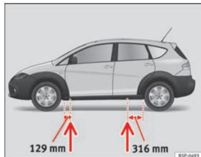
**Fig. 170** Punti di appoggio per il cric
