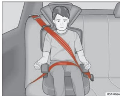
**Fig. 30** Seggiolino rivolto nel senso di marcia, montato sul sedile posteriore
