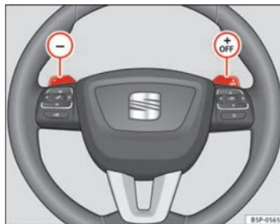
**Fig. 145** Volante con leve per il cambio automatico ▶
