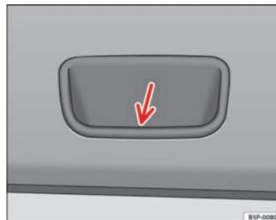
Fig. 65 Dettaglio del rivestimento interno del portellone posteriore: maniglia di presa ad incavo
