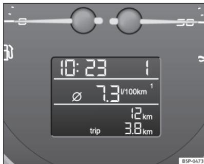
Fig. 43 Display digitale del quadro strumenti: Indicatore consumo medio di carburante
