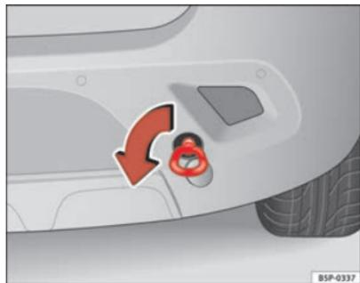
**Fig. 199** Lato posteriore del veicolo: montaggio dell'anello per traino
