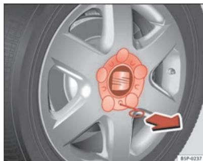
**Fig. 168** Cambio di una ruota: rimuovere il coprimozzo della ruota
