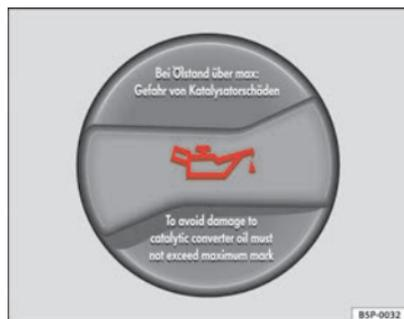
Fig. 158 Vano motore: tappo del bocchettone di rifornimento dell'olio motore
