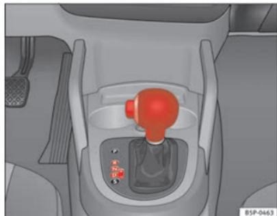
**Fig. 142** Disattivazione del bloccaggio della leva selettoria
