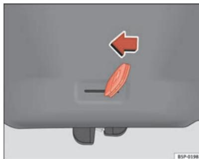
Fig. 66 Portellone posteriore: apertura d'emergenza
