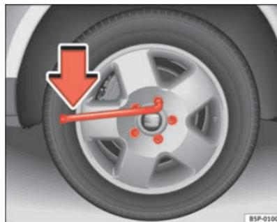
Fig. 169 Cambio di una ruota: allentare le viti della ruota
