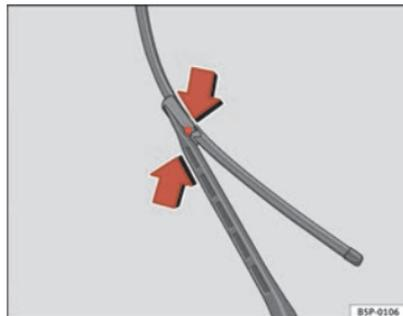
Fig. 162 Remplacement des balais d'essuie-glace
