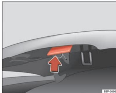
Fig. 156 Gâchette d'ouverture du capot-moteur.
