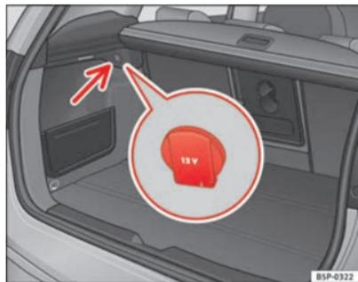
Fig. 118 Prise de courant dans le coffre à bagages
