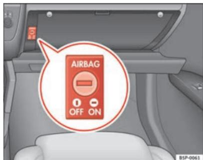
Fig. 26 Dans la boîte à gants se trouve commande à clé pour activer et désactiver les airbags côté passager avant
