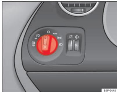
Fig. 71 Détail du tableau de bord : commande des feux, des projecteurs antibrouillard et du feu arrière de brouillard
