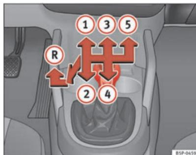
Fig. 138 Détail de la console centrale : schéma d'une boîte mécanique 5 vitesses
