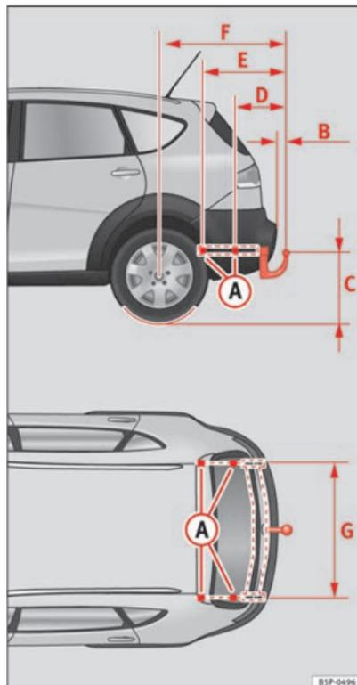
Fig. 153 Points de fixation du dispositif d'attelage
