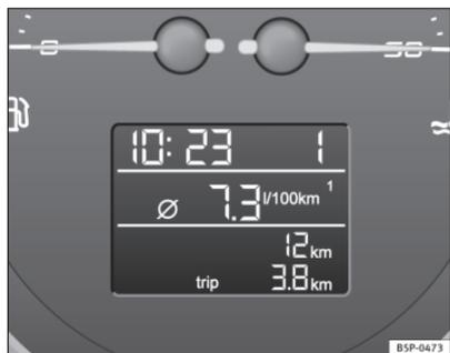
Fig. 41 Afficheur numérique du tableau de bord
