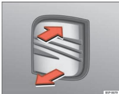
Fig. 64 Hayon : ouverture de l'extérieur
