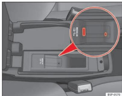
Fig. 121 Connexion dans l'accoudoir central
