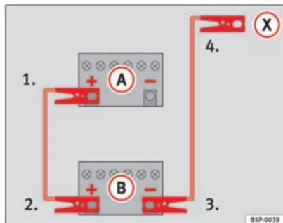
Fig. 196 Schéma de branchement des câbles d'urgence lorsque le véhicule fournissant le courant ne dispose pas du système Start-Stop : batterie déchargée (A) et batterie fournissant le courant (B).
