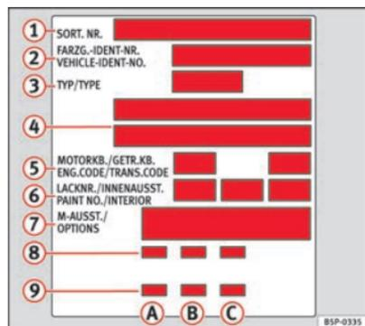
Fig. 200 Plaquette d'identification du véhicule - coffre à bagages
