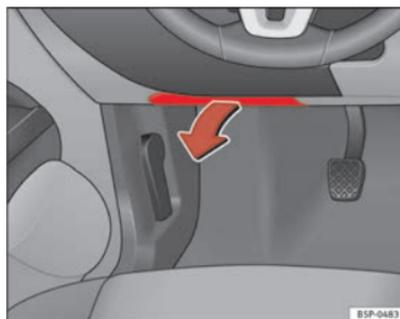
Fig. 175 À gauche dans la planche de bord : cache du boîtier de fusibles
