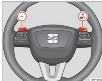
**Fig. 145** Volant avec leviers pour boîte de vitesses automatique
