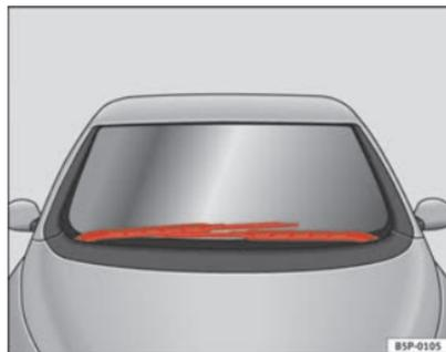
Fig. 161 Essuie-glace en position de maintenance
