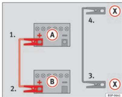
Fig. 197 Schéma de branchement des câbles d'urgence lorsque le véhicule fournissant le courant dispose du système Start-Stop : batterie déchargée (A) et batterie fournissant le courant (B).
