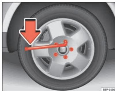
Fig. 169 Changement de roue : dévissez les vis de roue
