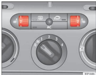
Fig. 94 Molettes des chauffages de sièges avant
