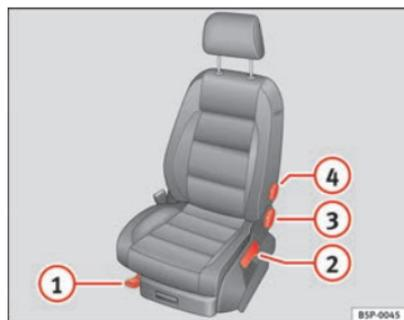
Fig. 93 Éléments de commande du siège avant gauche
