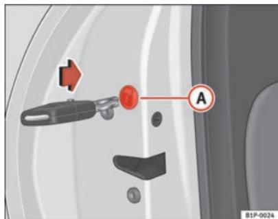
Fig. 58 Verrouillage d'urgence des portes
