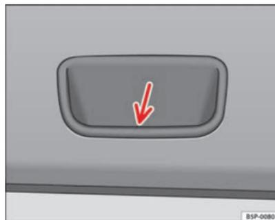
Fig. 65 Détail de la garniture intérieure du hayon : cavité pour tirer
