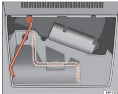
Fig. 70 Manivelle de fermeture d'urgence
