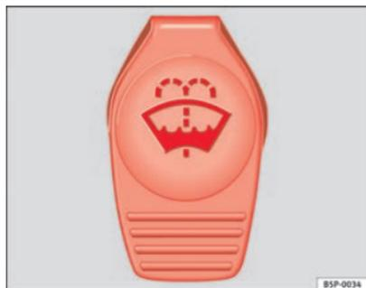
**Fig. 160** Dans le compartiment-moteur : bouchon du réservoir de lave-glace
