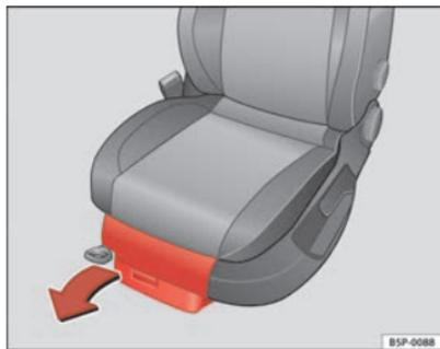
**Fig. 102** Rangements sous les sièges avant
