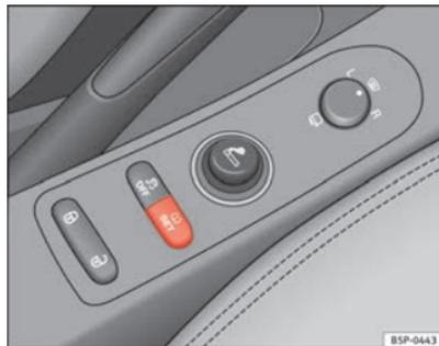
**Fig. 50** Console centrale : touche du système de contrôle des pneus
