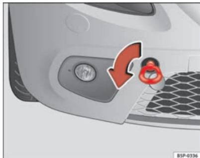
Fig. 198 Vissage de l'œillet de remorquage avant, côté droit
