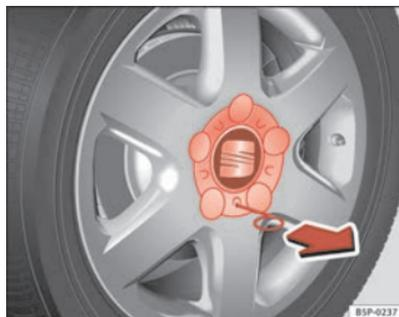
**Fig. 168** Changement de roue : Retirez l'enjoliveur de roue central.
