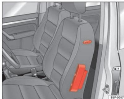
Fig. 22 Airbag latéral dans le siège du conducteur
