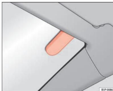
Fig. 85 Capteur de pluie\*
