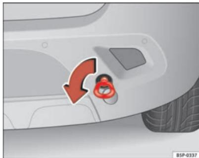
Fig. 199 Vissage de l'œillet de remorquage arrière
