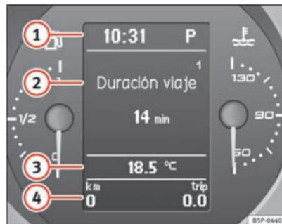
Fig. 38 Afficheur numérique du tableau de bord
