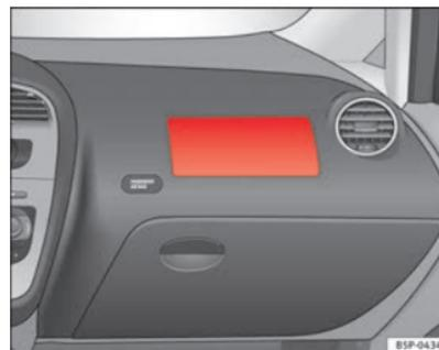
**Fig. 19 Airbag du passager avant dans la planche de bord**
