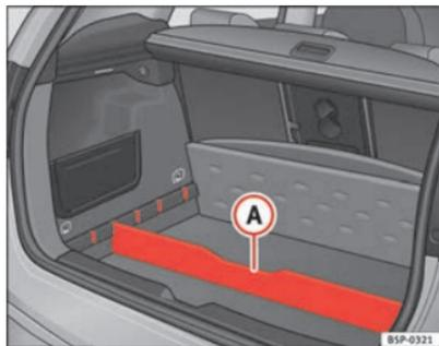
Fig. 106 Rangements variables dans le plancher du coffre à bagages
