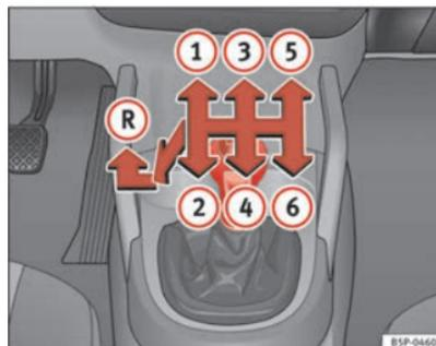
Fig. 139 Détail de la console centrale : schéma d'une boîte mécanique 6 vitesses
