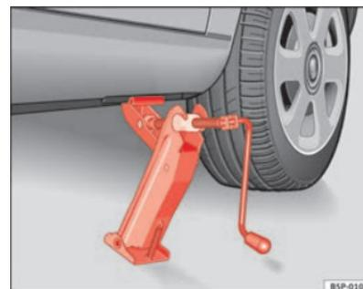
Fig. 171 Mise en place du cric
