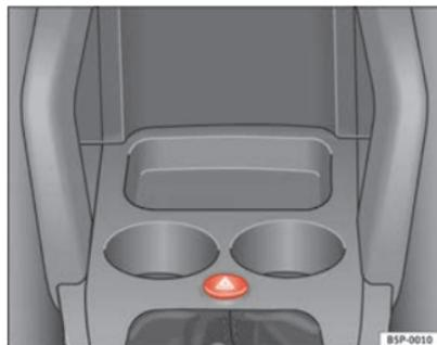
Fig. 75 Tableau de bord : commande des feux de détresse
