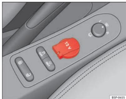
Fig. 117 Prise de courant sur la console centrale avant
