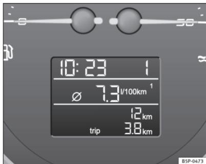
Fig. 43 Afficheur numérique du tableau de bord : indicateur consommation moyenne de carburant.
