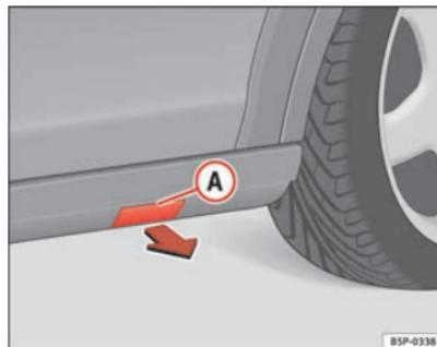
Fig. 172 Talonnette en plastique équipée d'une protection pour les points d'ancrage du cric
