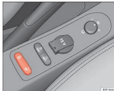
Fig. 57 Détail de la console centrale : touche de verrouillage centralisé
