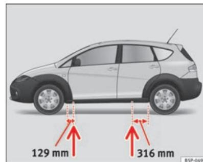
Fig. 170 Points d'appui du cric
