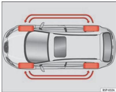
Fig. 166 Schéma de permutation des roues
