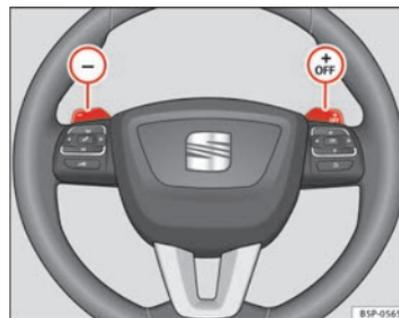
Abb. 145 Lenkrad mit Wippen für Automatikgetriebe
