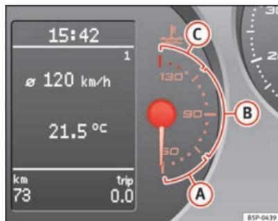
Abb. 36 Kombiinstrument: Motorkühlmitteltemperaturanzeige
