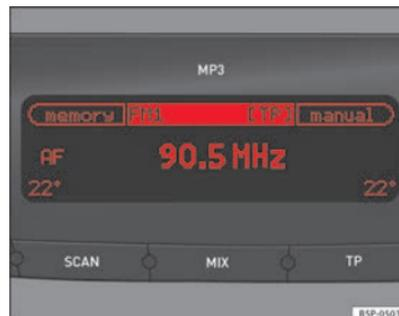
Abb. 132 Display des Radios mit Informationen der Climatronic
