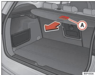
Abb. 122 Betätigung der Ablage
