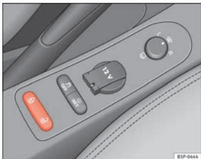
Abb. 57 Ansicht der Mittelkonsole: Taster für Zentralverriegelung
