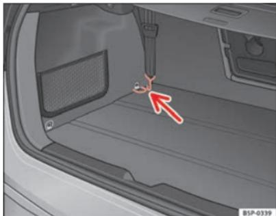
Abb. 125 Verzurrsen zum Spannen des Gepäckraumnetzes
