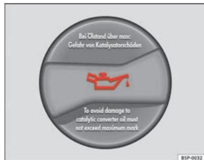
Abb. 158 Deckel der Motoröl-Einflüllöffnung im Motorraum
