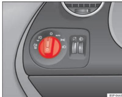
Abb. 72 Automatisches Fahrlicht
