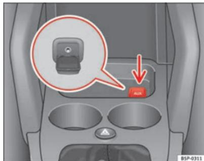
Abb. 119 Anschluss für einen zusätzlichen Audio-Eingang
