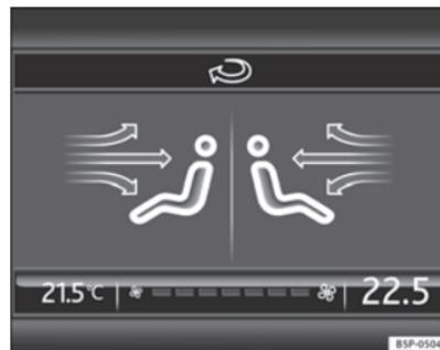
Abb. 131 Display des Navigationssystems mit Informationen der Climatronic
