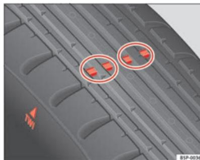
Abb. 165 Prinzipdarstellung Reifenprofil: Verschleißanzeiger
