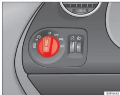
Abb. 71 Ausschnitt aus der Instrumententafel: Schalter für die Leuchten, Nebelscheinwerfer und Nebelschlussleuchte
