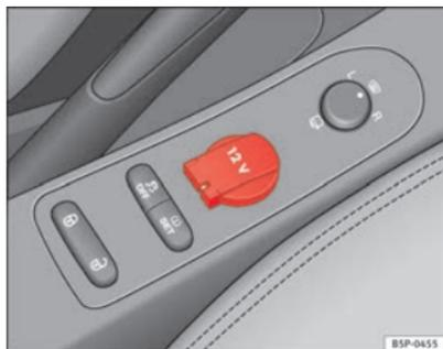
Abb. 117 Steckdose an der Mittelkonsole vorne
