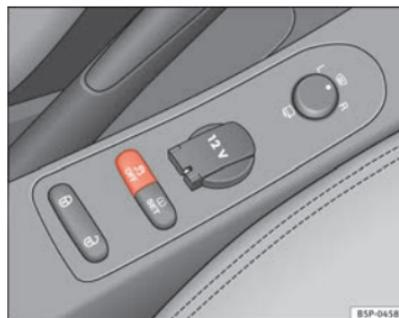
Abb. 136 Ansicht der Mittelkonsole: ESP-Taste
