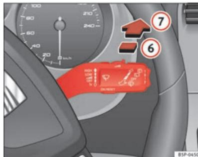
Abb. 87 Scheibenwischer- und Scheibenwaschhebel: Heckscheibenwischer
