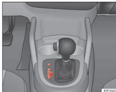
Abb. 140 Mittelkonsole: Wählhebel des Automatikgetriebes / Direktschaltgetriebes DSG
