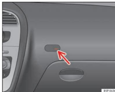
Abb. 27 Kontrollleuchte für Abschaltung der Beifahrerairbags
