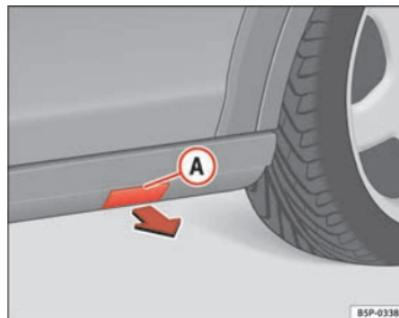
Abb. 172 Kunststoff-Trittleiste mit Deckel zur Aufnahme des Wagenhebers
