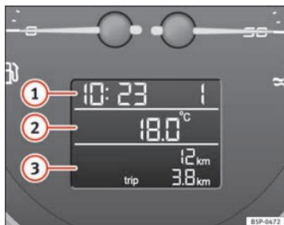
Abb. 37 Ausschnitt aus Kombiinstrument: Display mit verschiedenen Anzeigeelementen
