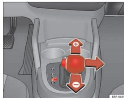
Abb. 144 Schalten mit Tiptronic
