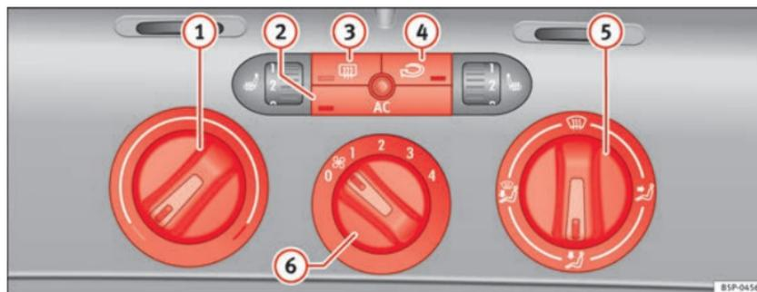
Abb. 129 In der Instrumententafel: Bedienelemente der Climatic
