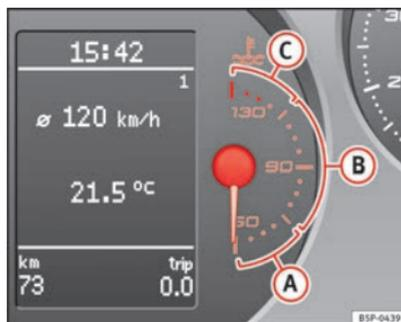
Abb. 36 Kombiinstrument: Motorkühlmitteltemperaturanzeige
