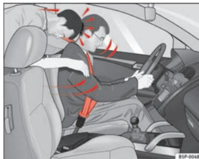
**Abb. 10** Der nicht angegurte Mitfahrer auf dem Rücksitz wird nach vorne auf den angegurtenen Fahrer geschleudert.
