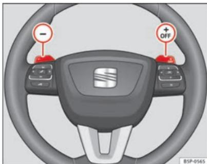
Abb. 147 Lenkrad mit Wippen für Automatikgetriebe
