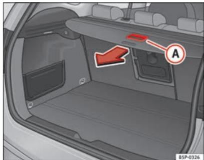
Abb. 122 Betätigung der Ablage
