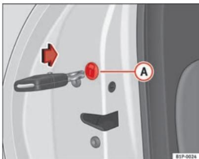
Abb. 58 Notverriegelung der Türen
