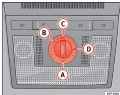
Abb. 69 Detailansicht des Dachhimmels: Drehschalter Schiebe-/Ausstelldach
