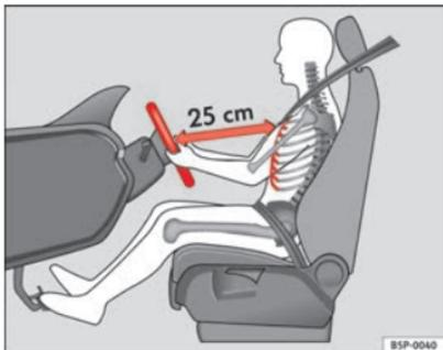
Abb. 1 Der richtige Abstand des Fahrers zum Lenkrad
