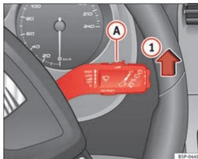
Abb. 86 Scheibenwischerhebel
