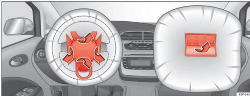
Abb. 21 Airbagabdeckungen bei ausgelösten Frontairbags
