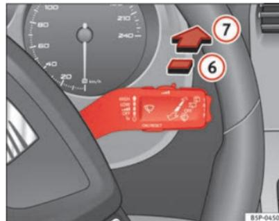
Abb. 87 Scheibenwischer- und Scheibenwaschhebel: Heckscheibenwischer
