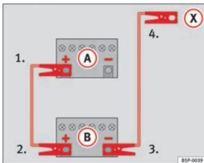
Abb. 197 Schaltschema zum Anschluss der Starthilfekabel, falls das stromgebende Fahrzeug über kein Start-Stopp-System verfügt: entladene Batterie (A) und stromgebende Batterie (B).
