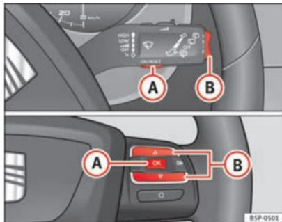
Abb. 42 Wipptasten A und B. Bedienelemente am Lenkrad.
