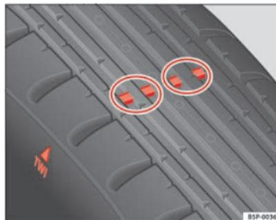
Abb. 167 Prinzipdarstellung Reifenprofil: Verschleißanzeiger
