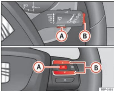
Abb. 40 Wipptasten A und B. Bedienelemente am Lenkrad.
