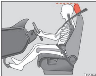
Abb. 2 Die richtige Kopfstützeinstellung für den Fahrer
