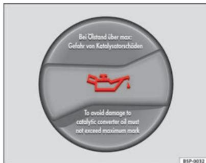
Abb. 160 Deckel der Motoröl-Einfüllöffnung im Motorraum
