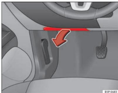
Abb. 176 Links in der Instrumententafel: Abdeckung des Sicherungskastens
