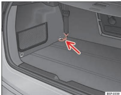
Abb. 125 Verzurösen zum Spannen des Gepäckraumnetzes
