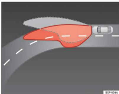
Abb. 74 Beleuchtung der Kurve mit Kurvenfahrlicht
