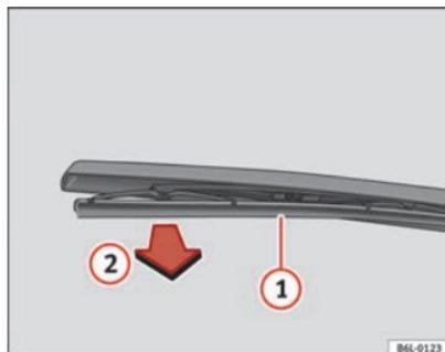
Abb. 165 Scheibenwischerblatt hinten auswechseln
