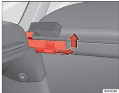
Abb. 123 Ausbau der Ablage
