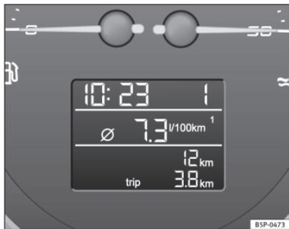
Abb. 43 Display im Kombiinstrument: Anzeige des durchschnittlichen Kraftstoffverbrauchs.
