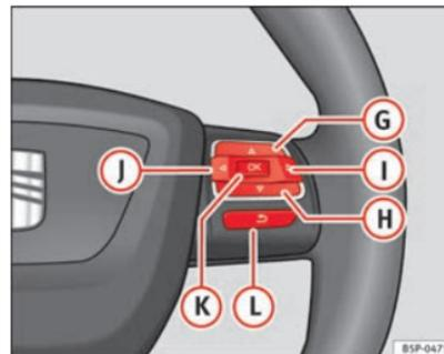
Abb. 54 Bedienelemente am Lenkrad (modellabhängig)
