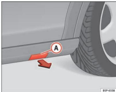
Abb. 174 Kunststoff-Trittleiste mit Deckel zur Aufnahme des Wagenhebers
