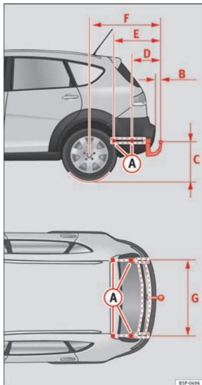
Abb. 155 Befestigungspunkte für die Anhängervorrichtung
