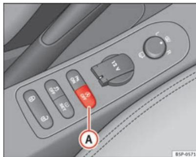
Abb. 138 Ansicht des Tasters für den Start-Stopp-Betrieb
