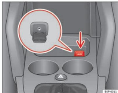
Abb. 119 Anschluss für einen zusätzlichen Audio-Eingang
