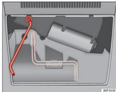
Abb. 70 Kurbel für Notverriegelung
