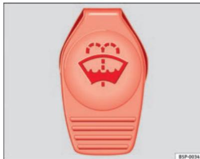
Abb. 162 Im Motorraum: Deckel des Scheibenwaschwasserbehälters
