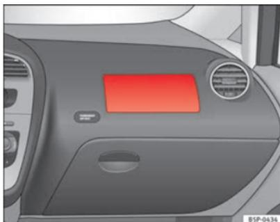
Abb. 19 Einbautort Beifahrerairbag: in der Instrumententafel
