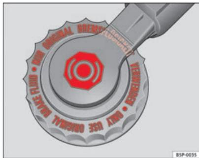
Abb. 166 Im Motorraum: Abdeckung des Bremsflüssigkeitsbehälters
