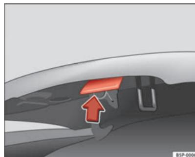
Abb. 158 Riegel der Motorraumklappe
