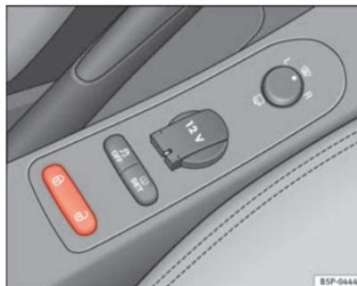
Abb. 57 Ansicht der Mittelkonsole: Taster für Zentralverriegelung
