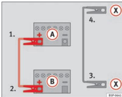
Abb. 198 Schaltschema zum Anschluss der Starthilfekabel, falls das stromgebende Fahrzeug mit einem Start-Stopp-System ausgestattet ist: entladene Batterie (A) und stromgebende Batterie (B).
