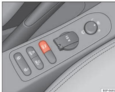
Fig. 153 Consola central: Interruptor de auxílio de estacionamento
