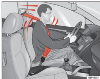
**Fig. 11** Condutor com o cinto de segurança correctamente colocado: é retido pelo mesmo em caso de travagem brusca
