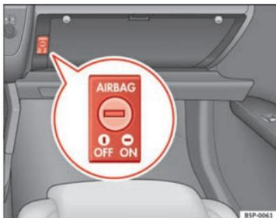
Fig. 26 No porta-luvas: comutador com chave para activar e desactivar o airbag do passageiro
