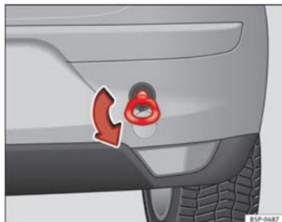
Fig. 217 Aparafusar a argola de reboque na parte traseira do veículo
