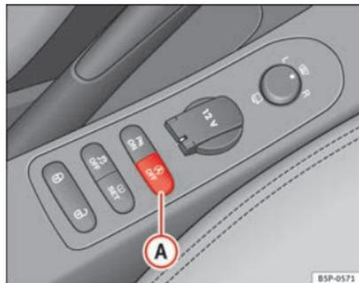
Fig. 142 Pormenor do botão do funcionamento Start-Stop.
