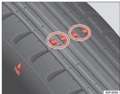
**Fig. 176** Indicadores de desgaste no perfil do pneu
