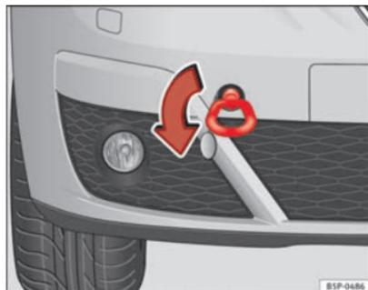
Fig. 216 Enroscamento da argola de reboque na parte dianteira direita do veículo
