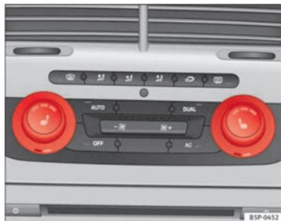
**Fig. 94 Aquecimento dos bancos dianteiros com Climatronic**
