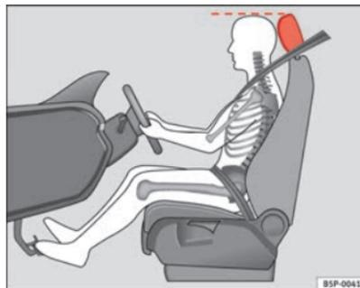
**Fig. 2** Posição correcta do encosto de cabeça do condutor
