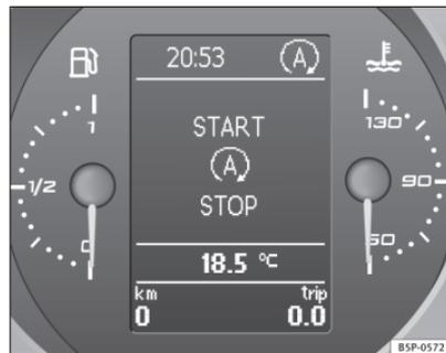
Fig. 143 Indicação no visor do painel de instrumentos durante o funcionamento Start-Stop.
