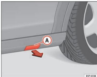
Fig. 183 Embaladeira de plástico com tampa para fixação do macaco
