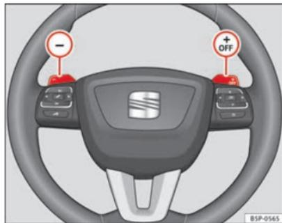
Fig. 151 Volante com pautas para a caixa de velocidades automática
