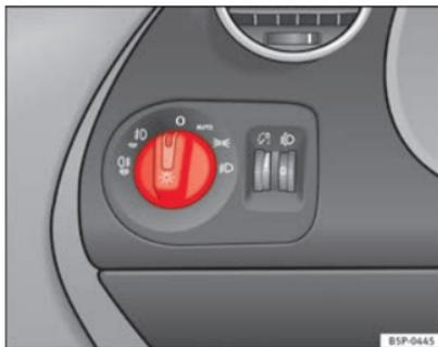
Fig. 70 Pormenor do painel de instrumentos: comando das luzes, faróis de nevoeiro e luz de nevoeiro traseira
