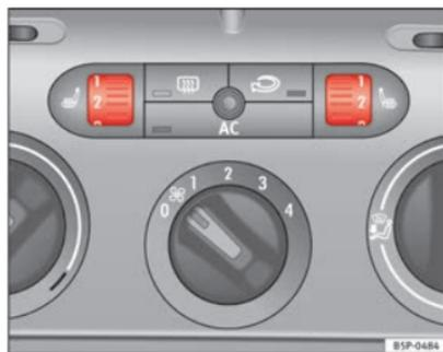
**Fig. 93 Rodas recartilhadas do aquecimento dos bancos dianteiros**
