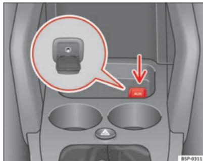
Fig. 119 Conector para a entrada auxiliar de áudio
