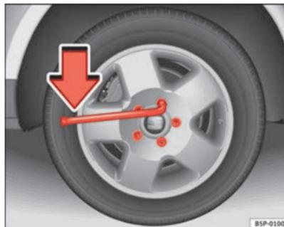
**Fig. 180** Substituição de roda: desapertar os parafusos da roda
