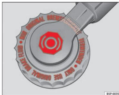
**Fig. 175** Tampão do reservatório do líquido dos travões no compartimento do motor
