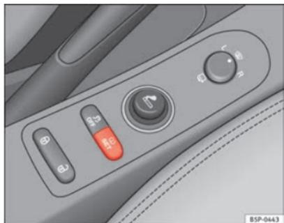
Fig. 50 Consola central: botão do sistema de controlo dos pneus
