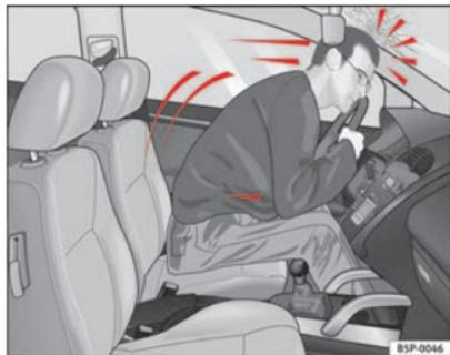
**Fig. 9 O condutor sem o cinto de segurança colocado é projectado para a frente**
