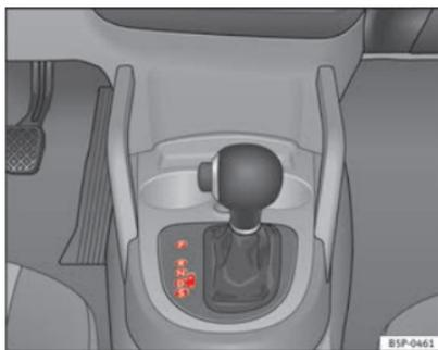
Fig. 146 Consola central: alavanca seletora da caixa de velocidades automática / caixa de velocidades automática DSG
