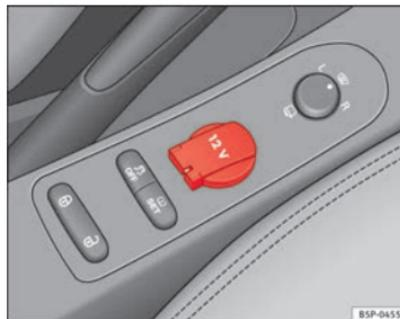
Fig. 117 Tomada de corrente na consola central dianteira
