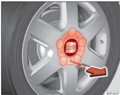
Fig. 179 Substituição de roda: Retirar o embelezador da roda
