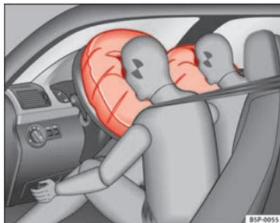
**Fig. 20 Airbags frontais insuflados**
