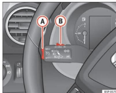
Fig. 154 Palanca de intermitentes y de luz de carretera: conmutador y tecla basculante para el regulador de velocidad
