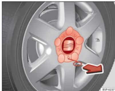
Fig. 179 Cambio de rueda: Retirar el embellecedor de la rueda
