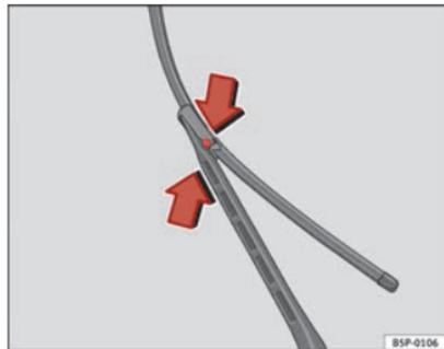
Fig. 171 Cambio de las escobillas del limpiaparabrisas
