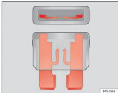
Fig. 187 Representación de un fusible fundido.
