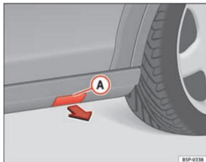
Fig. 183 Talonera de plástico con tapa para anclaje de gato
