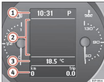
Fig. 39 Pantalla digital del cuadro de instrumentos
