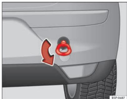
Fig. 217 Atornillado de la argolla de remolque en la parte trasera del vehículo
