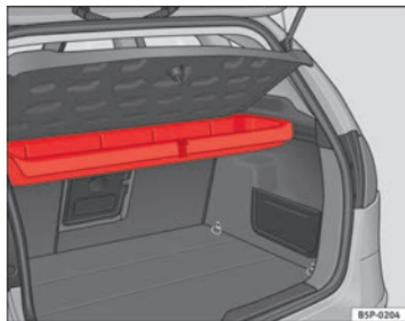
Fig. 122 ALTEA: Alojamiento para el triángulo de preseñalización bajo la bandeja posterior
