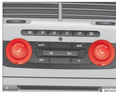
Fig. 94 Calefacción asientos delanteros con Climatronic
