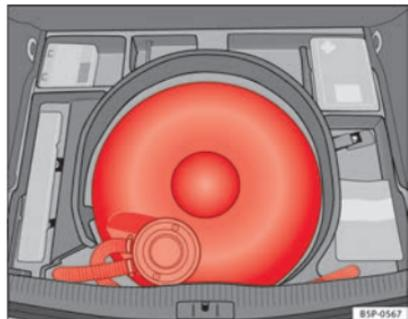
Fig. 161 Depósito de GLP en la cavidad de la rueda de repuesto.
