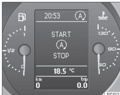
Fig. 143 Indicación en la pantalla del cuadro de instrumentos durante el funcionamiento Start-Stop.
