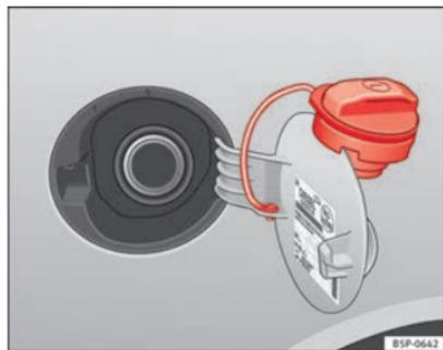
Fig. 159 Tapa del depósito abierta
