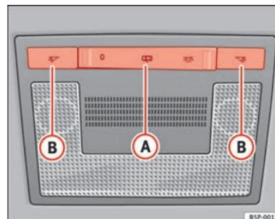
Fig. 79 Revestimiento interior del techo: luces delanteras de lectura tipo 2
