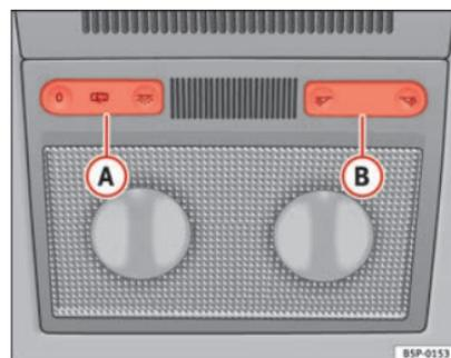
Fig. 78 Revestimiento interior del techo: luces delanteras de lectura tipo 1
