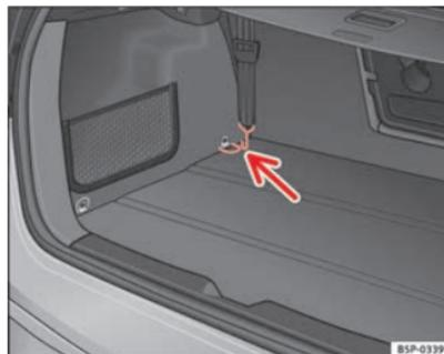
Fig. 128 Argollas de amarre para tensar la red separadora
