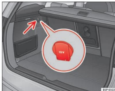
Fig. 118 Modelo Altea XL/Freetrack: toma de corriente en maletero ▶
