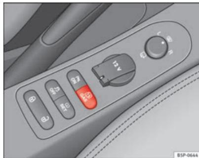
Fig. 141 Consola central: conmutador de control del sistema de gas.
