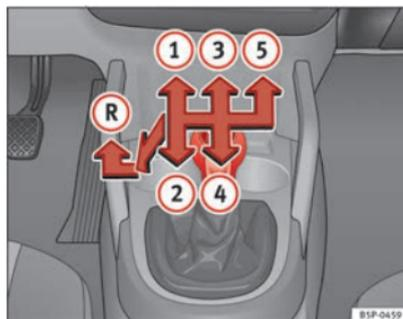
Fig. 144 Detalle de la consola central: esquema de un cambio manual de 5 marchas
