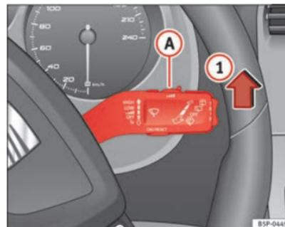
Fig. 85 Palanca del limpiaparabrisas ▶
