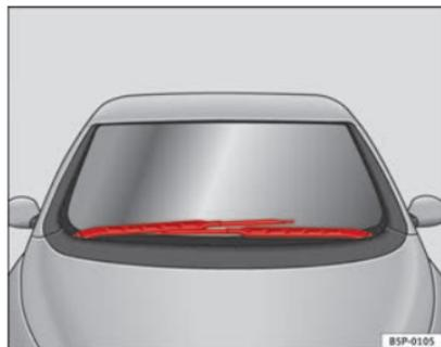
Fig. 170 Limpiacristales en la posición para realizar el cambio
