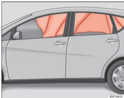
**Fig. 25 Airbags para la cabeza inflados**
