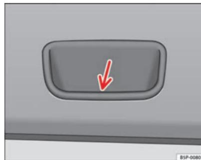
Fig. 65 Detalle del guardado interior del portón trasero: cavidad para tirar
