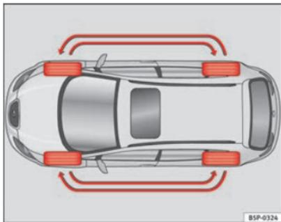
Fig. 177 Esquema para el cambio de ruedas
