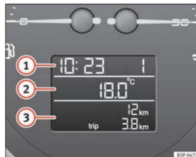
Fig. 38 Detalle del cuadro de instrumentos: pantalla con diferentes indicadores
