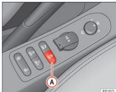
Fig. 142 Detalle del pulsador del funcionamiento Start-Stop.
