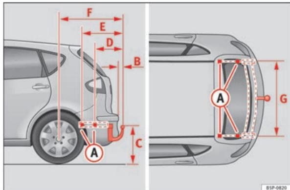
Fig. 158 Puntos de fijación del dispositivo de remolque
