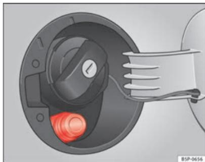
Fig. 163 Tapa del depósito abierta con racor tipo EURO.
