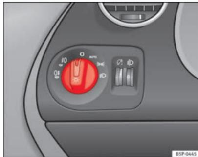
Fig. 70 Detalle del tablero de instrumentos: mando de las luces, faros antiniebla y luz trasera antiniebla
