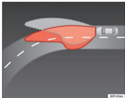
Fig. 73 Iluminación de la curva con faros autodireccionables
