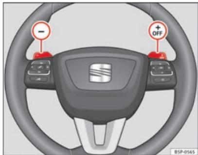
Fig. 151 Volante con palancas para cambio automático
