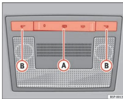
Fig. 77 Revestimiento interior del techo: iluminación delantera del habitáculo
