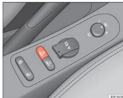
**Fig. 139** Detalle de la consola central: tecla ESC.
