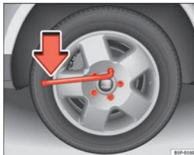
**Fig. 180** Cambio de rueda: aflojar los tornillos de rueda
