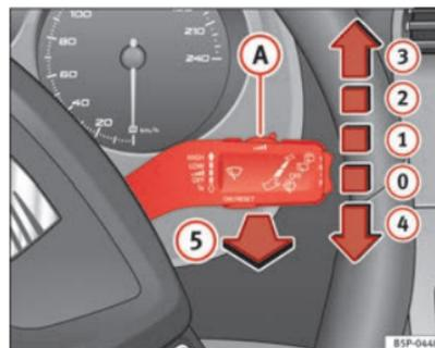
Fig. 83 Palanca del limpia-lavacristales
