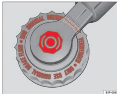
Fig. 175 Tapón del depósito del líquido de frenos en el vano motor
