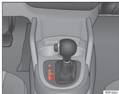
Fig. 146 Consola central: palanca selectora del cambio automático / cambio automático DSG
