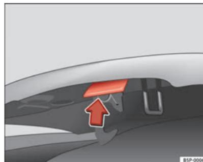
Fig. 165 Gancho apertura capó motor.
