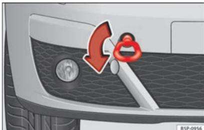
Fig. 165 Lato anteriore destro del veicolo: montaggio dell'occhio di traino anteriore.
