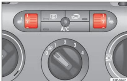
**Fig. 77** Rotelle zigrinate per il riscaldamento dei sedili anteriori.
