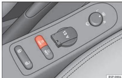
**Fig. 131** Dettaglio della console centrale: tasto ESC.
