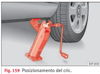
Fig. 159 Posizionamento del cric.
