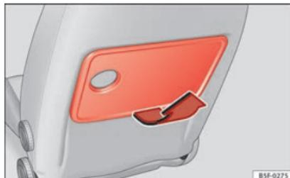
Fig. 86 Tavolinetto ripiegabile del sedile anteriore sinistro.
