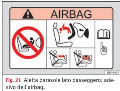
Fig. 21 Aletta parasole lato passeggero: adesivo dell'airbag.
