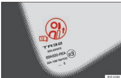
Fig. 6 Etichetta di avvertimento della posizione del poggiatesta.
