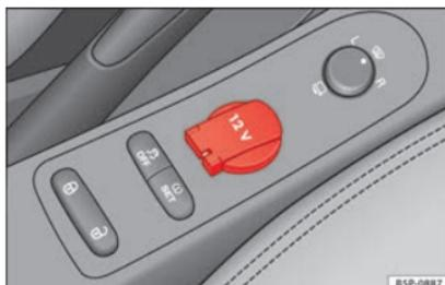
**Fig. 97** Presa di corrente nella console centrale anteriore.
