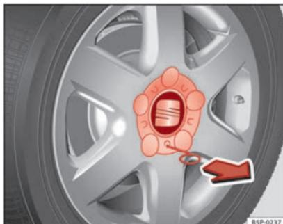
**Fig. 155** Cambio di una ruota: rimuovere il coprimozzo della ruota.
