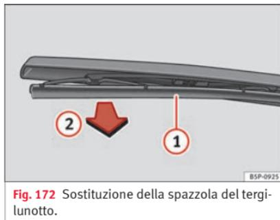
Fig. 172 Sostituzione della spazzola del tergilunotto.
