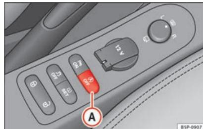
Fig. 132 Dettaglio del pulsante della modalità Start-Stop.
