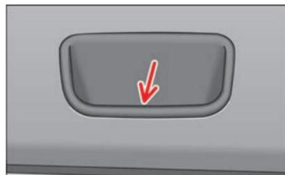
Fig. 54 Dettaglio del rivestimento interno del portellone posteriore: maniglia di presa ad incavo.
