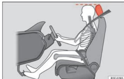
**Fig. 2** Corretto posizionamento della poggiatesta del conducente.
