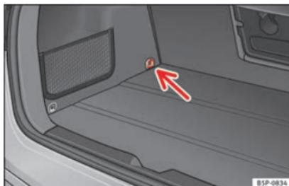
**Fig. 24** Occhiello di fissaggio del sistema Top Tether\*.
