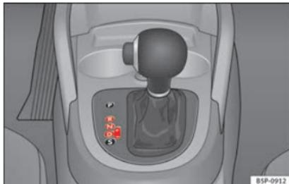
**Fig. 126** Console centrale: leva selettice del cambio automatico.
