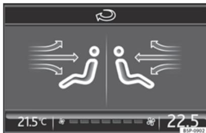
Fig. 118 Display del navigatore con informazioni del Climatronic.
