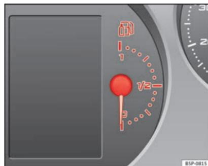
**Fig. 28** Quadro strumenti: Indicatore del livello del GPL
