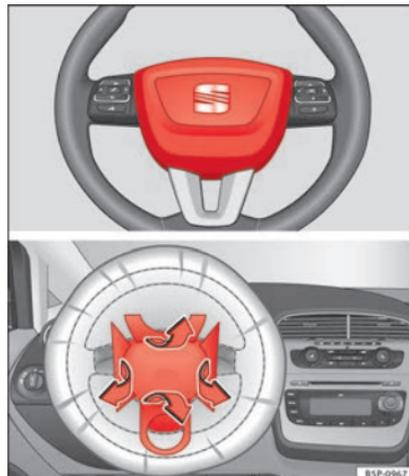
Fig. 13 Airbag del conducente nel volante. »
