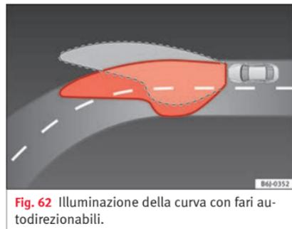
**Fig. 62** Illuminazione della curva con fari autodirezionabili.
