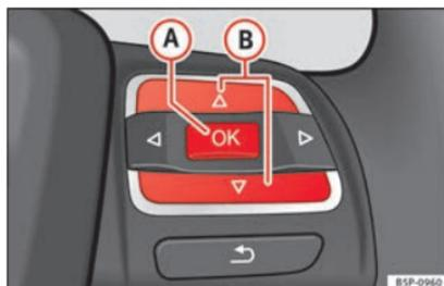
**Fig. 40** Comandi sul volante: tasti di controllo.
