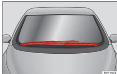
**Fig. 169** Tergicristallo in posizione di manutenzione.
