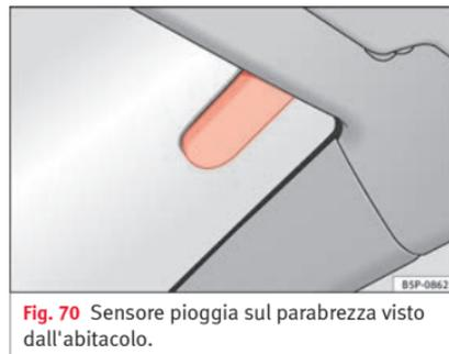
Fig. 70 Sensore pioggia sul parabrezza visto dall'abitacolo.
