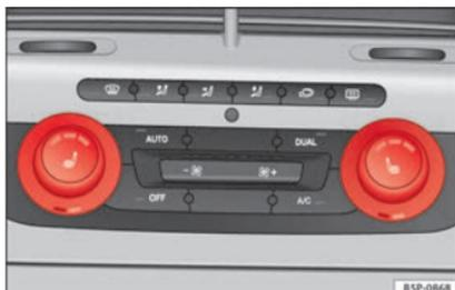
**Fig. 78** Riscaldamento sedili anteriori con Climatronic.
