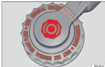
Fig. 151 Vano motore: tappo del serbatoio del liquido dei freni.
