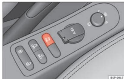
Fig. 134 Consolle centrale: Interruttore del sistema di assistenza per il parcheggio.
