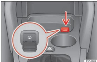
**Fig. 99** Connettore per l'ingresso audio ausiliare.
