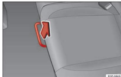
**Fig. 79** Leva di sblocco del sedile posteriore.
