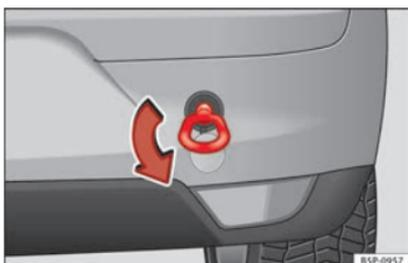
Fig. 166 Lato posteriore del veicolo: montaggio dell'occhio di traino.
