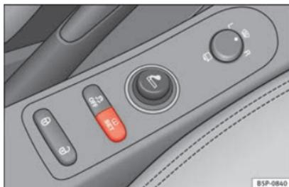
**Fig. 32** Consolle centrale: tasto del sistema di controllo degli pneumatici.
