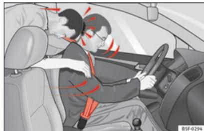
**Fig. 9** El ocupante del asiento trasero que no lleve puesto el cinturón de seguridad se verá lanzado hacia delante sobre el conductor que sí lleva el cinturón.
