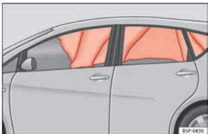
**Fig. 18** Airbags para la cabeza inflados.
