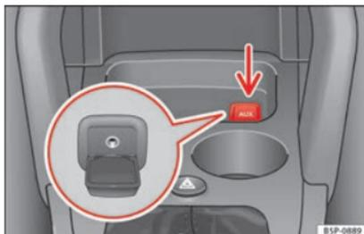
**Fig. 99** Conector para la entrada auxiliar de audio.
