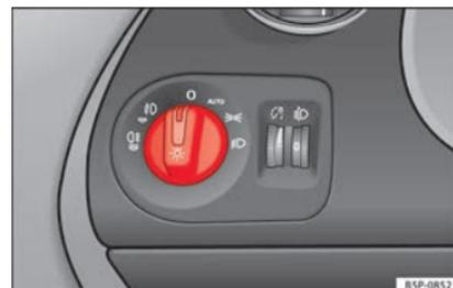
**Fig. 58** Detalle del tablero de instrumentos: mando de las luces, faros antiniebla y luz trasera antiniebla.
