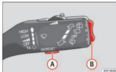
**Fig. 39** Palanca del limpiacristales: teclas de control.
