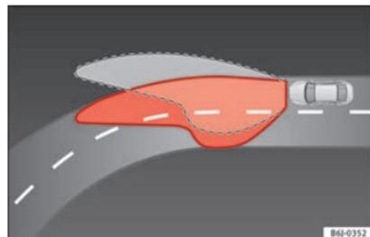
Fig. 62 Iluminación de la curva con faros autodireccionables.
