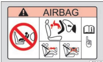
Fig. 21 Paraisol del lado del acompañante: adhesivo del airbag.
