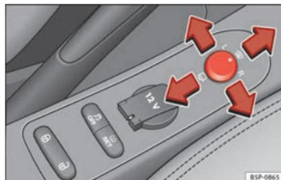
**Fig. 73** Mando de los retrovisores exteriores.
