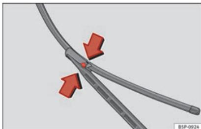
**Fig. 170** Cambio de las escobillas del limpiaparabrisas.
