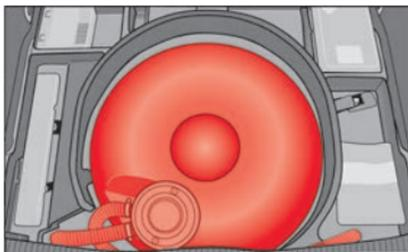
**Fig. 141** Depósito de GLP en la cavidad de la rueda de repuesto.
