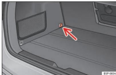
Fig. 24 Anilla de sujeción Top Tether\*.
