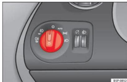
Fig. 59 Encendido automático de luces.
