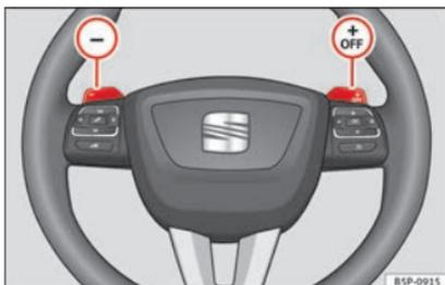
Fig. 129 Volante con palancas para cambio automático.
