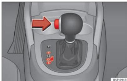
Fig. 127 Consola central: palanca selectora del cambio automático.
