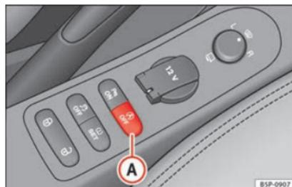
Fig. 132 Detalle del pulsador del funcionamiento Start-Stop.
