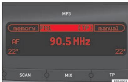
Fig. 119 Pantalla de la radio con información del Climatronic.
