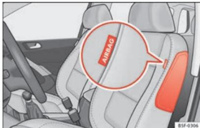
Fig. 15 Airbag lateral en el asiento del conductor.
