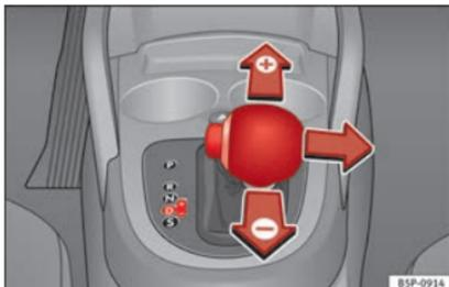
Fig. 128 Cambiar con Tiptronic.
