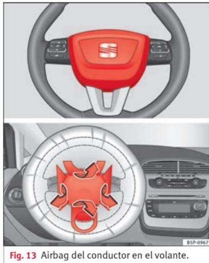
Fig. 13 Airbag del conductor en el volante.
