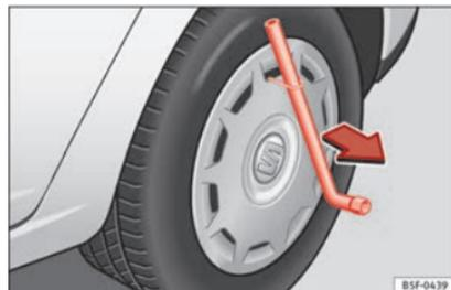
Fig. 156 Cambio de rueda: retirar el embellecedor integral.
