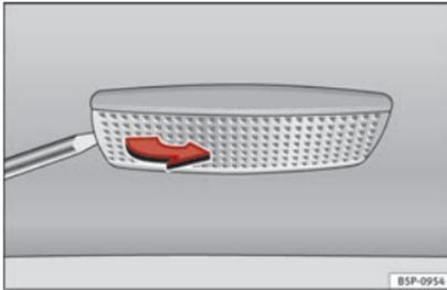
**Fig. 200** Desmontaje de la luz del parasol.
