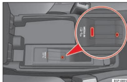
**Fig. 101** Conexión en el reposabrazos central.
