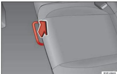
**Fig. 79** Barra de desbloqueo del asiento posterior.
