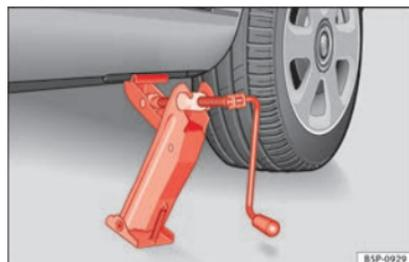
**Fig. 159** Colocación del gato.
