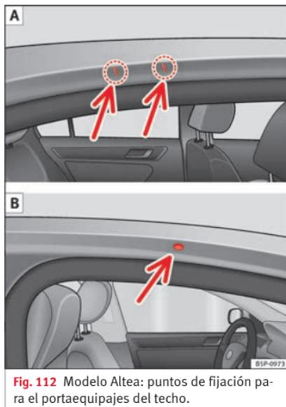
**Fig. 112** Modelo Altea: puntos de fijación para el portaequipajes del techo.
