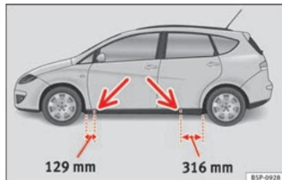
**Fig. 158** Puntos de apoyo del gato.
