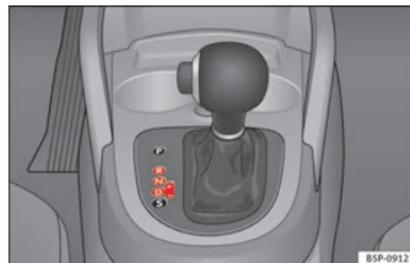
**Fig. 126** Consola central: palanca selectora del cambio automático.
