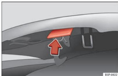
Fig. 145 Gancho de apertura del capó del motor.
