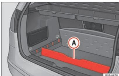
**Fig. 110** Separador del suelo del maletero.
