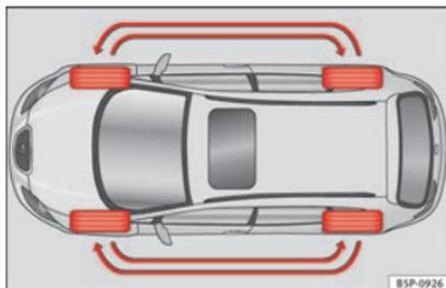
Fig. 153 Esquema para el cambio de ruedas.
