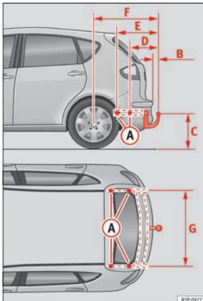
**Fig. 138** Puntos de fijación del dispositivo de remolque.
