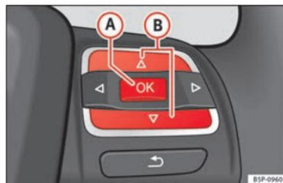
**Fig. 40** Mandos en el volante: teclas de control.
