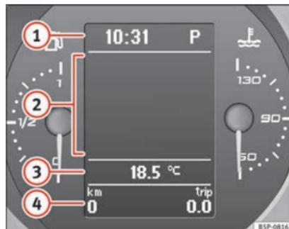
Fig. 34 Pantalla digital del cuadro de instrumentos.
