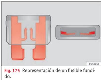
Fig. 175 Representación de un fusible fundido.
