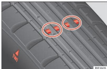
Fig. 152 Indicadores de desgaste del perfil del neumático.
