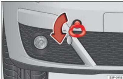
**Abb. 165** Frontpartie rechts: Einschrauben der vorderen Abschleppöse.
