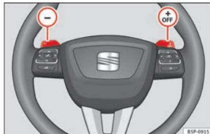
Abb. 129 Lenkrad mit Wippen für Automatikgetriebe.
