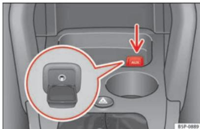
**Abb. 99** Anschluss für einen zusätzlichen Audio-Eingang.
