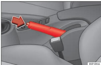
Abb. 123 Handbremse zwischen den Vordersitzen.
