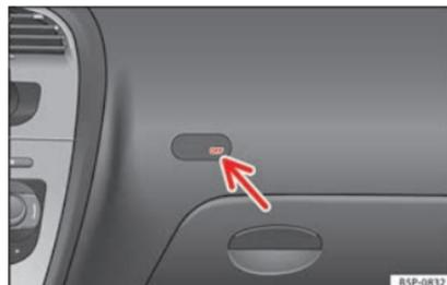
**Abb. 20** Kontrollleuchte für Abschaltung der Beifahrerairbags
