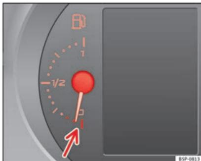
Abb. 27 Ausschnitt aus Kombiinstrument: Kraftstoffvorrats-Anzeige.
