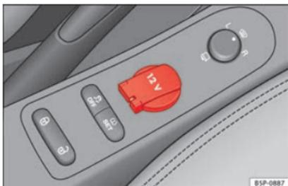
**Abb. 97** Steckdose an der Mittelkonsole vorne.
