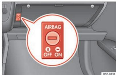
**Abb. 19** Im Handschuhfach: Schlüsselschalter zum Ein- und Abschalten des Beifahrer-Airbags
