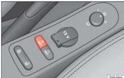
Abb. 131 Ausschnitt aus der Mittelkonsole: ESC-Taste.
