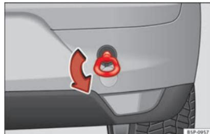
**Abb. 166** Einschrauben der Abschleppöse hinten.
