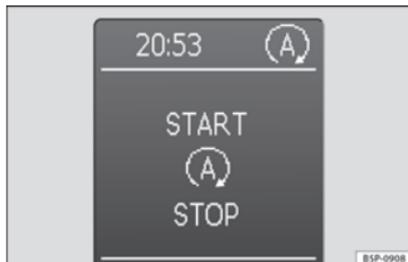
**Abb. 133** Anzeige am Display des Kombiinstrumentes während des Start-Stopp-Betriebs
