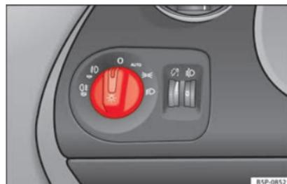
Abb. 58 Ausschnitt aus der Instrumententafel: Schalter für Licht, Nebelscheinwerfer und Nebelschlussleuchte
