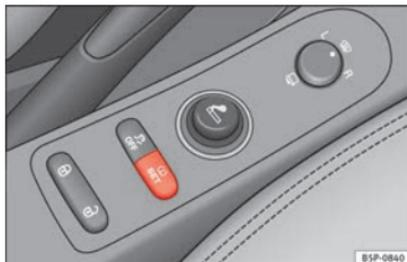
**Abb. 32** Mittelkonsole: Taste für die Reifenkontrollanzeige
