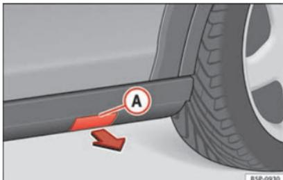
**Abb. 160** Kunststoff-Trittleiste mit Deckel zur Aufnahme des Wagenhebers.
