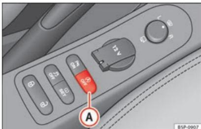
**Abb. 132** Ansicht des Tasters für den Start-Stopp-Betrieb
