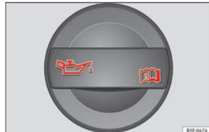
Abb. 148 Deckel der Motoröl-Einfüllöffnung im Motorraum
