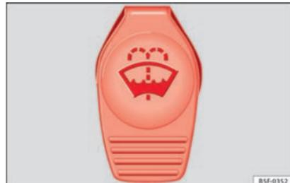
Abb. 150 Im Motorraum: Deckel des Scheibenwaschwasserbehälters
