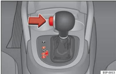
Abb. 127 Mittelkonsole: Wählhebel des Automatikgetriebes
