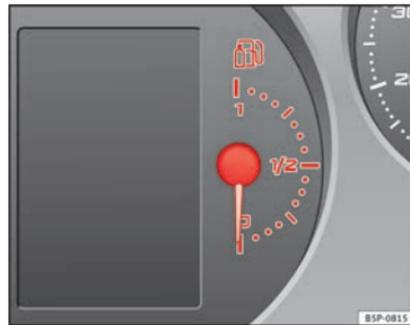
Abb. 28 Kombiinstrument, Gasvorratsanzeige
