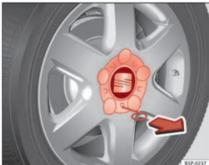
**Abb. 155** Radwechsel: Radzierkappe abziehen.
