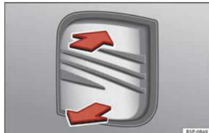
Abb. 53 Heckklappe: Öffnen von außen
