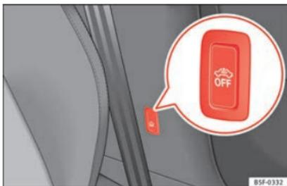
Abb. 52 Taste für Innenraumüberwachung
