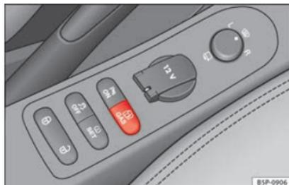
**Abb. 121** Mittelkonsole: Kontrollschalter für Autogasanlage.
