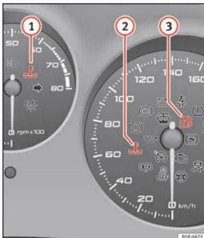
**Abb. 31** Kombiinstrument mit Warn- und Kontrollleuchten bei Fahrzeugen mit Autogasanlage.
