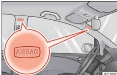
Abb. 17 Lage der Kopfairbags auf der linken Fahrzeugseite.
