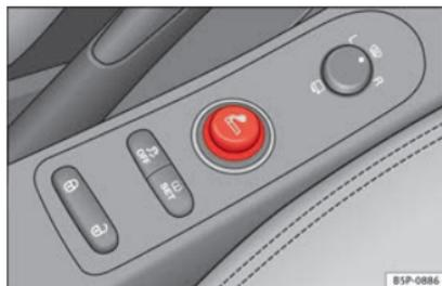
Abb. 96 Der Zigarettenanzünder befindet sich in der Steckdose der vorderen Mittelkonsole.
