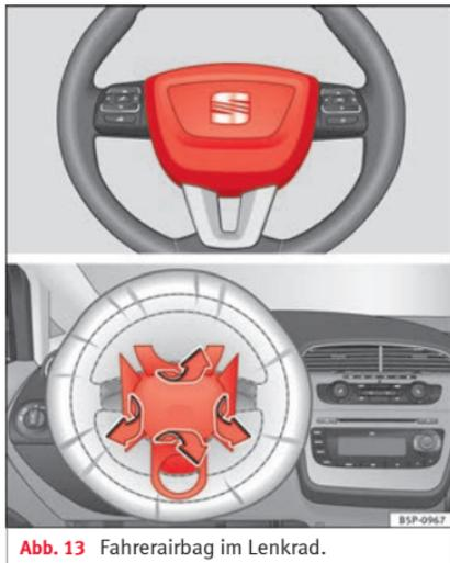
Abb. 13 Fahrerairbag im Lenkrad.
