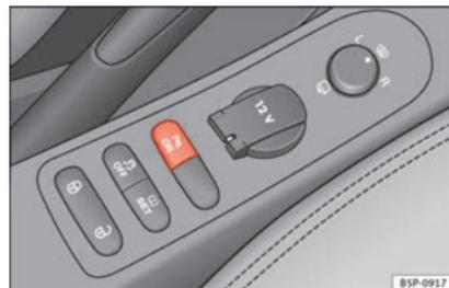
**Abb. 134** Mittelkonsole: Schalter für Einparkhilfe
