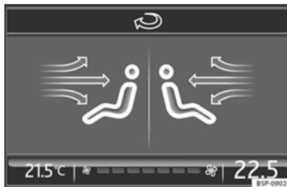
**Abb. 118** Display des Navigationssystems mit Informationen der Climatronic
