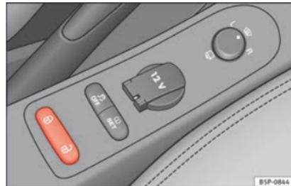
**Abb. 47** Ausschnitt der Mittelkonsole: Zentralverriegelungstaster.
