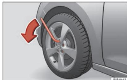
**Abb. 157** Radwechsel: Radschrauben lockern
