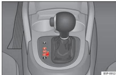
**Abb. 126** Mittelkonsole: Wählhebel des Automatikgetriebes
