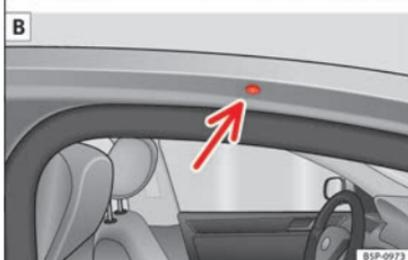
**Abb. 112** Modell Altea: Befestigungspunkte für den Dachgepäckträger.
