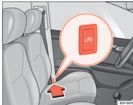
Fig. 67 Tasto di disattivazione dell'antifurto volumetrico
