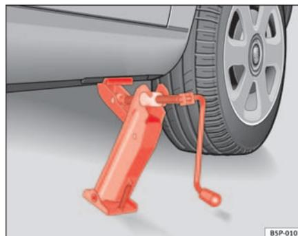
Fig. 168 Posizionamento del cric
