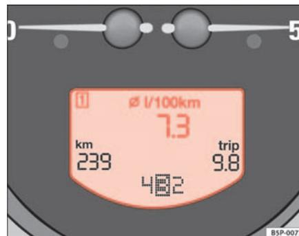
Fig. 40 Display digitale del quadro strumenti: l'indicatore del consumo medio di carburante
