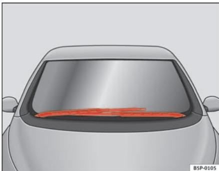
Fig. 158 Tergicristallo in posizione di manutenzione
