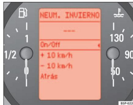
Fig. 46 Display digitale del quadro strumenti: l'indicatore pneumatici invernali
