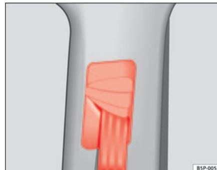
Fig. 17 Dispositivo di regolazione dell'altezza della cintura
