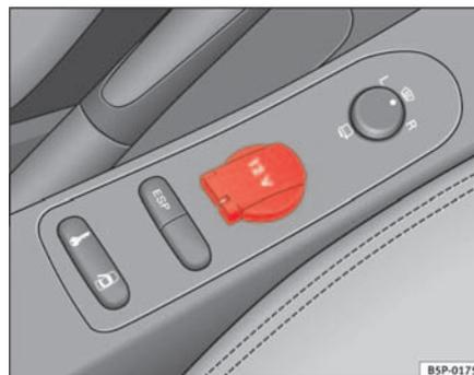
Fig. 116 Presa di corrente console centrale anteriore
