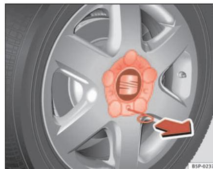
**Fig. 165** Cambio di una ruota: rimuovere il coprismozzo della ruota
