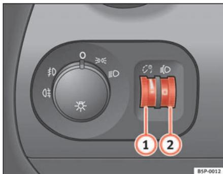
Fig. 77 Plancia portastrumenti: regolatore dell'intensità di illuminazione degli strumenti e degli interruttori e regolatore assetto fari
