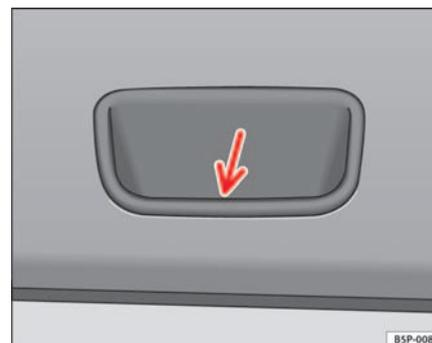
**Fig. 69** Dettaglio del rivestimento interno del portellone posteriore: maniglia di presa ad incavo
