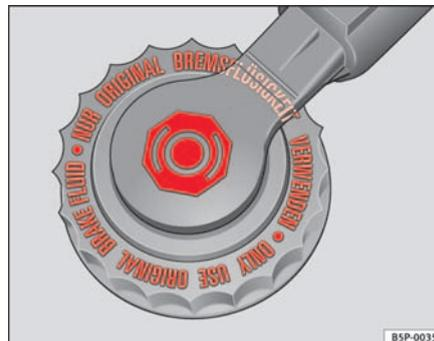
**Fig. 161** Vano motore: tappo del serbatoio del liquido dei freni
