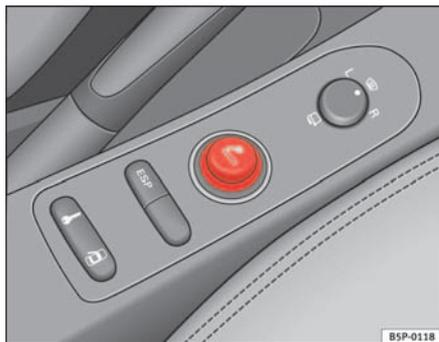
Fig. 115 Accendisigari all'interno della presa di corrente della console centrale anteriore
