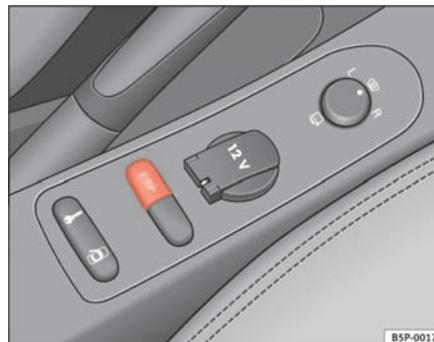
**Fig. 130** Dettaglio della console centrale: il tasto dell'ESP
