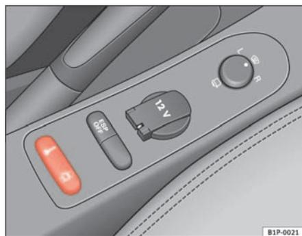
Fig. 60 Particolare della console centrale: interruttore della chiusura centralizzata
