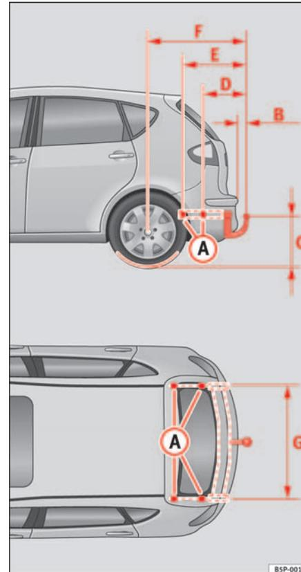
Fig. 149 Points de fixation du dispositif d'attelage
