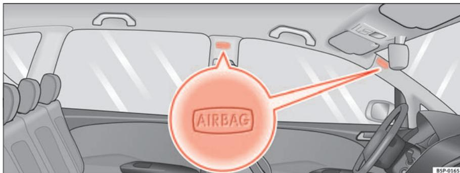
**Fig. 24** Emplacement de montage des airbags de tête du côté gauche du véhicule
