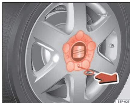
**Fig. 165** Changement d'une roue : Retirer l'enjoliveur de roue
