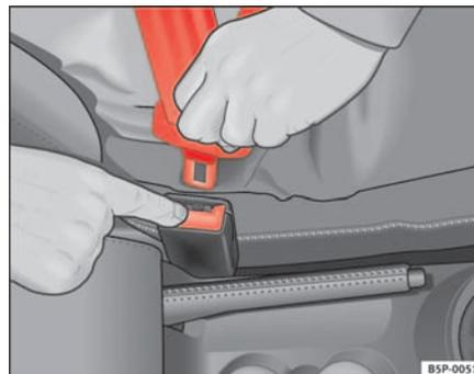
Fig. 16 Libération du pêne du boîtier de verrouillage
