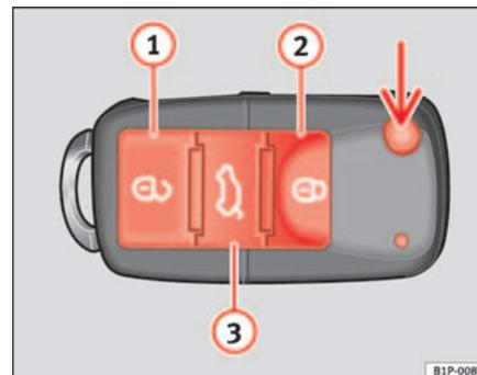
Fig. 66 Témoin de la pile dans la clé à radiocommande
