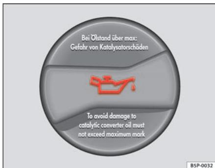
**Fig. 155** Dans le compartiment-moteur : bouchon de l'orifice de remplissage d'huile-moteur
