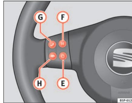
Fig. 56 Commandes au volant Audio + Téléphone
