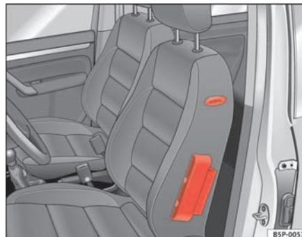
**Fig. 22** Airbag latéral dans le siège du conducteur : schéma de principe
