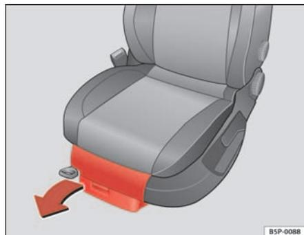
**Fig. 103** Rangements sous les sièges avant
