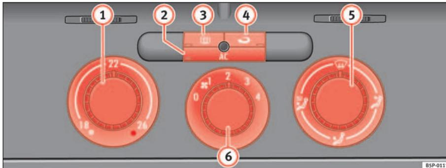
Fig. 125 Sur le tableau de bord : éléments de commande du Climatic
