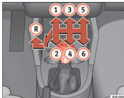
Fig. 133 Détail de la console centrale : grille des vitesses de la boîte mécanique à 6 vitesses ▶
