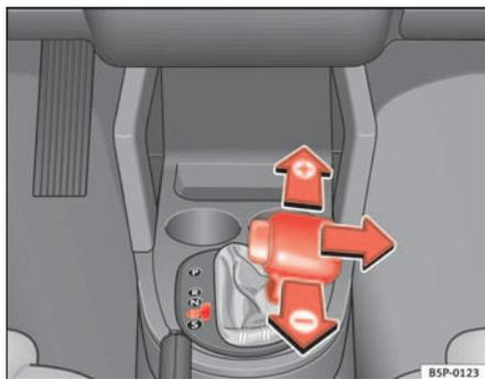
Fig. 138 Changement de vitesses avec la commande tiptronic
