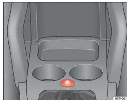
Fig. 78 Tableau de bord : touche d'activation du signal de détresse.
