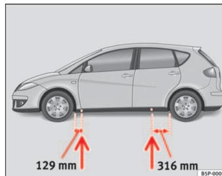
**Fig. 167** Points d'appui du cric.
