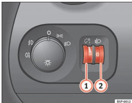
Fig. 77 Tableau de bord : Régulateurs d'éclairage des instruments et des commandes et du site des projecteurs
