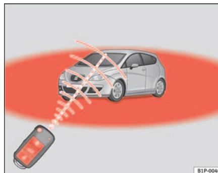
Fig. 65 Périmètre d'action de la radiocommande
