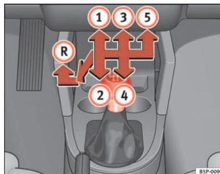
Fig. 132 Détail de la console centrale : grille des vitesses de la boîte mécanique à 5 vitesses
