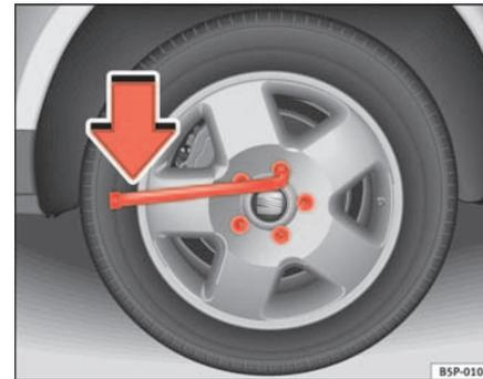
Fig. 166 Changement d'une roue : desserrer les boulons de roue
