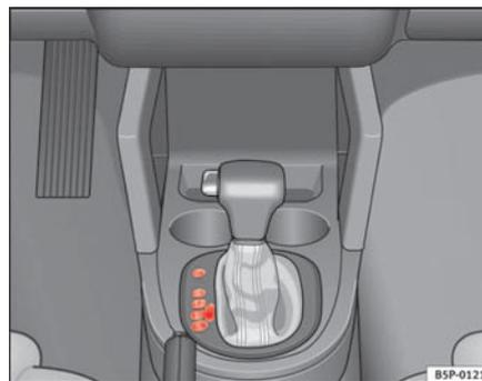
Fig. 134 Boîte de vitesses automatique : positions des vitesses
