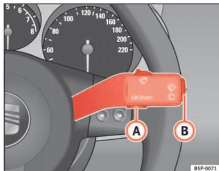
Fig. 41 Levier d'essuie-glace et de lave-glace : commande A et commande à bascule B
