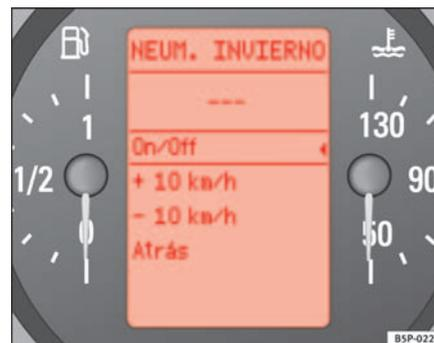
Fig. 46 Afficheur numérique du combiné d'instruments : indicateur de pneus d'hiver
