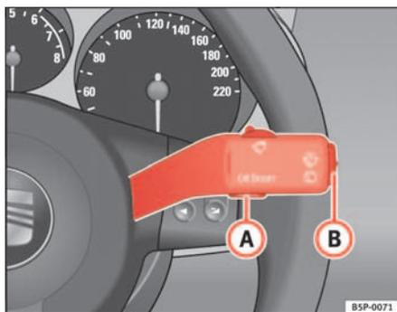
Fig. 43 Levier d'essuie-glace/ de lave-glace : la touche A sert à confirmer les options du menu et la commande à bascule B permet de changer de menu
