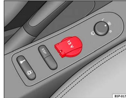
Fig. 116 Toma de corriente consola central delantera
