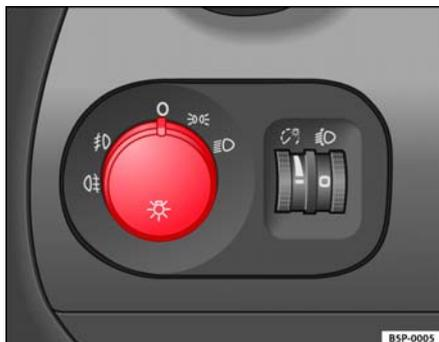
Fig. 75 Detalle del tablero de instrumentos: mando de las luces, faros antiniebla y luz trasera antiniebla
