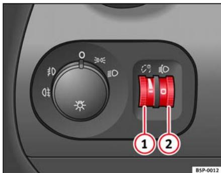
Fig. 77 Tablero de instrumentos: reguladores de la iluminación de instrumentos y mandos y del alcance de los faros
