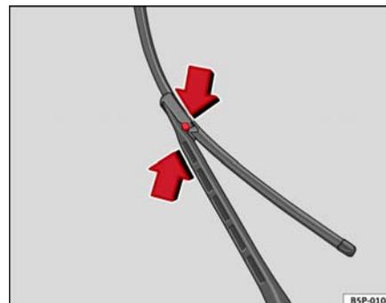
Fig. 159 Cambio de las escobillas del limpiaparabrisas
