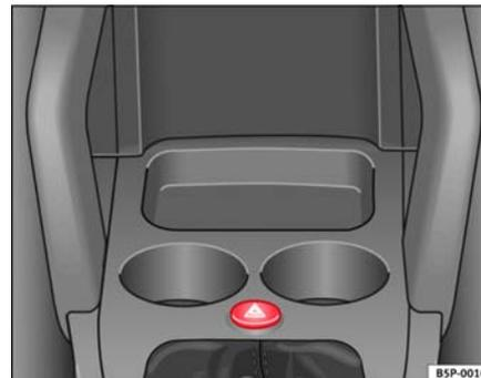
Fig. 78 Tablero de instrumentos: conmutador de los intermitentes de emergencia
