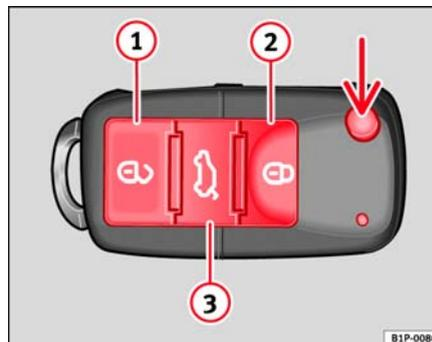
Fig. 66 Testigo de la pila de la llave con mando a distancia
