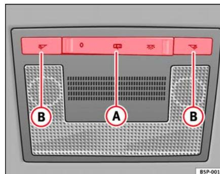
**Fig. 83** Revestimiento interior del techo: luces delanteras de lectura tipo 2
