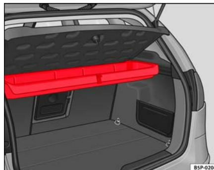
**Fig. 118 Alojamiento para el triángulo de preseñalización bajo la bandeja posterior**
