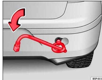
Fig. 195 Atornillado de la argolla de remolque en la parte trasera del vehículo
