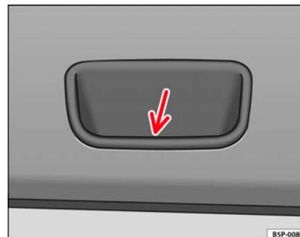
Fig. 69 Detalle del guardanido interior del portón trasero: cavidad para tirar
