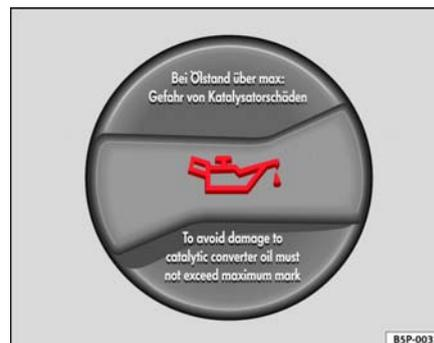
**Fig. 155** Tapón de la boca de llenado de aceite del motor en el vano motor
