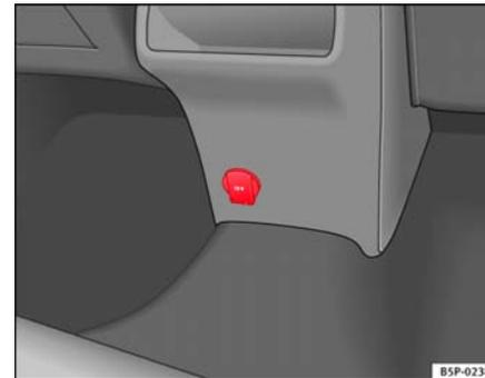
Fig. 117 Toma de corriente consola central trasera
