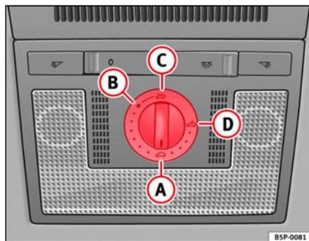
Fig. 73 Detalle del revestimiento interior del techo: mando giratorio del techo corredizo/ deflector
