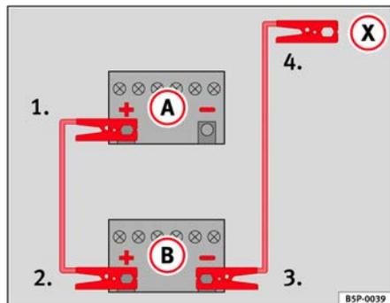
Fig. 193 Esquema de conexión de los cables de emergencia
