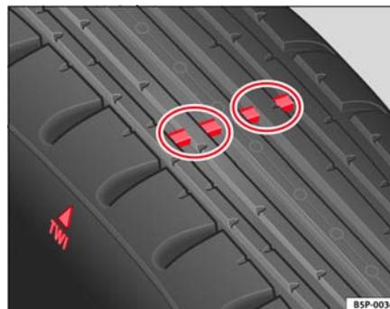
Fig. 162 Indicadores de desgaste del perfil del neumático
