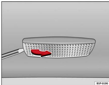
Fig. 191 Desmontaje luz del parasol
