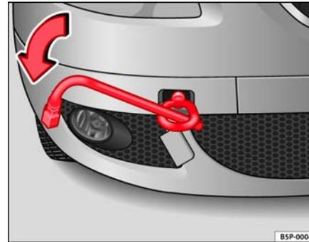
Fig. 194 Atornillado de la argolla de remolque en la parte delantera derecha del vehículo
