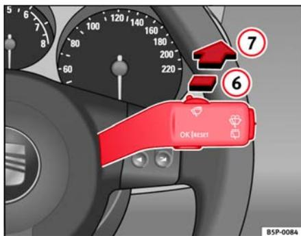
Fig. 89 Palanca del limpia-lavacristales: limpialuneta
