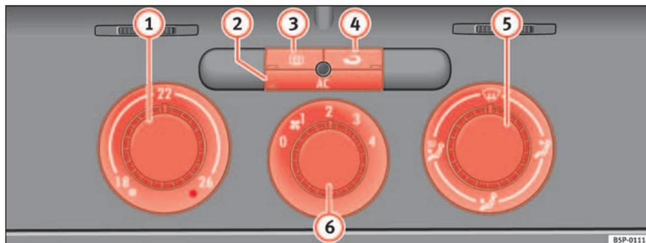
Fig. 124 Sur le tableau de bord : éléments de commande du Climatic
