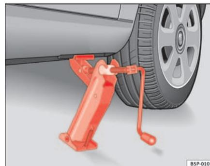
Fig. 168 Mise en place du cric
