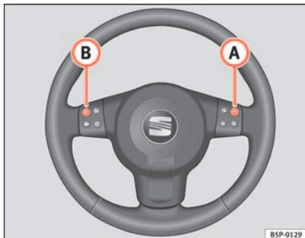
Fig. 57 Commandes au volant version Audio + Téléphone
