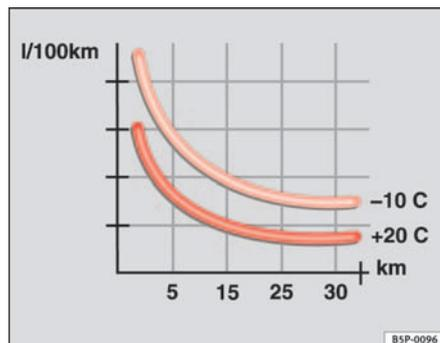
Fig. 148 Consommation de carburant (l/100 km) à deux températures ambiantes différentes.
