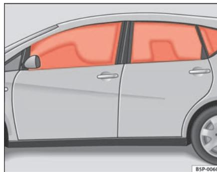
**Fig. 25 Schéma de principe : airbags de tête gonflés**
