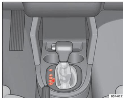
Fig. 133 Détail de la console centrale : levier sélecteur de la boîte automatique ou de la boîte DSG
