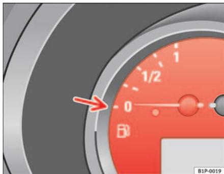
Fig. 34 Détail du combiné d'instruments : indicateur de niveau de carburant
