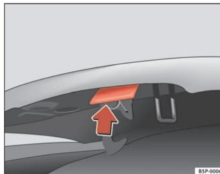
**Fig. 152** Gâchette d'ouverture du capot-moteur.
