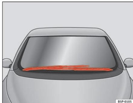
**Fig. 158** Essuie-glace en position de maintenance
