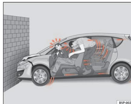
**Fig. 8** Schéma de principe : le véhicule transportant des occupants non sanglés heurte le mur.
