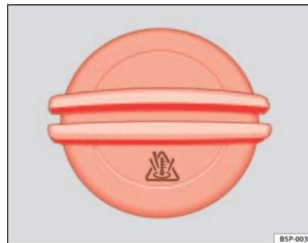
**Fig. 156** Dans le compartiment-moteur : bouchon du vase d'expansion du liquide de refroidissement
