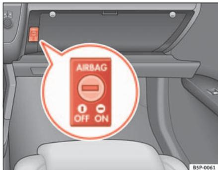
Fig. 26 Dans le vide-poches : commande à clé pour commuter et désactiver les sacs gonflables côté passager avant
