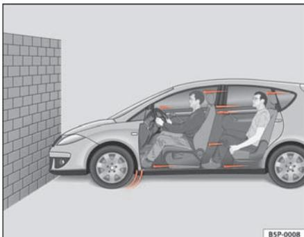
**Fig. 7** Schéma de principe : véhicule se dirigeant droit sur un mur avec des occupants non sanglés
