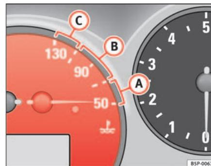
Fig. 35 Détail du combiné d'instruments : indicateur de température de liquide de refroidissement
