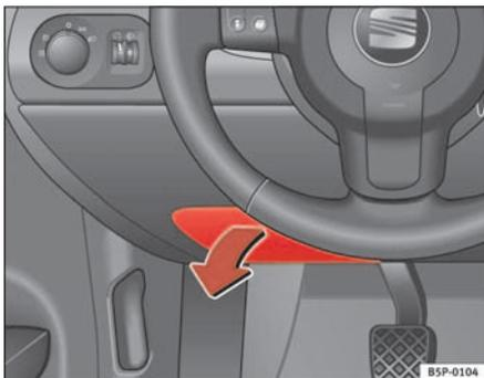
Fig. 171 A gauche dans le tableau de bord : cache de la boîte à fusibles
