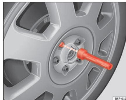
**Fig. 169** Changement de roue : Outil à six pans creux pour tourner les boulons
