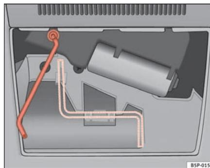
Fig. 73 Manivelle de fermeture d'urgence
