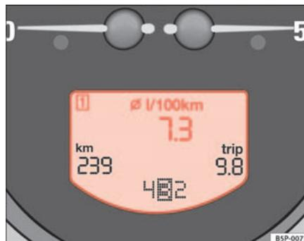
Fig. 42 Afficheur numérique du combiné d'instruments : indicateur consommation moyen de carburant.
