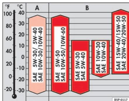
Fig. 153 Types d'huile en fonction de la température
