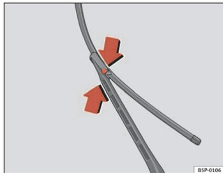
**Fig. 159** Remplacement des balais d'essuie-glace avant
