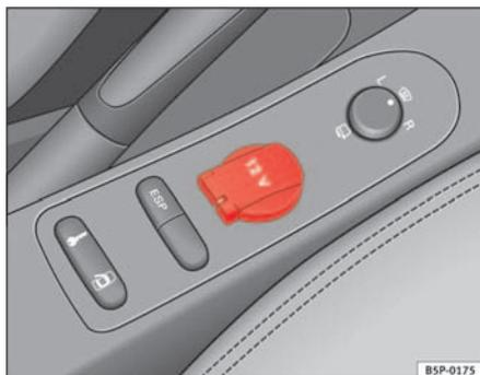
Fig. 115 Prise de courant de la console centrale avant
