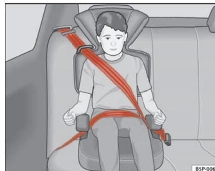
**Fig. 30** Siège pour enfants monté dans le sens de la marche sur la banquette arrière. ▶
