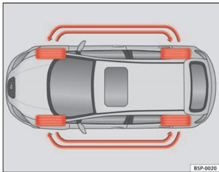
**Fig. 163** Schéma de permutation des roues
