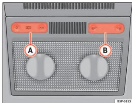
Fig. 79 Détail du ciel de pavillon : plafonnier avant
