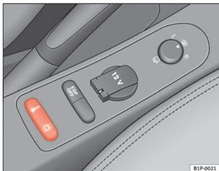
Fig. 60 Détail de la porte du conducteur : touche de verrouillage centralisé
