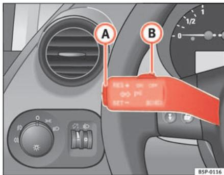
Fig. 143 Levier des clignotants et de l'inverseur-codes : commandes du régulateur de vitesse
