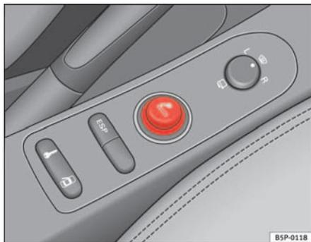
Fig. 114 Allume-cigare branché dans la prise de courant de la console centrale avant
