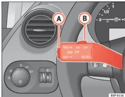
Fig. 142 Levier des clignotants et de l'inverseur-codes : commandes du régulateur de vitesse
