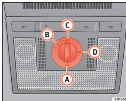
Fig. 72 Détail du ciel de pavillon : commande rotative du toit ouvrant coulissant/relevable
