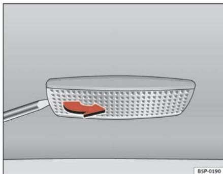
Fig. 191 Démontage de l'éclairage du pare-soleil
