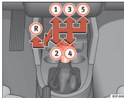
Fig. 131 Détail de la console centrale : grille des vitesses de la boîte mécanique à 5 vitesses
