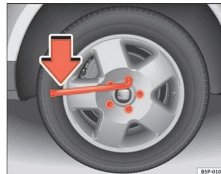
Fig. 166 Changement d'une roue : desserrage des boulons de roue
