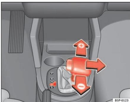
Fig. 137 Changement de vitesses avec la commande tiptronic
