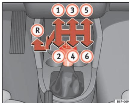
Fig. 132 Détail de la console centrale : grille des vitesses de la boîte mécanique à 6 vitesses
