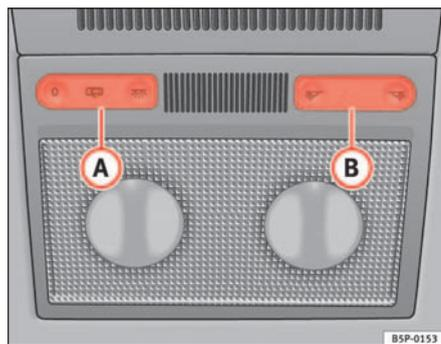
Fig. 81 Détail du ciel de pavillon : lampes de lecture avant type 1
