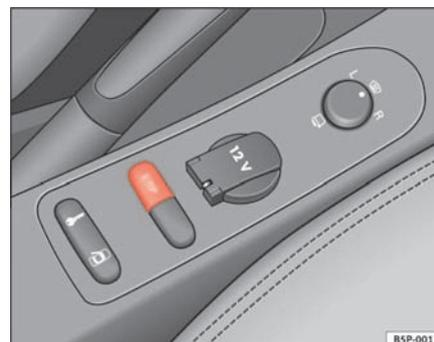
**Fig. 129** Détail de la console centrale : touche ESP
