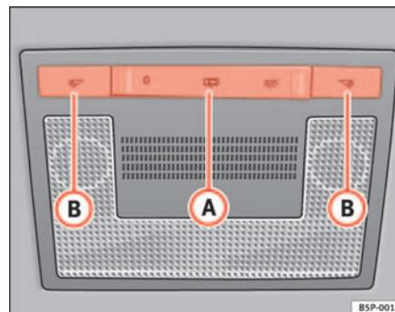
Fig. 80 Détail du ciel de pavillon : plafonnier avant
