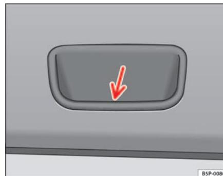
Fig. 68 Détail du revêtement intérieur du hayon : poignée concave pour la fermeture
