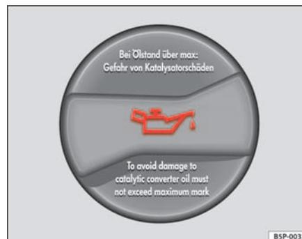
**Fig. 155** Tapón de la boca de llenado de aceite del motor en el vano motor
