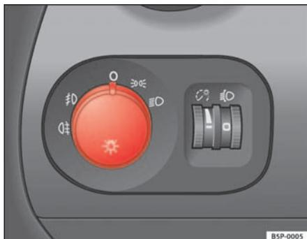
Fig. 74 Detalle del tablero de instrumentos: mando de las luces, faros antiniebla y luz trasera antiniebla
