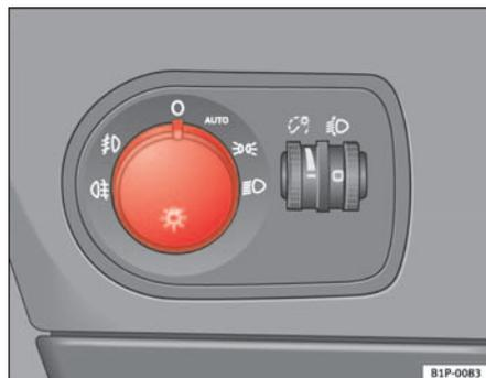
Fig. 75 Encendido automático de luces
