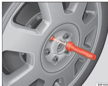
**Fig. 169 Cambio de rueda: Útil de hexágono interior para girar los tornillos**
