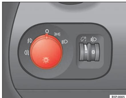
Abb. 74 Ausschnitt aus der Instrumententafel: Schalter für Licht, Nebelscheinwerfer und Nebelschlussleuchte
