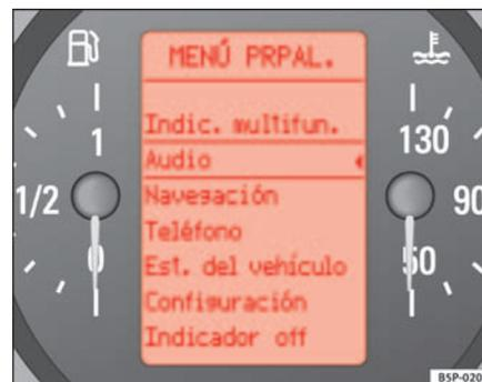
Abb. 44 Display im Kombiinstrument: Hauptmenü
