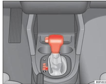
**Abb. 135 Wählhebelsperre lösen**
