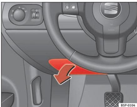
**Abb. 171** Links in der Instrumententafel: Abdeckung des Sicherungskastens
