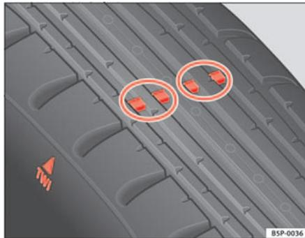
Abb. 162 Prinzipdarstellung Reifenprofil: Verschleißanzeiger
