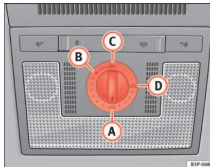
Abb. 72 Ausschnitt aus dem Dachhimmel: Drehschalter Schiebe-/Ausstelldach
