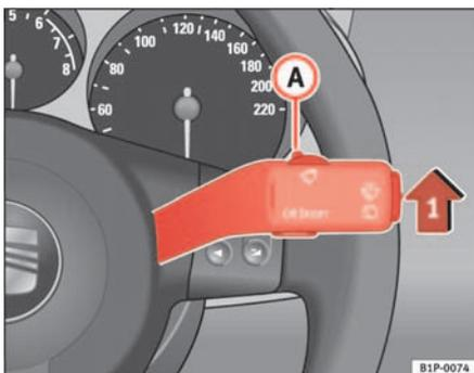
Abb. 87 Scheibenwischerhebel
