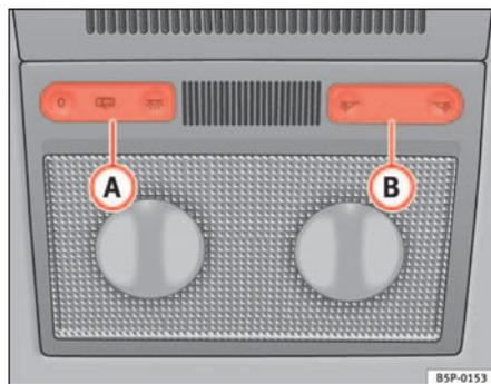
**Abb. 81** Ausschnitt aus Dachhimmel: Innenleuchten vorne Typ 1
