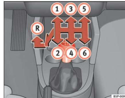
Abb. 132 Ausschnitt aus der Mittelkonsole: Schalt-schema vom 6-Gang-Schaltgetriebe
