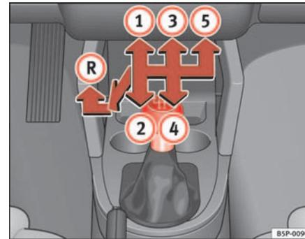
Abb. 131 Ausschnitt aus der Mittelkonsole: Schalt-schema vom 5-Gang-Schaltgetriebe
