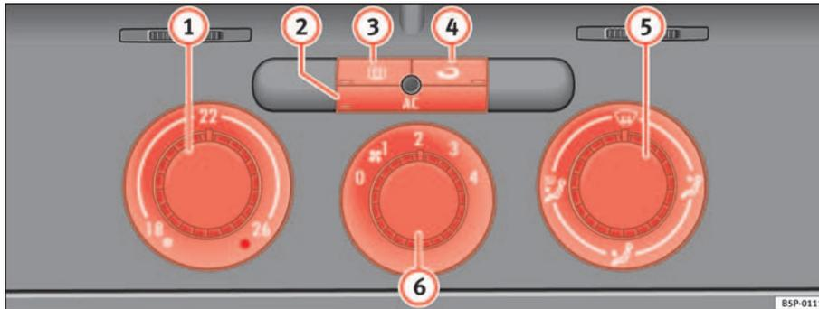
Abb. 124 In der Instrumententafel: Bedienelemente der Climatic
