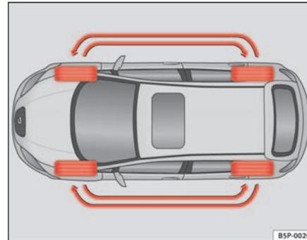
Abb. 163 Schema für das Tauschen der Räder
