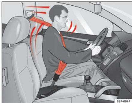
**Fig. 11 Condutor com o cinto de segurança correctamente colocado: está preso pelo mesmo numa travagem brusca**
