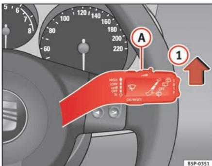
Fig. 87 Alavanca do limpa-vidros
