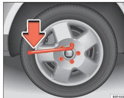
**Fig. 175** Substituição de uma roda: desapertar os parafusos da roda
