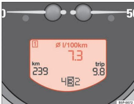
Fig. 42 Visor digital no painel de instrumentos: indicador do consumo médio de combustível.
