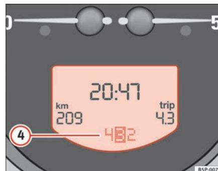
Fig. 37 Pormenor do painel de instrumentos: visor com indicação da mudança no Tiptronic
