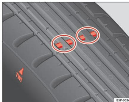
Fig. 171 Perfil do pneu: indicador de desgaste
