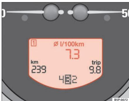
Fig. 40 Visor digital no painel de instrumentos: indicador do consumo médio de combustível
