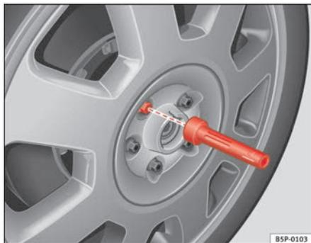
**Fig. 178** Substituição de uma roda: sextavado interior para desapertar e apertar os parafusos
