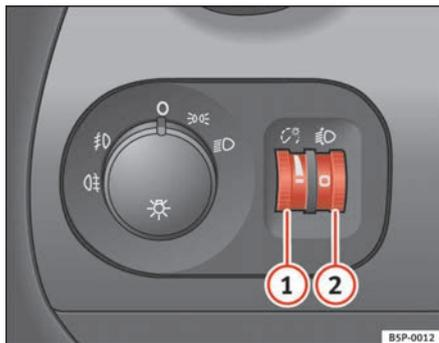
Fig. 75 No painel de bordo: reguladores da iluminação dos instrumentos, dos comandos e do alcance dos faróis
