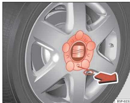
**Fig. 174** Substituição de uma roda: retirar os tampões dos cubos
