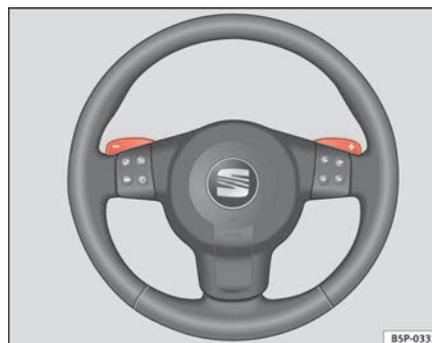
**Fig. 143** Volante com alavancas para caixa de velocidades automática ▶
