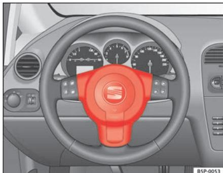
**Fig. 18** Airbag do condutor no volante
