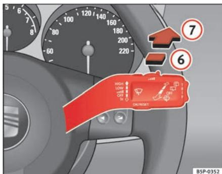
Fig. 88 Alavanca do limpa/lava-vidros: limpa-vidro traseiro
