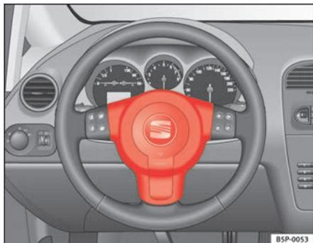
**Fig. 18** Airbag del conducente all'interno del volante
