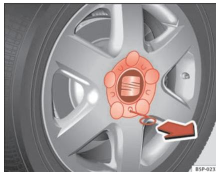
**Fig. 174** Cambio di una ruota: rimuovere il coprimozzo della ruota
