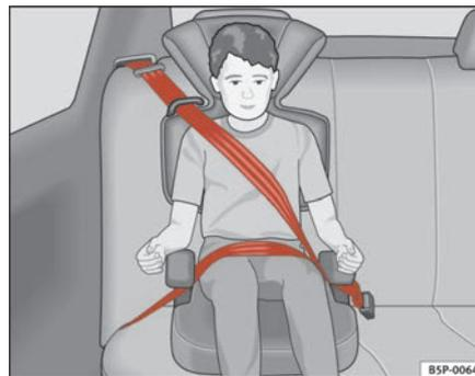
**Fig. 30** Seggiolino rivolto nel senso di marcia, montato sul sedile posteriore
