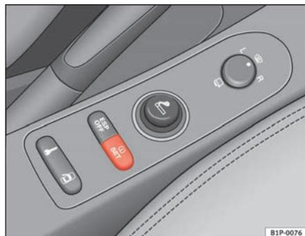
Fig. 48 Console centrale: tasto del sistema controllo dei pneumatici
