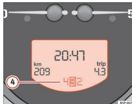
Fig. 37 Dettaglio del quadro strumenti: display con indicatore di marcia del Tiptronic
