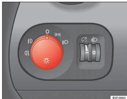
Fig. 73 Dettaglio della plancia portastrumenti: interruttore luci, fari fendinebbia e retronebbia
