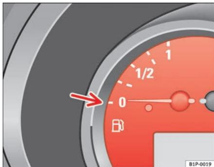
Fig. 34 Quadro strumenti: indicatore del livello del carburante
