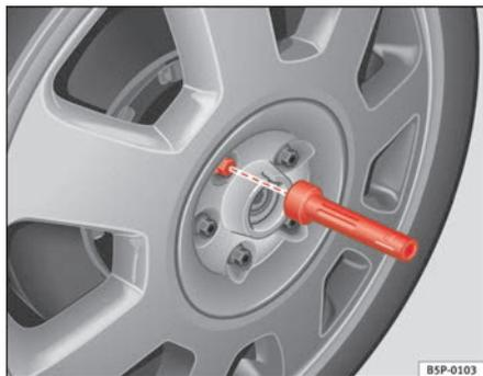
**Fig. 178** Cambio di una ruota: utensile ad esagono cavo per svitare le viti
