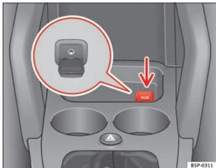
Fig. 118 Connettore per l'ingresso audio ausiliare
