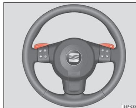
**Fig. 143** Volante con leve per il cambio automatico ▶
