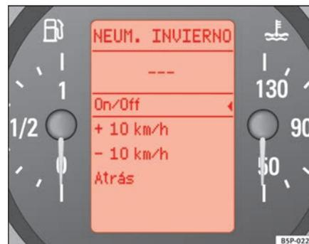
Fig. 46 Display digitale del quadro strumenti: indicatore pneumatici invernali
