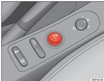
Fig. 116 Accendisigari all'interno della presa di corrente della console centrale anteriore
