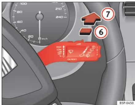
Fig. 87 Alavanca do limpa/lava-vidros: limpa-vidros traseiro
