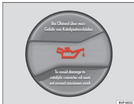
Fig. 158 Tampão do bocal de enchimento do óleo do motor no compartimento do motor
