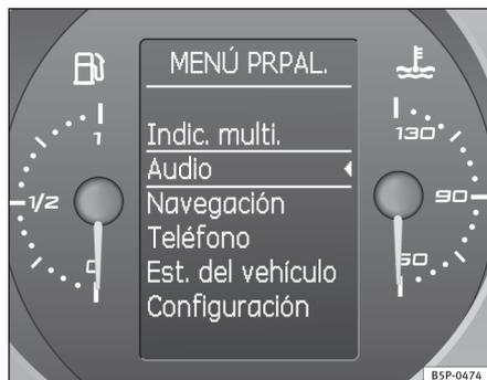
**Fig. 46** Visor digital no painel de instrumentos: Menu principal
