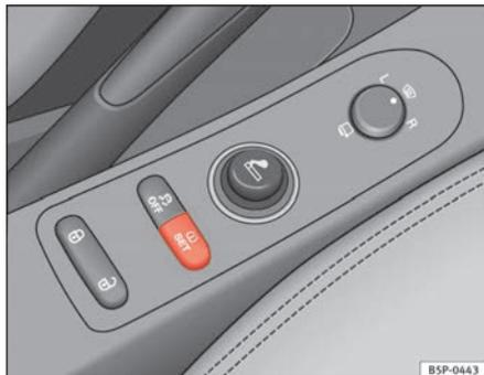
**Fig. 49** Consola central: tecla do sistema de controlo dos pneus
