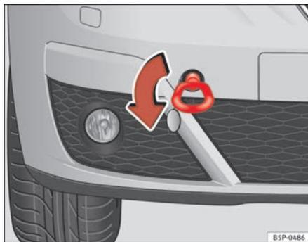
Fig. 198 Enroscar a argola de reboque na parte dianteira direita do veículo
