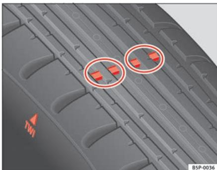
**Fig. 166** Indicadores de desgaste no perfil do pneu
