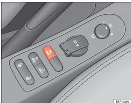
Fig. 146 Consola central: Interruptor para auxílio de estacionamento
