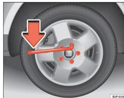
**Fig. 170** Substituição da roda: aliviar os parafusos da roda
