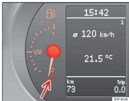
Fig. 34 Painel de instrumentos: indicador do nível do depósito de combustível
