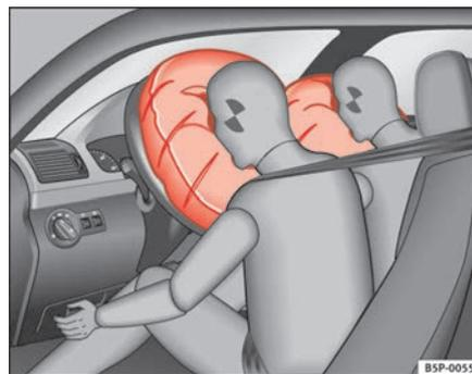
**Fig. 20** Airbags frontais insuflados
