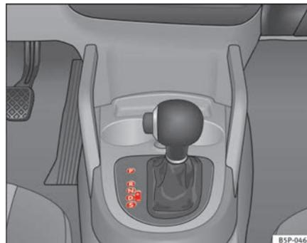
Fig. 139 Consola central: alavanca de selecção da caixa de velocidades automática / caixa de velocidades automática DSG
