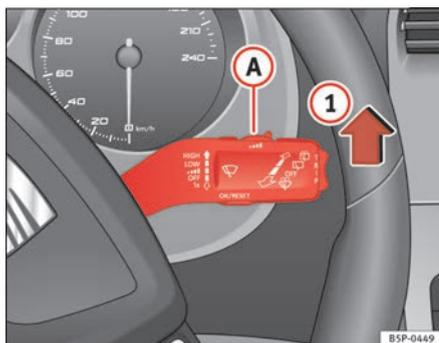
Fig. 86 Alavanca do limpador de pára-brisas
