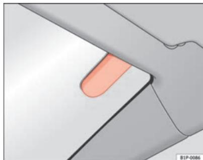
Fig. 86 Capteur de pluie\*
