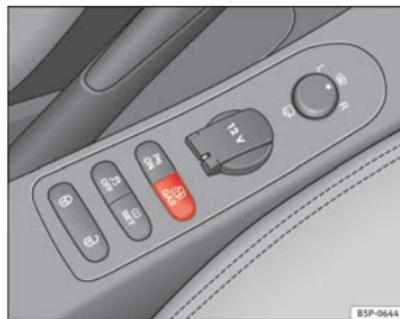
Fig. 137 Console centrale : contacteur de contrôle du système de gaz.
