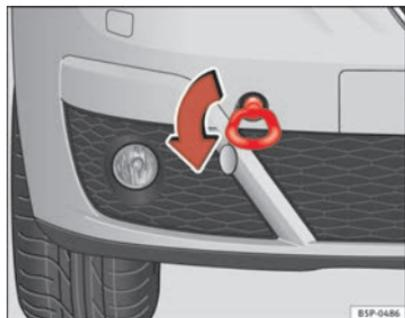
Fig. 205 Vissage de l'œillet de remorquage avant, côté droit
