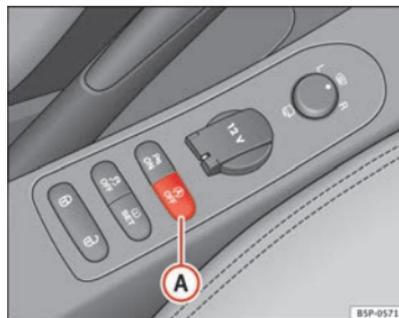
Fig. 138 Détail du bouton du fonctionnement Start-Stop.
