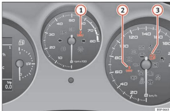
Fig. 51 Tableau de bord avec témoins d'alerte et de contrôle sur véhicules au GPL.
