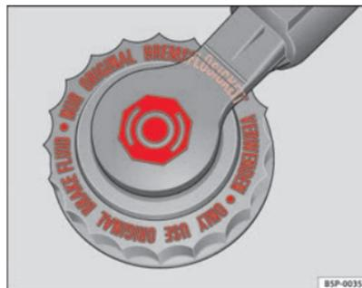
Fig. 171 Dans le compartiment-moteur : bouchon du réservoir de liquide de frein
