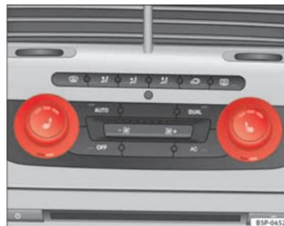
Fig. 96 Sièges avant chauffants avec Climatronic
