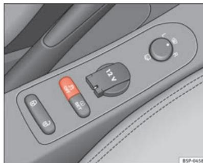
Fig. 135 Détail de la console centrale : touche ESP
