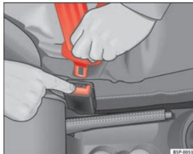
Fig. 16 Retrait du pêne du boîtier de verrouillage ▶
