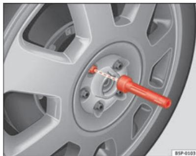
Fig. 179 Changement de roue : outil à six pans intérieur pour serrer/desserrer les vis
