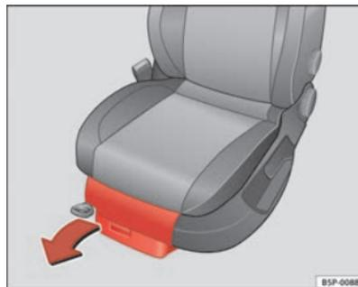
Fig. 103 Rangements sous les sièges avant
