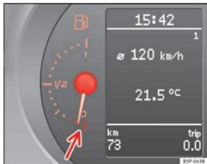
Fig. 35 Tableau de bord : indicateur de niveau du réservoir de carburant
