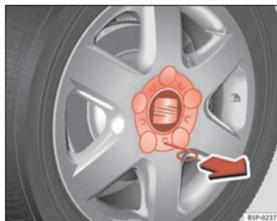
**Fig. 175** Changement de roue : Retirez l'enjoliveur de roue central.
