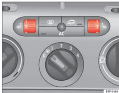
Fig. 95 Molettes des chauffages de sièges avant
