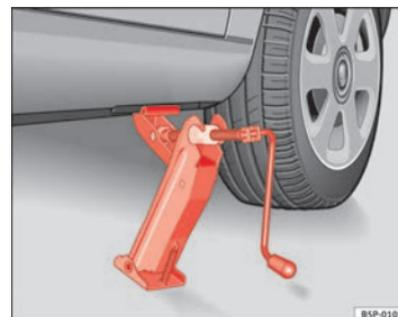
Fig. 178 Mise en place du cric
