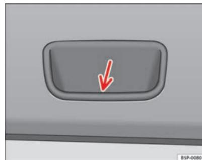
Fig. 67 Détail de la garniture intérieure du hayon arrière : cavité pour tirer
