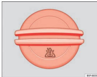
Fig. 165 Dans le compartiment-moteur : bouchon du vase d'expansion du liquide de refroidissement
