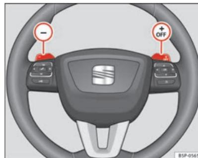
**Fig. 147** Volant avec leviers pour boîte de vitesses automatique
