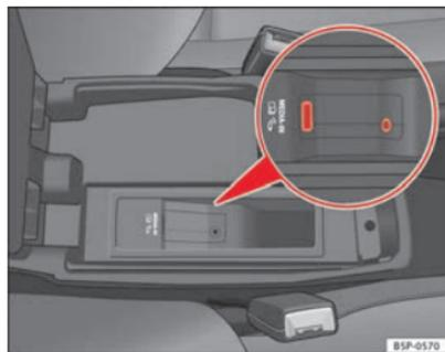
Fig. 121 Connexion dans l'accoudoir central
