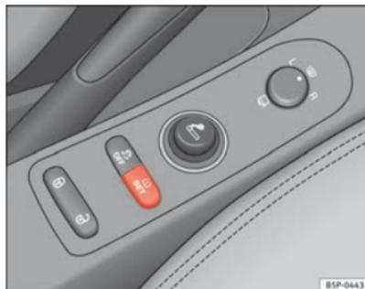
**Fig. 52** Console centrale : touche du système de contrôle des pneus
