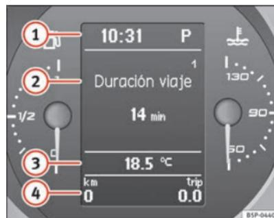
Fig. 39 Afficheur numérique du tableau de bord
