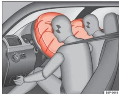
**Fig. 20 Schéma de principe : airbags frontaux gonflés**
