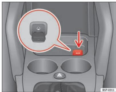
Fig. 119 Connecteur pour l'entrée auxiliaire audio
