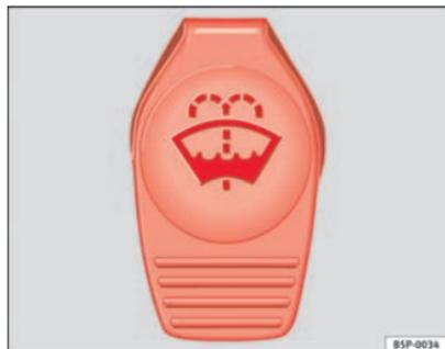
**Fig. 166** Dans le compartiment-moteur : bouchon du réservoir de lave-glace
