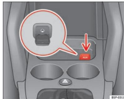
Abb. 119 Anschluss für einen zusätzlichen Audio-Eingang
