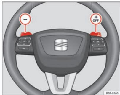
Abb. 147 Lenkrad mit Wippen für Automatikgetriebe
