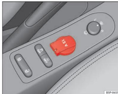
Abb. 118 Steckdose an der Mittelkonsole vorne ▶
