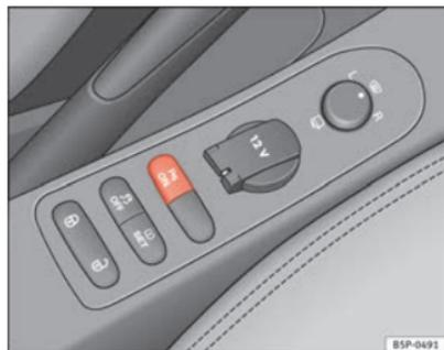
Abb. 149 Mittelkonsole: Schalter für Einparkhilfe
