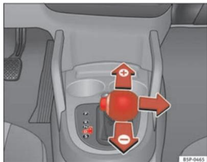
Abb. 146 Schalten mit Tiptronic
