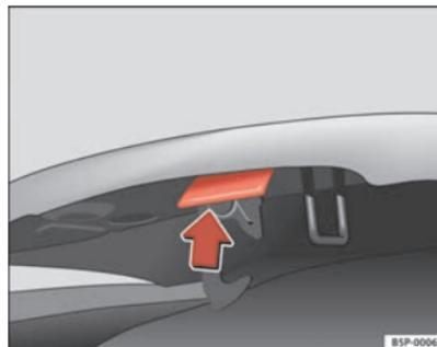
Abb. 162 Riegel der Motorraumklappe
