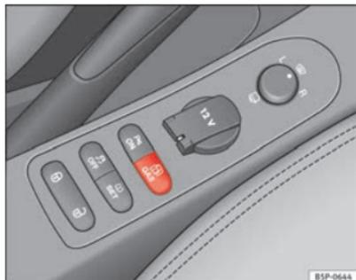
Abb. 137 Mittelkonsole: Kontrollschalter für Autogasanlage.
