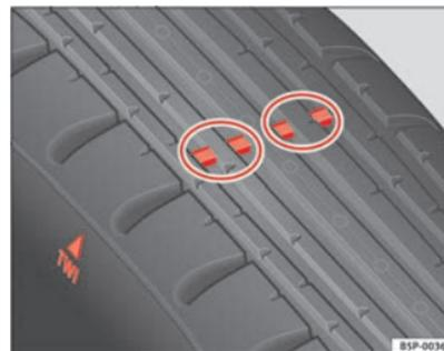
Abb. 172 Prinzipdarstellung Reifenprofil: Verschleißanzeiger
