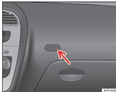
Abb. 27 Kontrollleuchte für Abschaltung der Beifahrerairbags
