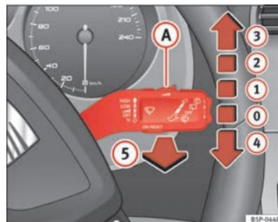
Abb. 85 Scheibenwischer- und Scheibenwascherhebel
