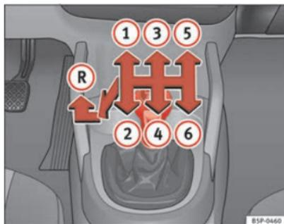
Abb. 141 Ansicht der Mittelkonsole: Schalt-schema eines 6-Gang-Schaltgetriebes
