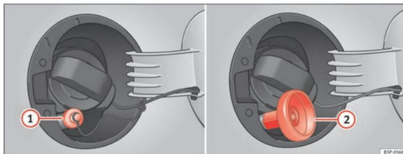
Abb. 158 Geöffnete Tankklappe mit Autogas-Einfillstutzen und Adapter.
