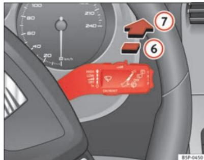
Abb. 88 Scheibenwischer- und Scheibenwaschhebel: Heckscheibenwischer
