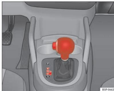
Abb. 144 Wählhebelsperre lösen
