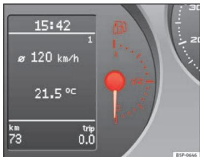
Abb. 37 Kombiinstrument: Gasvorratsanzeige
