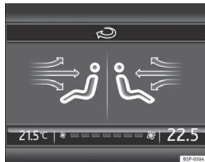
Abb. 130 Display des Navigationssystems mit Informationen der Climatronic
