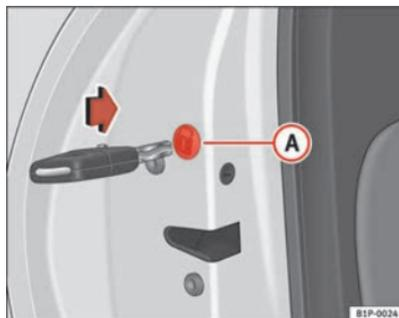
Abb. 60 Notverriegelung der Türen
