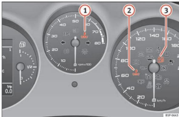
Abb. 51 Kombiinstrument mit Warn- und Kontrollleuchten bei Fahrzeugen mit Autogasanlage.
