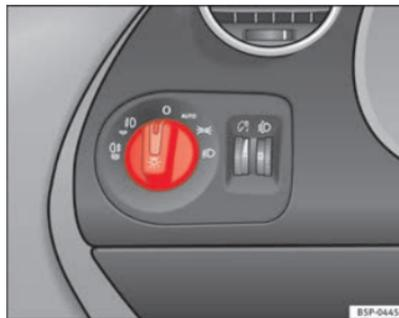
Abb. 74 Automatisches Fahrlicht
