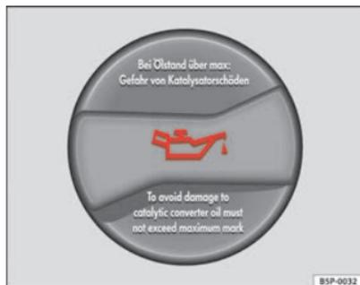
Abb. 164 Deckel der Motoröl-Einflüllöffnung im Motorraum
