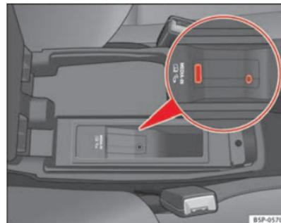
Abb. 121 Anschluss an der Mittelarmlehne
