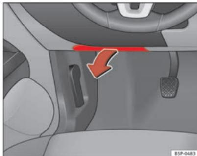
**Abb. 181** Links in der Instrumententafel: Abdeckung des Sicherungskastens
