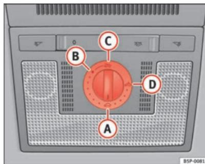
Abb. 71 Detailsicht des Dachhimmels: Drehschalter Schiebe-/Ausstelldach
