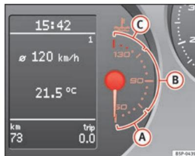
Abb. 36 Kombiinstrument: Motorkühlmitteltemperaturanzeige
