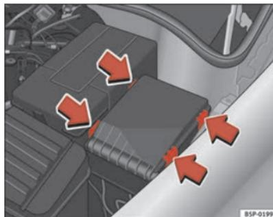
**Abb. 182** Sicherungsdeckel im Motorraum
