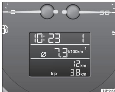
Abb. 44 Display im Kombiinstrument: Anzeige des durchschnittlichen Kraftstoffverbrauchs.
