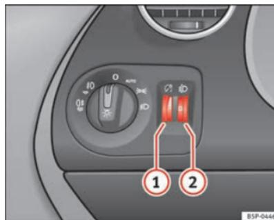
**Abb. 75** In der Instrumententafel: Regler für die Instrumenten-/Schalterbeleuchtung und Leuchtweitenregulierung
