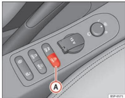
Abb. 138 Ansicht des Tasters für den Start-Stopp-Betrieb
