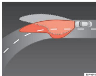
**Abb. 76** Beleuchtung der Kurve mit Kurvenfahrlicht
