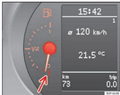
Abb. 35 Kombiinstrument: Kraftstoffvorratsanzeige
