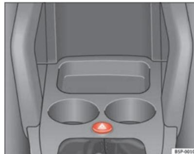
Abb. 77 In der Instrumententafel: Schalter für Warnblinkanlage
