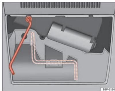
Abb. 72 Kurbel für Notverriegelung
