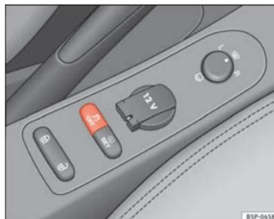
Abb. 135 Ansicht der Mittelkonsole: ESP-Taste
