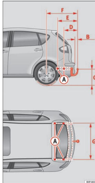
Abb. 156 Befestigungspunkte für die Anhangervorrichtung
