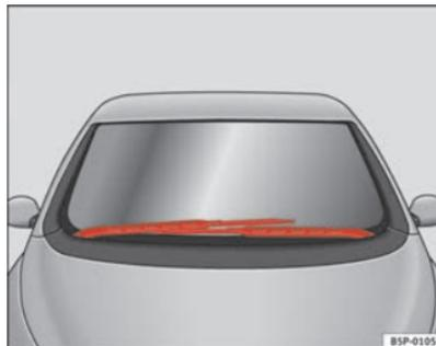
Abb. 167 Scheibenwischer in Service-Stellung
