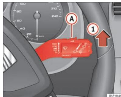
Abb. 87 Scheibenwischerhebel
