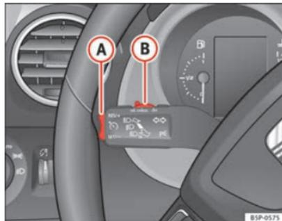
Fig. 153 Alavanca das luzes indicadoras de mudança de direcção e dos máximos: comando e botão basculante para o regulador de velocidade
