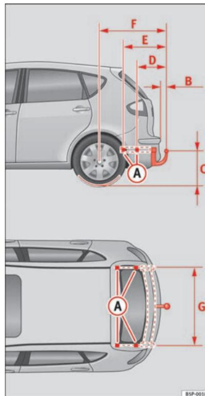
Fig. 156 Pontos de fixação do dispositivo de reboque
