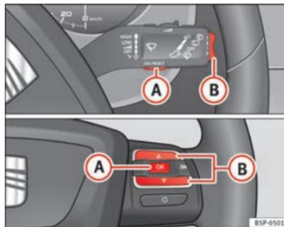
Fig. 43 Botões basculantes A e B. Comandos no volante.
