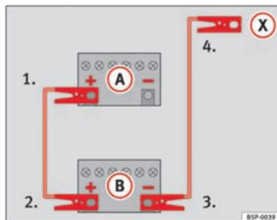
Fig. 202 Esquema para ligar os cabos de emergência no caso do veículo que fornece a corrente não dispor do sistema Start-Stop: bateria descarregada (A) e bateria que fornece a corrente (B).
