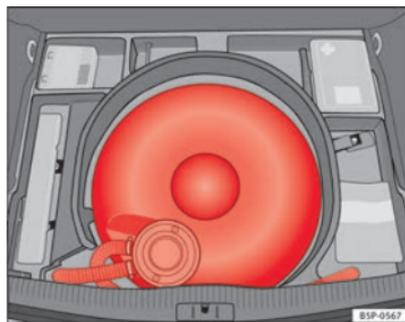
Fig. 159 Depósito de GPL na cavidade do pneu su-plente.
