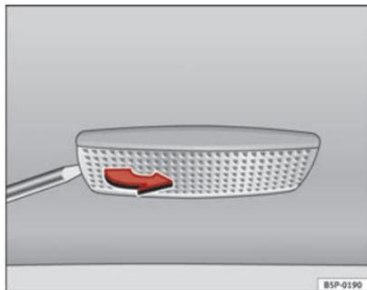
Fig. 200 Desmontagem da luz da pala de sol
