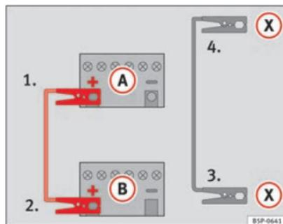
Fig. 203 Esquema para ligar os cabos de emergência no caso do veículo que fornece a corrente dispor do sistema Start-Stop: bateria descarregada (A) e bateria que fornece a corrente (B).
