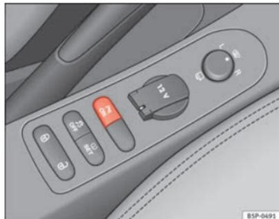
Fig. 149 Consola central: Interruptor de auxílio de estacionamento
