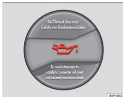
**Fig. 164 Tampa do bocal de enchimento do óleo do motor no compartimento do motor**
