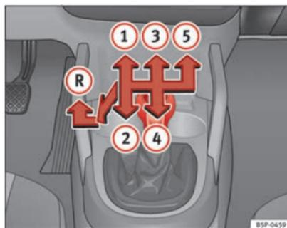
Fig. 140 Pormenor da consola central: esquema de uma caixa de velocidades manual de 5 velocidades
