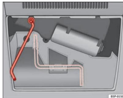
Fig. 72 Manivela de fecho de emergência
