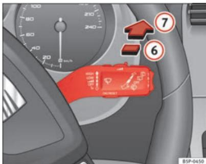
Fig. 88 Manípulo do limpa/lava-vidros: limpa-vidros traseiro
