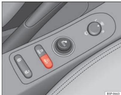
Fig. 52 Consola central: botão do sistema de controlo dos pneus
