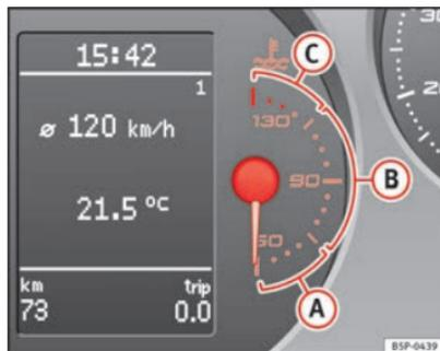
Fig. 36 Painel de instrumentos: indicador da temperatura do líquido de refrigeração do motor
