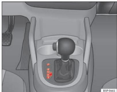
Fig. 142 Consola central: alavanca selectora da caixa de velocidades automática / caixa de velocidades automática DSG
