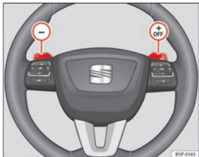
Fig. 147 Volante com pastilhas para a caixa de velocidades automática
