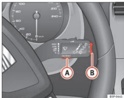
**Fig. 45** Manípulo do limpavidros: botão A para confirmar opções do menu e botão basculante B para mudar de menu
