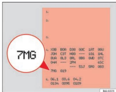
Fig. 155 Etiqueta de dados do veículo no reverso da capa do Programa de Manutenção
