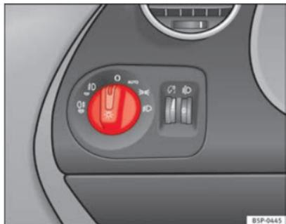
Fig. 73 Pormenor do painel de instrumentos: comando das luzes, faróis de nevoeiro e luz de nevoeiro traseira
