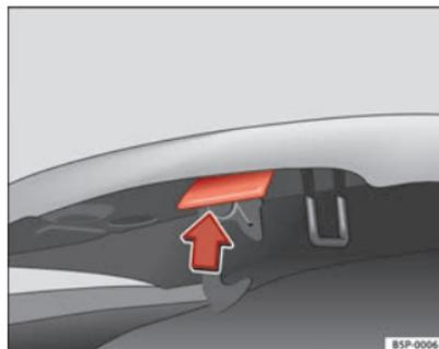
Fig. 162 Gancho de abertura do capot do motor.
