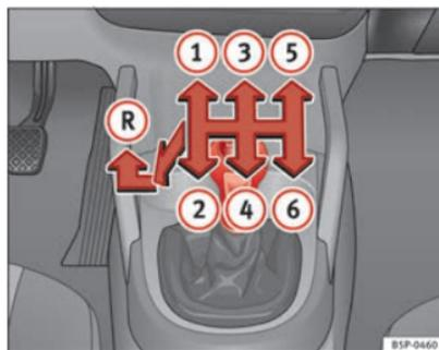
Fig. 141 Pormenor da consola central: esquema de uma caixa de velocidades manual de 6 velocidades
