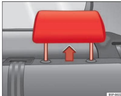
Fig. 5 Encostos de cabeça em posição de utilização
