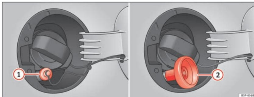
Fig. 158 Tampa do depósito aberta com bocal de enchimento de GPL e adaptador.
