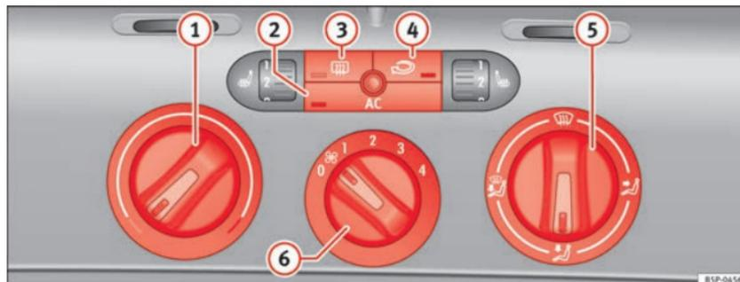
Fig. 128 Comandos do Climatic no painel de instrumentos
