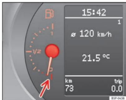
Fig. 35 Painel de instrumentos: indicador do nível do depósito de combustível
