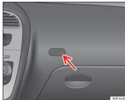
Fig. 27 Aviso de controlo da desactivação do airbag do passageiro
