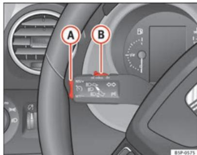
Fig. 154 Alavanca das luzes indicadoras de mudança de direcção e dos máximos: comando e botão basculante para o regulador de velocidade
