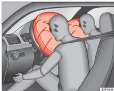
**Fig. 20 Airbags frontais insuflados**
