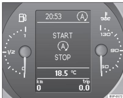
Fig. 139 Indicação no visor do painel de instrumentos durante o funcionamento Start-Stop.
