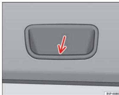
Fig. 67 Pormenor do revestimento interior da porta do porta-bagagens: reentrância para puxar
