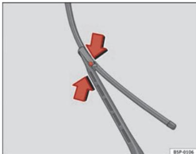
Fig. 168 Substituição das escovas do limpa pára-brisas
