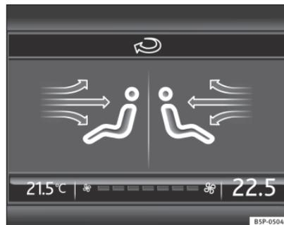
Fig. 130 Visor do navegador com informação do Climatronic
