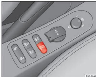
Fig. 137 Consola central: comutador de controlo do sistema de gás.
