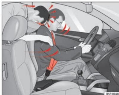
**Fig. 10 O passageiro do banco traseiro que não tiver colocado o cinto de segurança é projectado em frente, para cima do condutor que tem o cinto colocado.**
