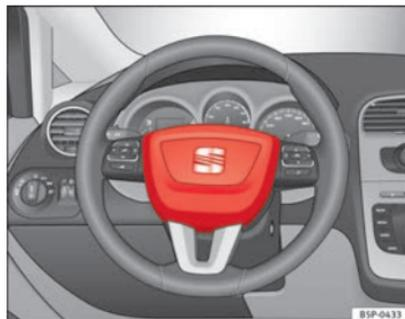
**Fig. 18** Airbag do condutor no volante
