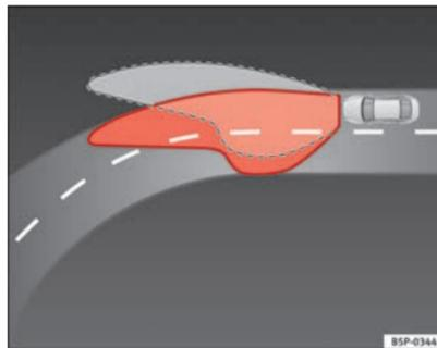
Fig. 76 Iluminação da curva com faróis autodireccionáveis
