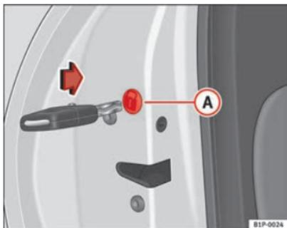
Fig. 60 Fecho de emergência das portas
