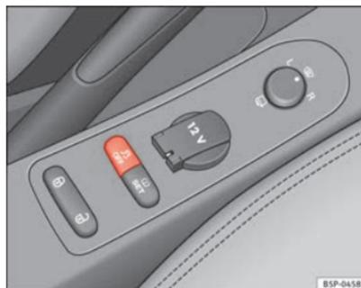
**Fig. 135 Pormenor da consola central: tecla ESC (ESP)**
