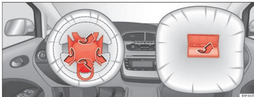
Fig. 21 Tampas dos airbags ao dispararem os airbags frontais
