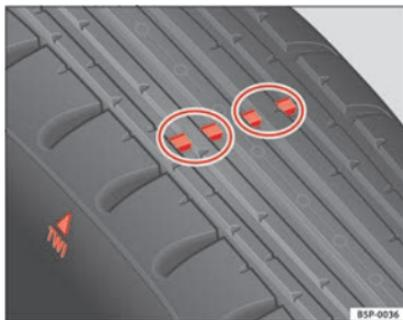
**Fig. 172** Indicadores de desgaste no perfil do pneu
