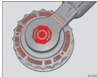
Fig. 171 Tampão do reservatório do líquido dos travões no compartimento do motor
