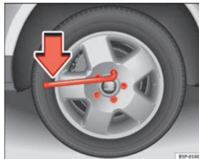
Fig. 176 Substituição de pneu: desapertar os parafusos da roda
