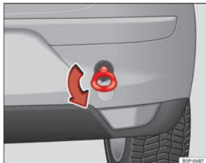
Fig. 205 Aparafusar a argola de reboque na parte traseira do veículo
