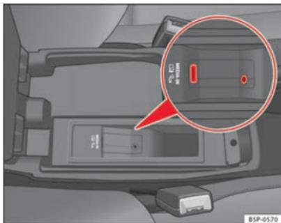
Fig. 121 Ligação no apoio de braços central
