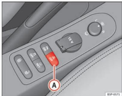
Fig. 138 Pormenor do botão do funcionamento Start-Stop.
