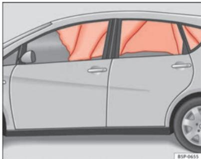
Fig. 25 Airbags da cabeça activados
