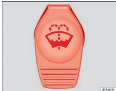
Fig. 166 Tampão do reservatório do limpa-vidros no compartimento do motor.
