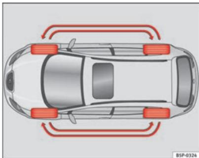
**Fig. 173** Esquema de troca dos pneus
