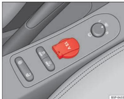
Fig. 118 Tomada de corrente na consola central dianteira
