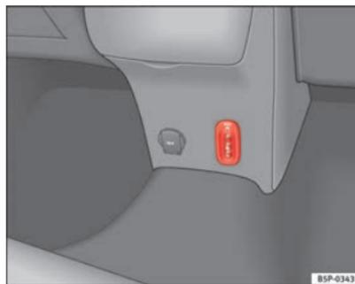
Fig. 120 Connessione AUX RSE
