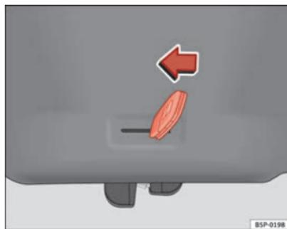
**Fig. 68** Portellone posteriore: apertura d'emergenza
