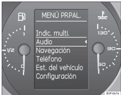
Fig. 48 Display digitale del quadro strumenti: Menu principale
