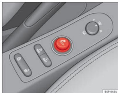
Fig. 117 Accendisigari all'interno della presa di corrente della console centrale anteriore
