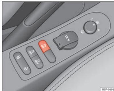
Fig. 149 Console centrale: Interruttore del sistema di assistenza per il parcheggio
