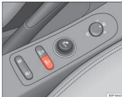
**Fig. 52** Consolle centrale: tasto del sistema controllo dei pneumatici
