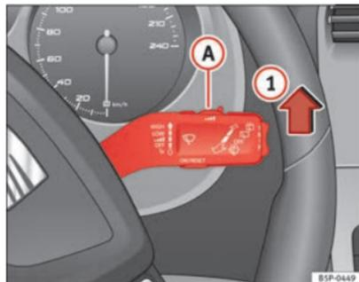
Fig. 87 Leva dell'impianto tergicristalli
