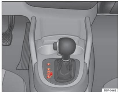
Fig. 142 Console centrale: leva del cambio automatico / cambio automatico DSG
