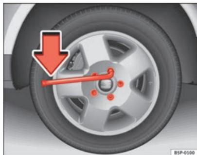
**Fig. 176** Cambio di una ruota: allentare le viti della ruota
