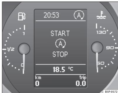
Fig. 139 Indicazione nel display del quadro strumenti durante la modalità Start-Stop.
