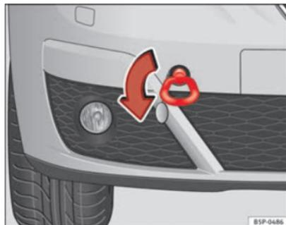
Fig. 204 Lato anteriore destro del veicolo: montaggio dell'anello per traino anteriore
