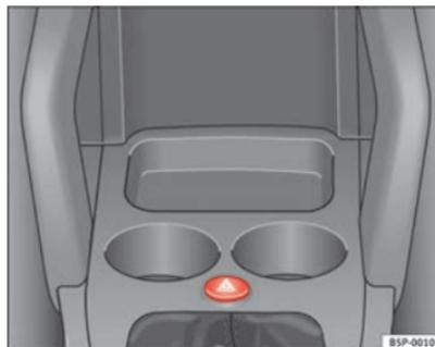
Fig. 77 Plancia portastrumenti: interruttore lampeggio di emergenza
