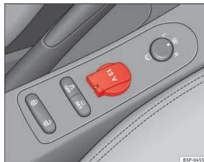
Fig. 118 Presa di corrente nella console centrale anteriore
