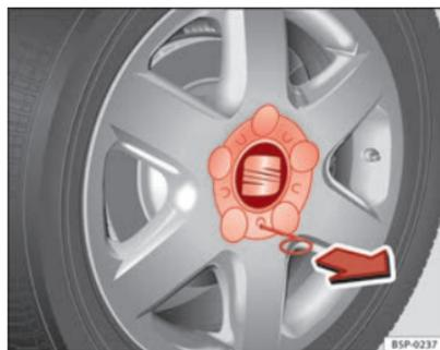
**Fig. 175** Cambio di una ruota: rimuovere il coprimozzo della ruota
