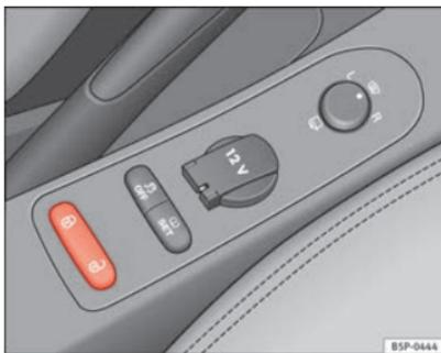
**Fig. 59** Dettaglio della console centrale: interruttore della chiusura centralizzata
