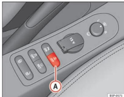
Fig. 138 Dettaglio del pulsante della modalità Start-Stop.
