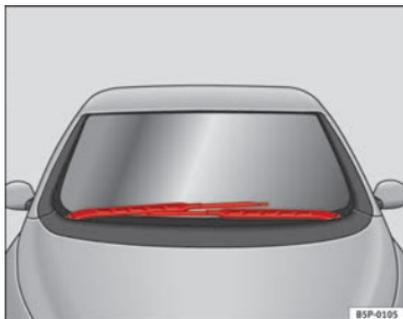
Fig. 167 Tergicristallo in posizione di manutenzione
