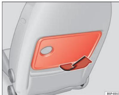
Fig. 104 Tavolinetto ripiegabile del sedile anteriore sinistro
