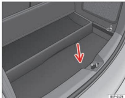
Fig. 174 Bagagliaio. Accesso alla ruota di scorta
