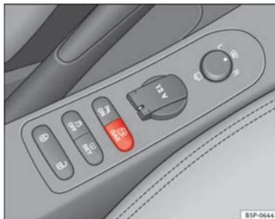
**Fig. 137** Console centrale: tasto di commutazione dell'impianto a gas.
