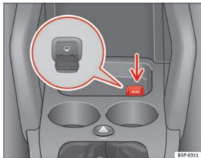
Fig. 119 Connettore per l'ingresso audio ausiliare
