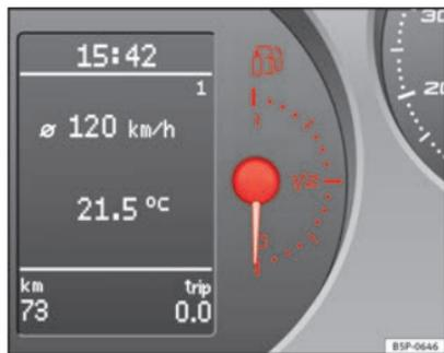
Fig. 37 Quadro strumenti: Indicatore del livello del GPL
