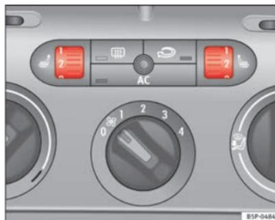
**Fig. 95** Rotelle zigrinate per il riscaldamento dei sedili anteriori
