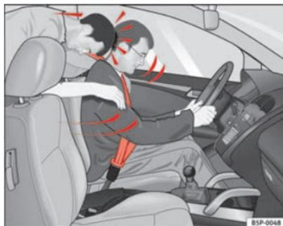
**Fig. 10 Non indossando la cintura, il passeggero seduto sul sedile posteriore viene scagliato in avanti, colpendo il conducente (che invece indossa la cintura)**
