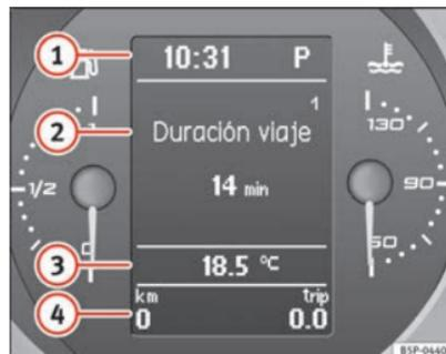
Fig. 39 Display digitale del quadro strumenti
