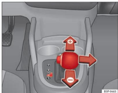
Fig. 146 Cambio del rapporto di marcia con Tiptronic
