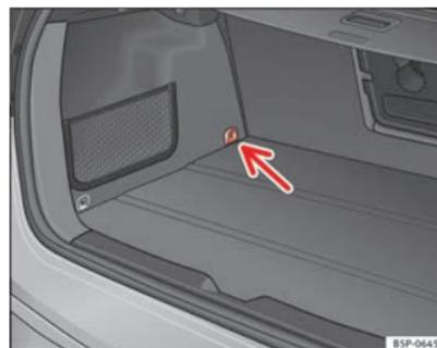
Fig. 32 Occhiello di fissaggio Toptether\*
