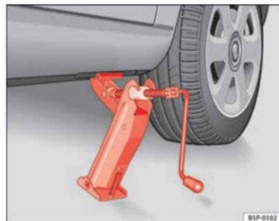
Fig. 178 Posizionamento del cric
