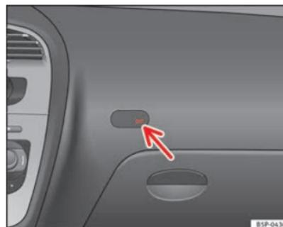
Abb. 27 Kontrollleuchte für Abschaltung der Beifahrerairbags
