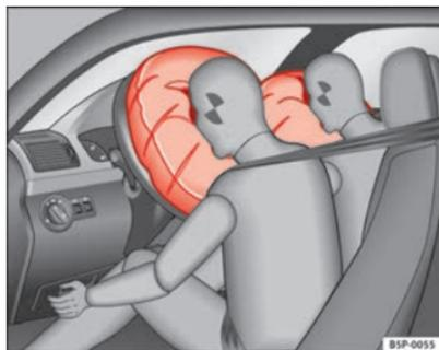
Abb. 20 Aufgeblasene Frontairbags
