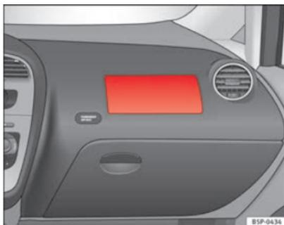
**Abb. 19 Einbautort Beifahrerairbag: in der Instrumententafel**
