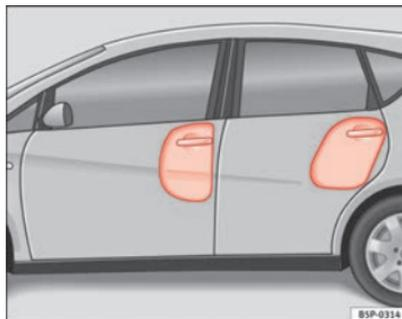
Abb. 23 Aufgeblasener Seitennairbag auf der linken Fahrzeugseite
