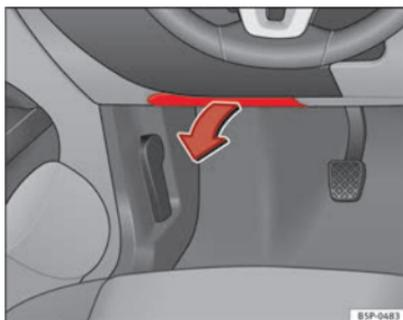
Abb. 180 Links in der Instrumententafel: Abdeckung des Sicherungskastens
