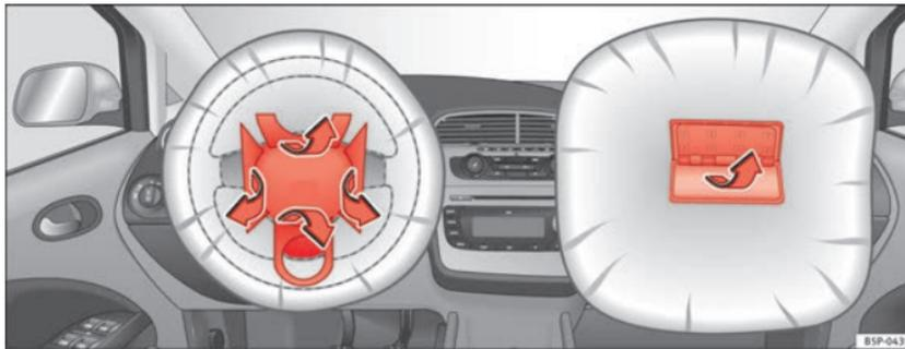
Abb. 21 Airbagabdeckungen bei ausgelösten Frontairbags
