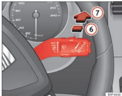
Abb. 88 Scheibenwischer- und Scheibenwaschhebel: Heckscheibenwischer
