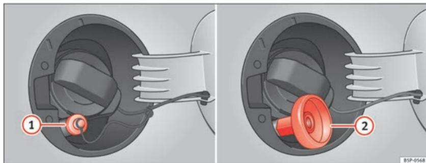
Abb. 158 Geöffnete Tankklappe mit Autogas-Einfüllstutzen und Adapter.
