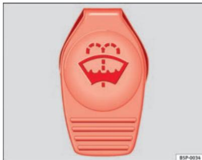
Abb. 166 Im Motorraum: Deckel des Scheibenwaschwasserbehälters
