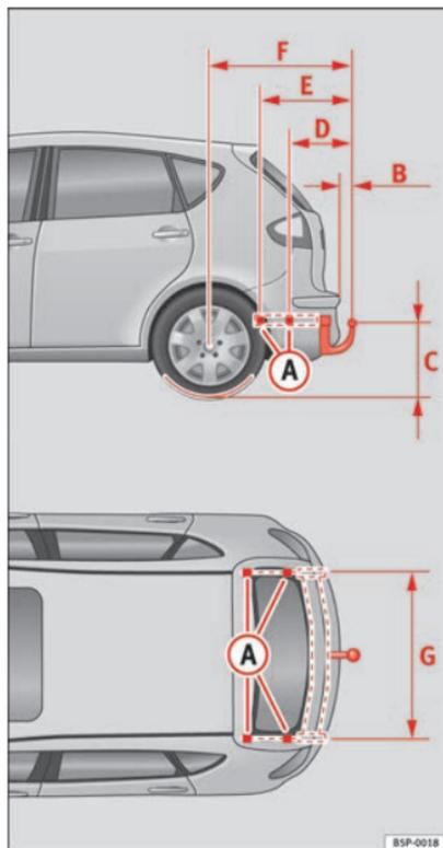
Abb. 156 Befestigungspunkte für die Anhängervorrichtung
