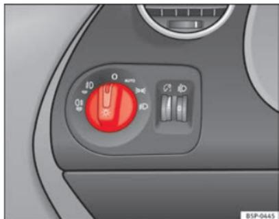
Abb. 74 Automatisches Fahrlicht
