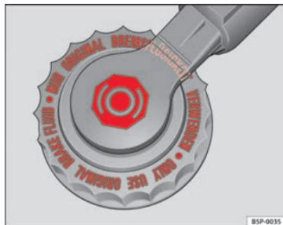
Abb. 171 Im Motorraum: Abdeckung des Bremsflüssigkeitsbehälters
