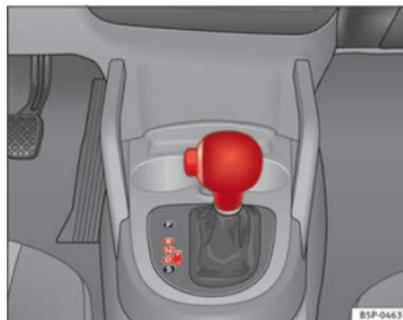
**Abb. 144 Wählhebelsperre lösen**
