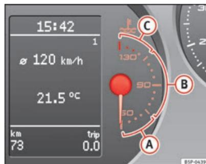
Abb. 36 Kombiinstrument: Motorkühlmitteltemperaturanzeige
