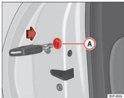
Abb. 60 Notverriegelung der Türen
