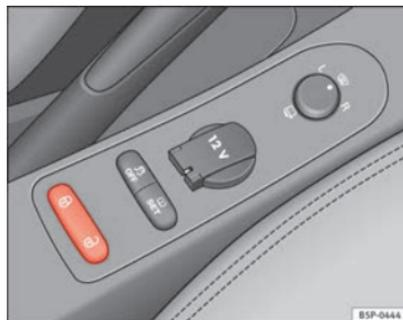
Abb. 59 Ansicht der Mittelkonsole: Taster für Zentralverriegelung
