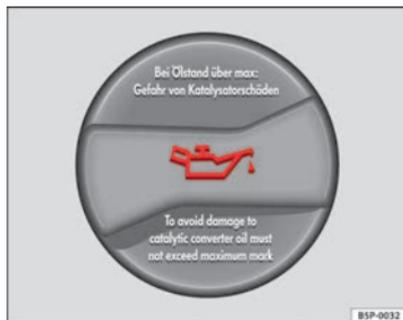
Abb. 164 Deckel der Motoröl-Einfüllöffnung im Motorraum
