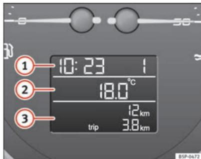
Abb. 38 Ausschnitt aus Kombiinstrument: Display mit verschiedenen Anzeigeelementen
