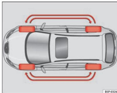
Abb. 173 Schema für das Tauschen der Räder
