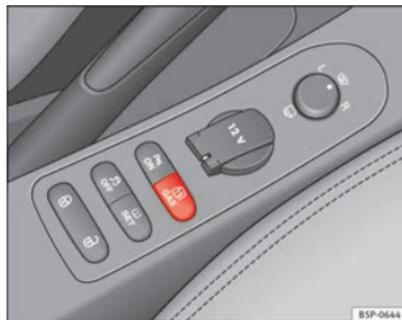
Abb. 137 Mittelkonsole: Kontrollschalter für Autogasanlage.
