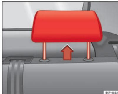
Abb. 5 Kopfstütze in Gebrauchsstellung
