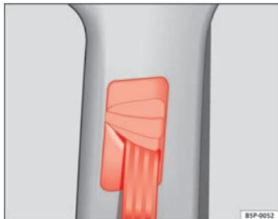
Abb. 17 Einbauort der Gurthöheneinstellung
