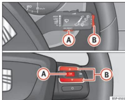
Abb. 43 Wipptasten A und B, Bedienelemente am Lenkrad.
