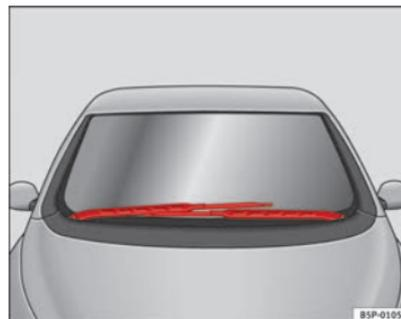
Abb. 167 Scheibenwischer in Service-Stellung
