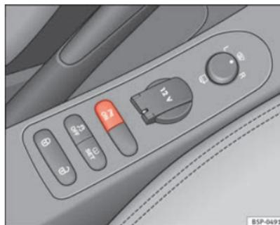
Abb. 149 Mittelkonsole: Schalter für Einparkhilfe
