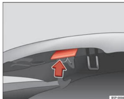
Abb. 162 Riegel der Motorraumklappe
