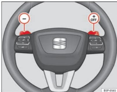
Abb. 147 Lenkrad mit Wippen für Automatikgetriebe
