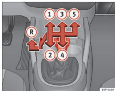
Abb. 140 Ansicht der Mittelkonsole: Schalt-schema eines 5-Gang-Schaltgetriebes
