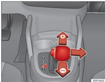
Abb. 146 Schalten mit Tiptronic
