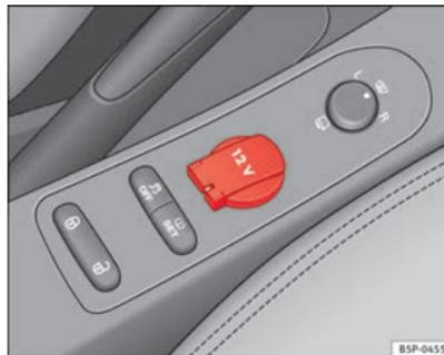
Abb. 118 Steckdose an der Mittelkonsole vorne
