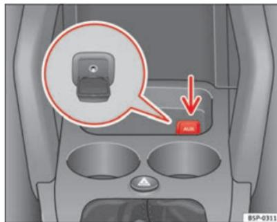
Abb. 119 Anschluss für einen zusätzlichen Audio-Eingang
