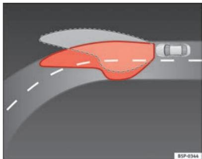
Abb. 76 Beleuchtung der Kurve mit Kurvenfahrlicht
