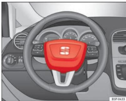
**Abb. 18 Einbautort Fahrerairbag: im Lenkrad**
