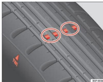
Abb. 172 Prinzipdarstellung Reifenprofil: Verschleißanzeiger
