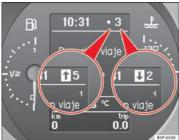
Fig. 40 Gear display
