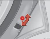
Fig. 62 Childproof lock on the right hand side door
