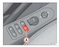
Fig. 137 The Start-Stop function button.
