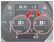
Fig. 40 Gear display
