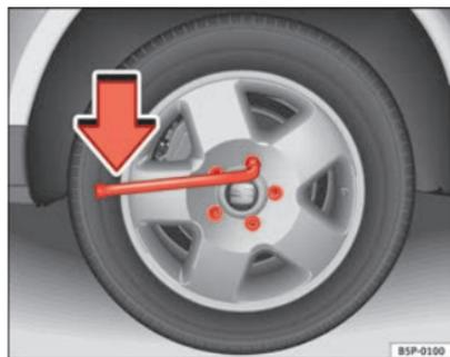
**Fig. 180** Cambio di una ruota: allentare le viti delle ruote
