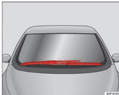
**Fig. 170** Tergicristallo in posizione di manutenzione
