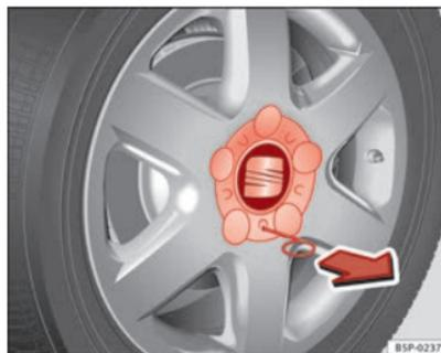
**Fig. 179** Cambio di una ruota: rimuovere il coprismozzo della ruota
