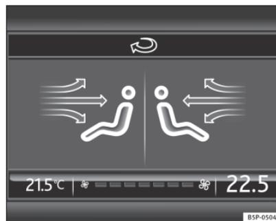
Fig. 134 Display del navigatore con informazioni del Climatronic
