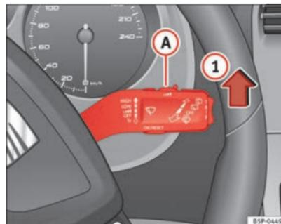
Fig. 85 Leva dell'impianto tergicristalli ▶
