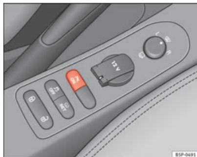
Fig. 153 Console centrale: Interruttore del sistema di assistenza per il parcheggio
