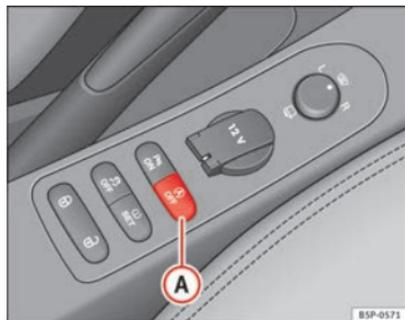
Fig. 142 Dettaglio del pulsante della modalità Start-Stop.
