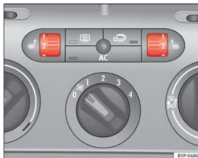
Fig. 93 Rotelle zigrinate per il riscaldamento dei sedili anteriori
