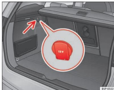
Fig. 118 Modello Altea XL/Freetrack: presa di corrente nel bagagliaio ▶
