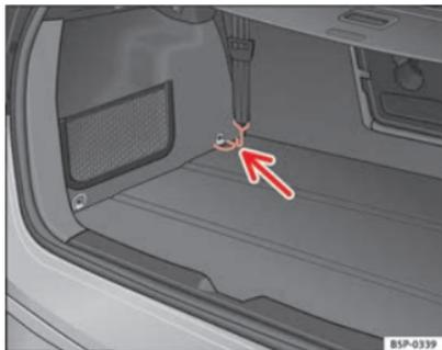
Fig. 128 Anelli di fissaggio per tendere la rete di separazione
