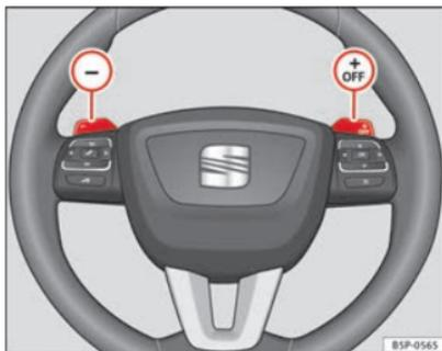
Fig. 151 Volante con leve per il cambio automatico
