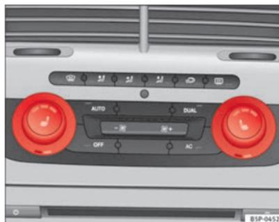
Fig. 94 Riscaldamento sedili anteriori con Climatronic
