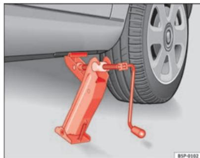
Fig. 182 Posizionamento del cric
