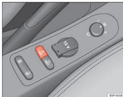
**Fig. 139** Dettaglio della console centrale: tasto ESC.
