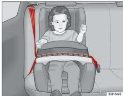
Fig. 29 Seggiolino del gruppo 1 montato sul sedile posteriore; il bambino siede rivolto verso il senso di marcia
