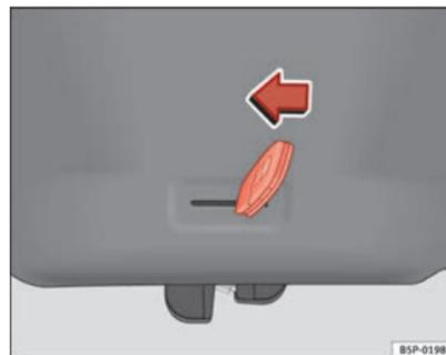
Fig. 66 Portellone posteriore: apertura d'emergenza
