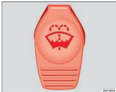
**Fig. 169 Vano motore: tappo del serbatoio del liquido lavacristalli**
