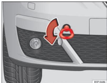
**Fig. 216** Lato anteriore destro del veicolo: montaggio dell'anello per traino anteriore
