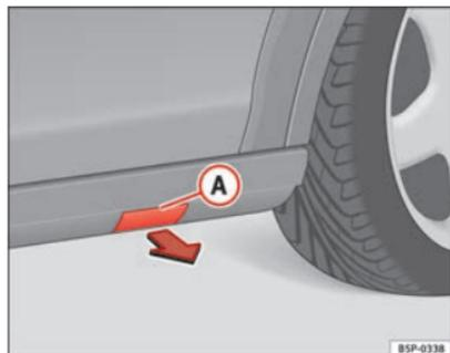
Fig. 183 Sottoporta in plastica con sede per fissaggio del cric
