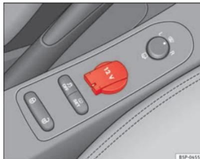
Fig. 117 Presa di corrente nella consolle centrale anteriore
