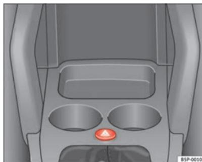
Fig. 74 Plancia portastrumenti: interruttore lampeggio di emergenza
