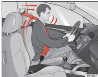
**Fig. 11** Conducente con la cintura di sicurezza allacciata correttamente: durante una frenata brusca viene trattenuto dalla cintura di sicurezza
