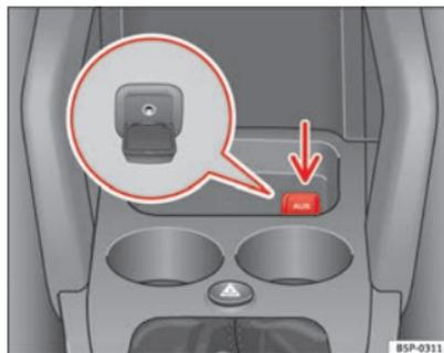
Fig. 119 Connettore per l'ingresso audio ausiliare
