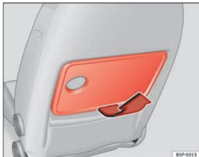
Fig. 103 Tavolinetto ripiegabile del sedile anteriore sinistro
