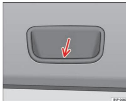
Fig. 65 Dettaglio del rivestimento interno del portellone posteriore: maniglia di presa ad incavo
