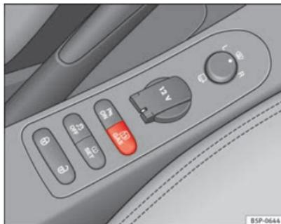
Fig. 141 Console centrale: tasto di commutazione dell'impianto a gas.
