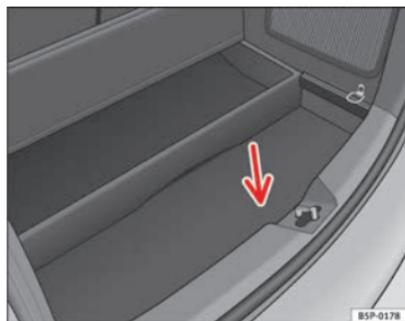
Fig. 178 Bagagliaio. Accesso alla ruota di scorta
