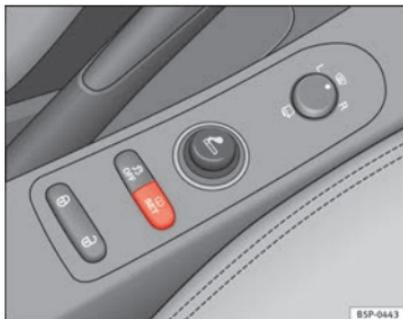
Fig. 50 Console centrale: tasto del sistema controllo dei pneumatici
