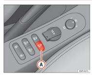
Fig. 142 The Start-Stop function button.
