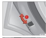
Fig. 59 Childproof lock on the left hand side door
