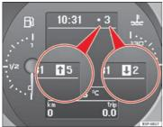
Fig. 40 Gear display
