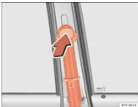
Fig. 15 Dispositivo di regolazione dell'altezza della cintura
