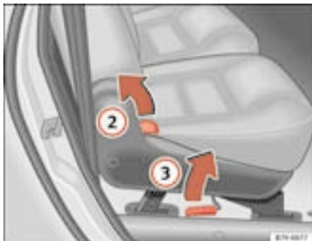
**Fig. 91** Parte laterale del sedile: ribaltare in avanti lo schienale e sollevare il sedile
