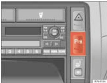
**Fig. 132** Particolare della plancia della strumentazione: tasto del sistema di controllo per il parcheggio
