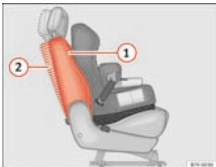
Fig. 34 Posizione dello schienale quando sul sedile è montato un seggiolino per bambini
