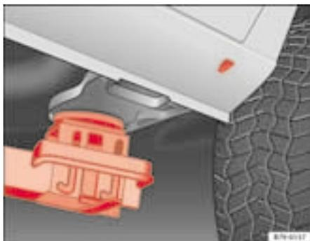
Fig. 177 Punto di appoggio sulla parte posteriore sinistra per il sollevamento del veicolo con ponte sollevatore
