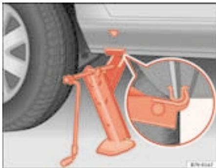
Fig. 162 Posizione del cric sul lato posteriore destro
