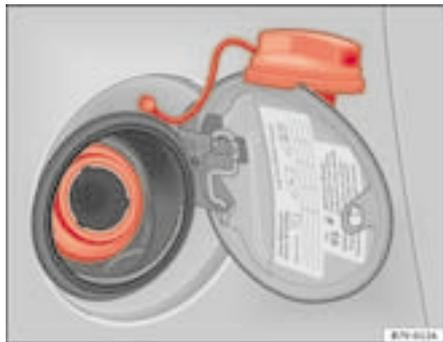
Fig. 138 Bocchettone d'immissione del carburante e sportellino di chiusura del serbatoio
