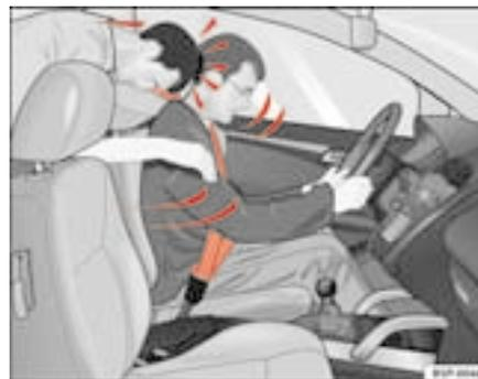
**Fig. 8 Non indossando la cintura, il passeggero seduto sul sedile posteriore viene scagliato in avanti, colpendo il conducente (che invece indossa la cintura).**
