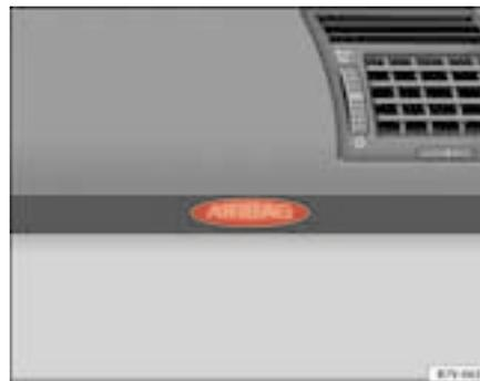
**Fig. 23** Airbag frontale del passeggero sulla plancia portastrumenti
