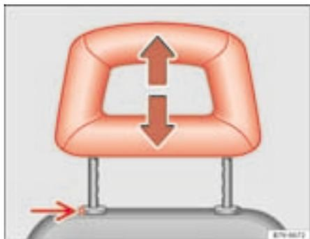
Fig. 86 Poggiatesta: regolazione dell'altezza oppure smontaggio
