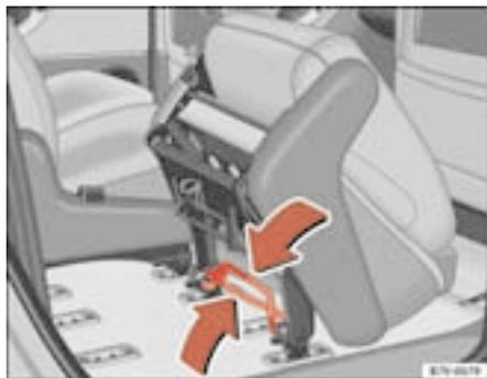
Fig. 93 Staffa per lo smontaggio ed il rimontaggio del sedile singolo
