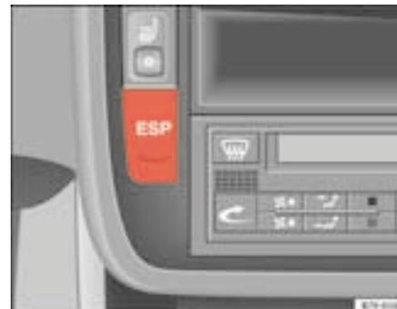
**Fig. 125** Dettaglio della plancia: tasto ESP
