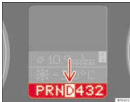
Fig. 129 Quadro strumenti: display con l'indicazione della marcia inserita
