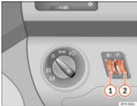
Fig. 72 Cruscotto: regolazione fari ① e dell'intensità d'illuminazione strumenti e comandi ②
