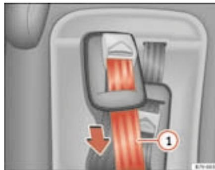
Fig. 38 Dettaglio del seggiolino integrato nel sedile: dispositivo di regolazione delle bretelle
