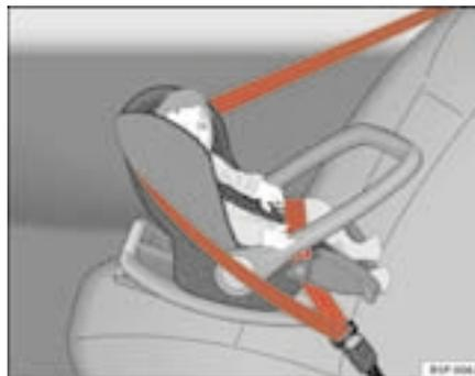
**Fig. 30** Seggiolino per bambini del gruppo 0, montato sul sedile posteriore e disposto nel senso contrario a quello di marcia
