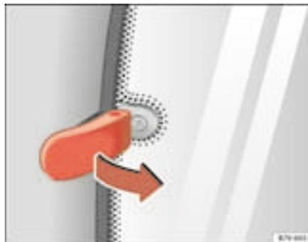
Fig. 65 Levetta di sbloccaggio del deflettore ad apertura meccanica
