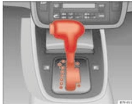
Fig. 128 Console centrale: la leva selettoria con tasto di blocco
