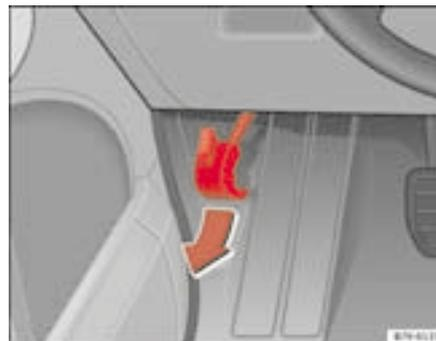
**Fig. 139** Vano piedi del conducente: leva di sblocco del cofano del vano motore
