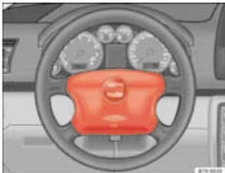
**Fig. 22** Airbag del conducente all'interno del volante
