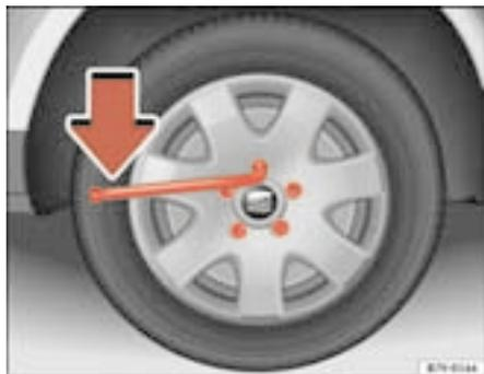
Fig. 159 Cambio di una ruota: come allentare le viti
