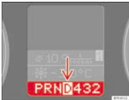
Fig. 131 Dettaglio del quadro strumenti: il display con l'indicazione della marcia inserita
