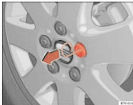
Fig. 158 Stacco del cappuccio con la staffa
