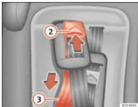
Fig. 39 Dettaglio del seggiolino integrato nel sedile: dispositivo di regolazione delle bretelle
