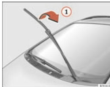
Abb. 146 Scheibenwischer vorne hochklappen
