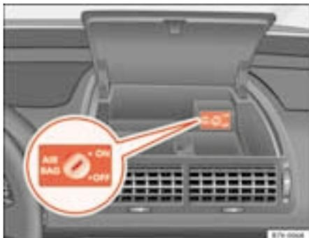
Abb. 28 Innenraum des Ablagefachs in der Mitte der Instrumententafel: Schlüsselumschalter zum Abschalten der Beifahrer-Airbags
