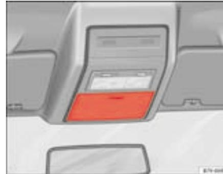
Abb. 104 Ablagefach im Dachhimmel
