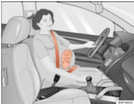
Abb. 14 Gurtbandverlauf bei schwangeren Frauen
