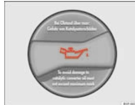
**Abb. 143** Deckel der Motoröl-Einfüllöffnung im Motorraum
