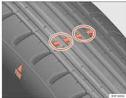
**Abb. 150** Prinzipdarstellung Reifenprofil: Verschleißanzeiger
