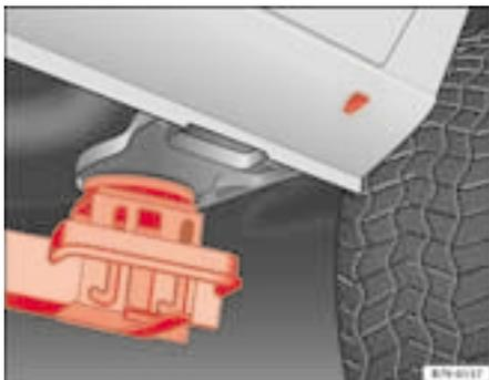
Abb. 177 Anheben mit der Hebebühne: Aufnahmepunkt hinten links
