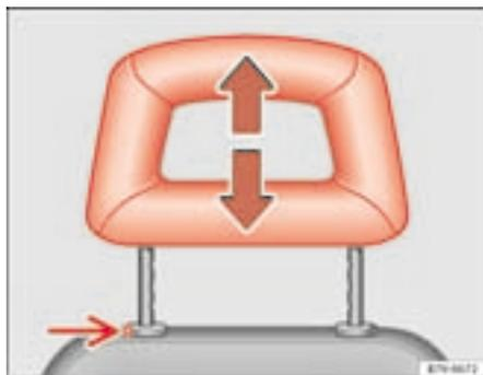
Abb. 86 Kopfstütze einstellen oder ausbauen
