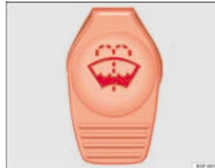
**Abb. 145** Im Motorraum: Deckel des Scheibenwaschwasserbehälters
