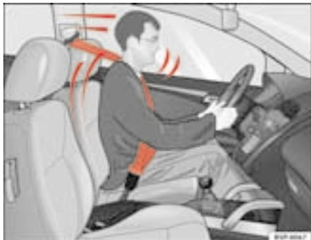
**Abb. 9** Angegurter Fahrer, der bei einem plötzlichen Bremsmanöver vom richtig angelegten Sicherheitsgurt aufgefangen wird
