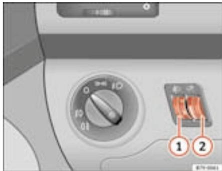
Abb. 72 Ausschnitt von der Instrumententafel: Regler für Leuchtweitenregulierung ① und Instrumenten-/Schalterbeleuchtung ②
