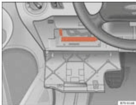
Abb. 163 Links in der Instrumententafel: Sicherungskasten
