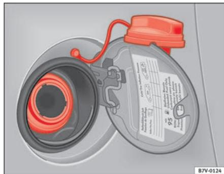
**Fig. 137** Bocchettone d'immissione del carburante e sportellino di chiusura del serbatoio
