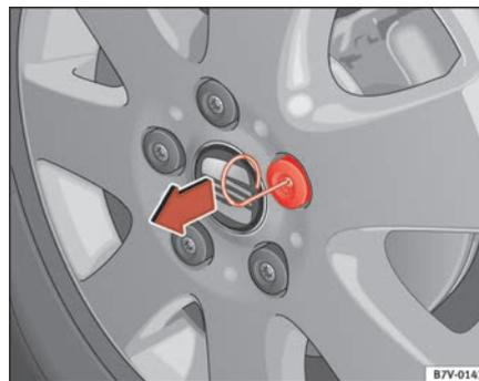
Fig. 157 Stacco del cappuccio con la staffa
