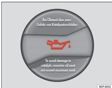
**Fig. 142 Vano motore: tappo del bocchettone di rifornimento dell'olio motore**
