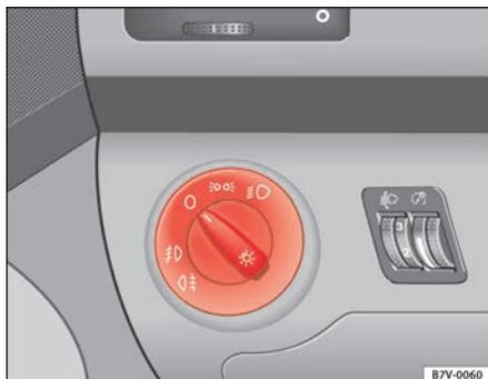
Fig. 70 Dettaglio della plancia portastrumenti: interruttore luci, fari fendinebbia e retronebbia
