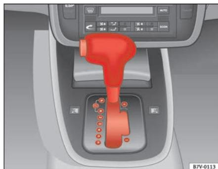
Fig. 130 Dettaglio della console centrale: la leva selettoria con il tasto di sbloccaggio
