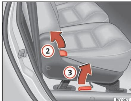
**Fig. 90** Parte laterale del sedile: ribaltare in avanti lo schienale e sollevare il sedile
