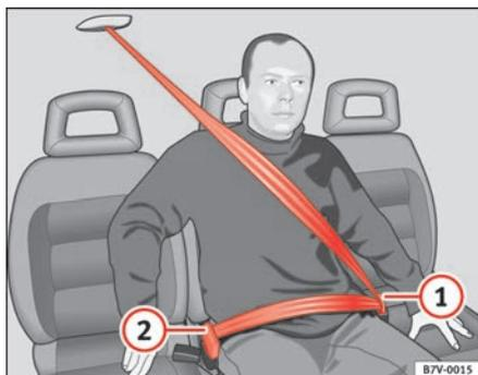
Fig. 17 Slacciamento di cintura dotata di due blocchetti di aggancio
