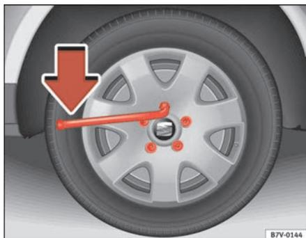
Fig. 158 Cambio di una ruota: come allentare le viti
