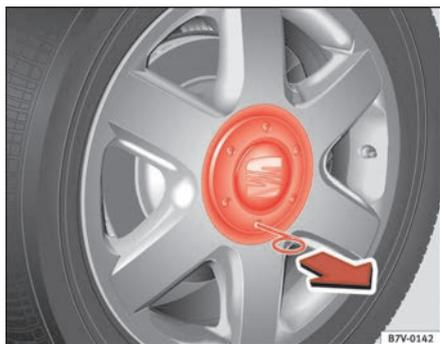
Fig. 156 Stacco del coprimozzo
