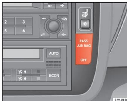
Fig. 29 Spia sulla plancia per la segnalazione della disattivazione degli airbag
