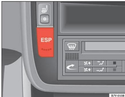
**Fig. 125** Dettaglio della plancia: tasto ESP
