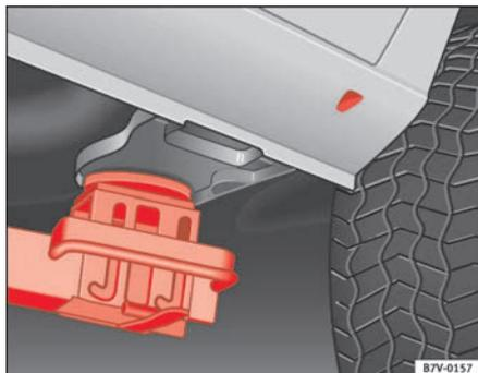
Fig. 176 Punto di appoggio sulla parte posteriore sinistra per il sollevamento del veicolo con ponte sollevatore
