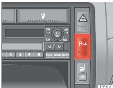
**Fig. 132** Detalle del tablero de instrumentos: Tecla del control de la distancia de aparcamiento
