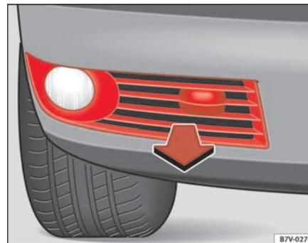
**Fig. 173 Argolla de remolque delantera**
