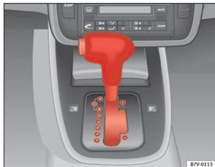
Fig. 130 Consola central: palanca selectora del cambio y tecla de bloqueo
