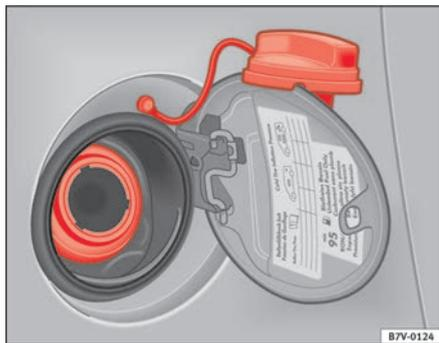
**Fig. 137** Boca de llenado de combustible y tapa del depósito
