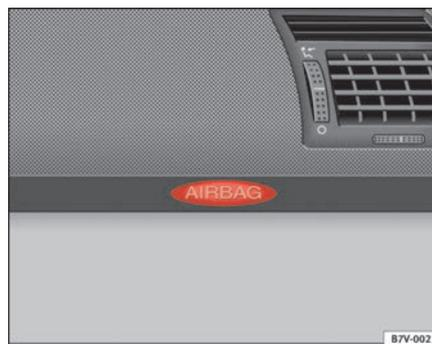
**Fig. 23** Airbag frontal del acompañante en el tablero de instrumentos
