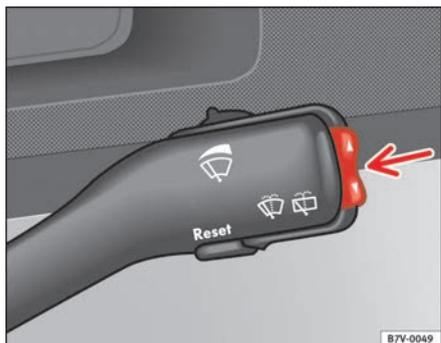
Fig. 51 Tecla de la palanca del limpiacristales
