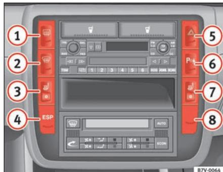
**Fig. 72** Conmutador de los intermitentes de emergencia
