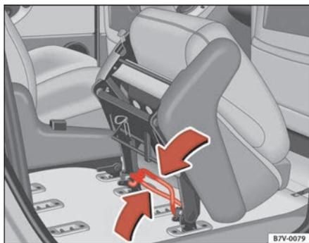
Fig. 92 Estribos para desmontar y montar el asiento
