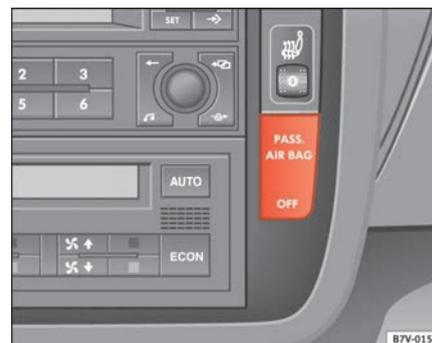
Fig. 29 Testigo de control de la desactivación del airbag en el tablero de instrumentos
