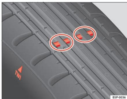
**Fig. 149** Indicadores de desgaste del perfil del neumático
