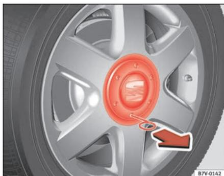
Fig. 156 Desmontaje del tapacubos
