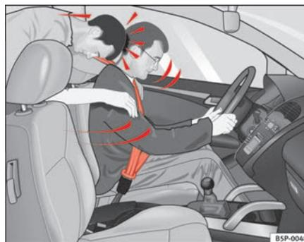
**Fig. 8 El ocupante del asiento trasero que no lleve puesto el cinturón de seguridad se verá lanzado hacia adelante sobre el conductor que sí lleva el cinturón.**
