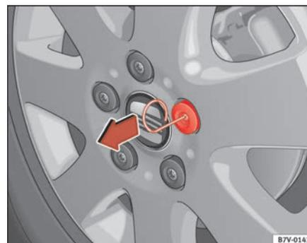
Fig. 157 Extracción de los capuchones con el alambre
