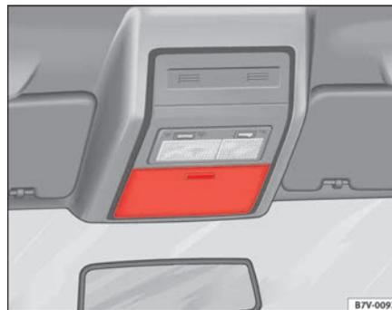
Fig. 103 Portaobjetos en el revestimiento interior del techo
