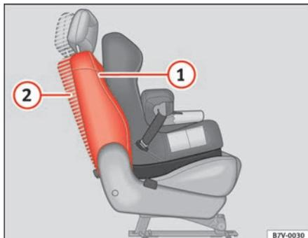
Fig. 34 Posición del respaldo al utilizar asientos para niños con sistema de fijación ISOFIX
