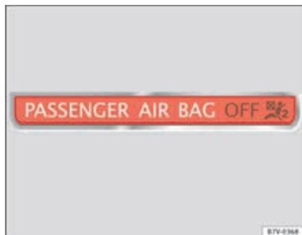
Fig. 16 Aviso de controlo, no painel de instrumentos, da desactivação do airbag frontal do passageiro.
