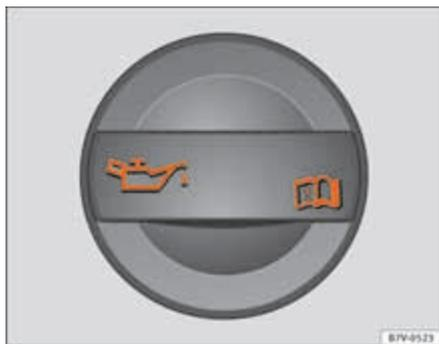
Fig. 176 No compartimento do motor: Tampão da abertura de enchimento do óleo do motor.
