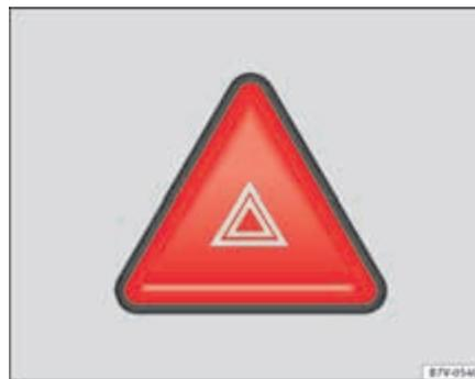
Fig. 195 No centro do painel de instrumentos: Botão das luzes de emergência.
