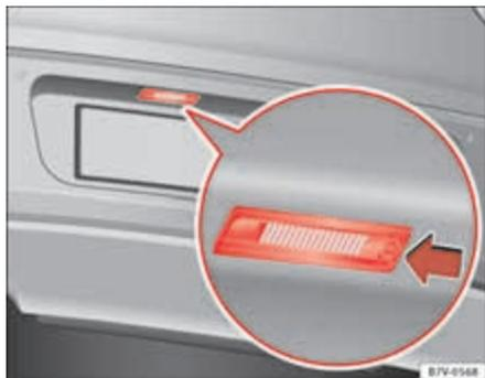
Fig. 223 No pára-choques traseiro: iluminação da matrícula.
