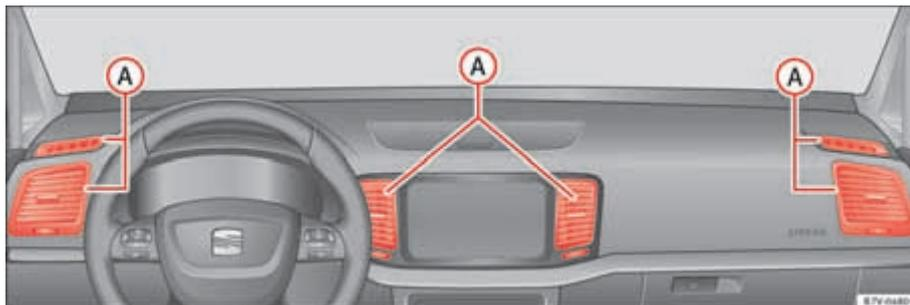
Fig. 131 Difusores de ar no painel de instrumentos.
