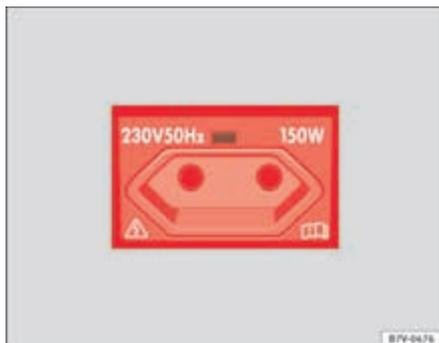
**Fig. 127** Pormenor da consola central traseira: Tomada de corrente europeia de 230 Volts.
