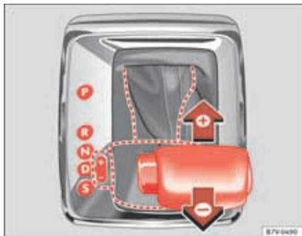
Fig. 141 Alavanca seletora na posição Tiptronic (veículos com volante à esquerda). Os veículos com o volante à direita estão dispostos de forma simétrica.
