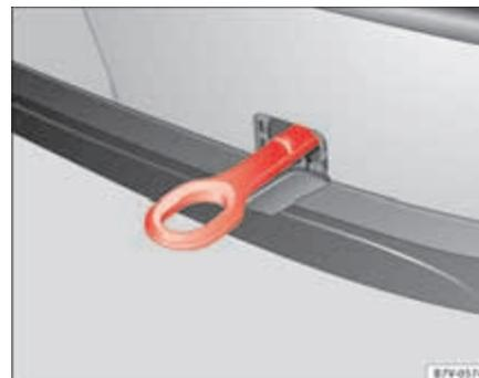
Fig. 229 No pára-choques traseiro, no lado direito: Argola de rebocagem enroscada.
