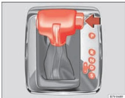
Fig. 140 Veículos com volante à direita: Alavanca selectora da caixa automática com botão de bloqueio (seta).
