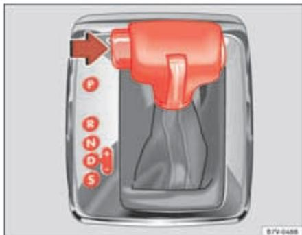
Fig. 139 Veículos com volante à esquerda: Alavanca selectora da caixa automática com botão de bloqueio (seta).
