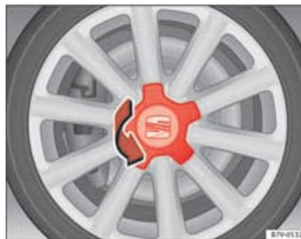
Fig. 187 Desmontagem do tampão rodando para fora.
