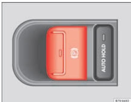
Fig. 143 Pormenor da consola central: comutador do travão de estacionamento electrónico.
