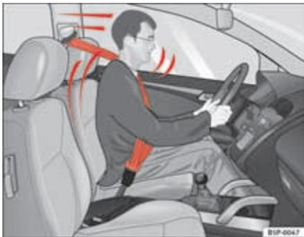
**Fig. 9 Os condutores que tenham o cinto de segurança correctamente colocado não serão projectados em caso de travagens repentinas.**
