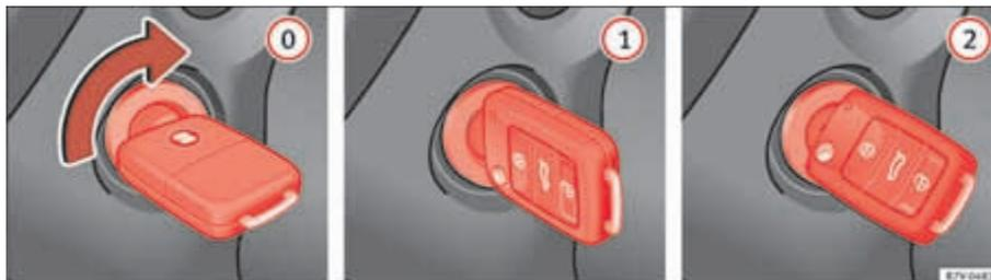
Fig. 134 Posições da chave do veículo.
