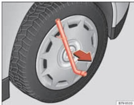
Fig. 188 Desmontar o tampão integral.
