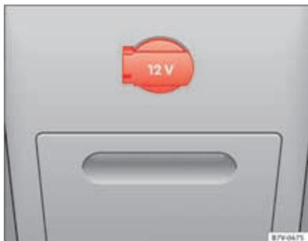
**Fig. 126** Parte posterior da consola central: Tomada de corrente de 12 Volts.
