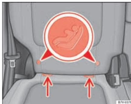
Fig. 27 Versão 1: identificação dos pontos de ancoragem para a cadeira de criança no banco do veículo.
