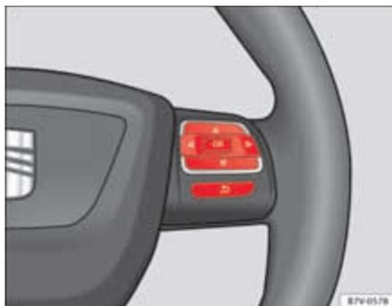
**Fig. 39** Lado direito do volante multifunções: Botões para utilizar os menus do painel de instrumentos.
