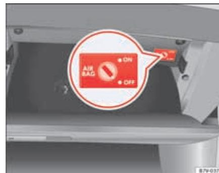
**Fig. 19** No porta-luvas, no lado do passageiro: interruptor de chave para activar e desactivar o airbag frontal do passageiro.
