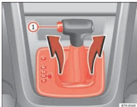
Fig. 204 Desmontar o revestimento do campo de indicação das mudanças.
