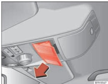
**Fig. 202** No revestimento interior do tecto: Retire a cobertura.
