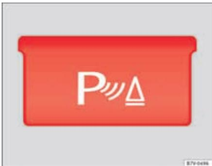
Fig. 148 Pormenor da consola central: botão para activar ou desactivar o controlo da distância de estacionamento.
