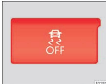
Fig. 144 Pormenor da consola central: botão para activar ou desactivar manualmente o TCS (veículos com ESP).
