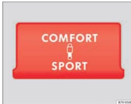
Fig. 160 Pormenor da consola central: botão para ajustar a suspensão adaptativa.
