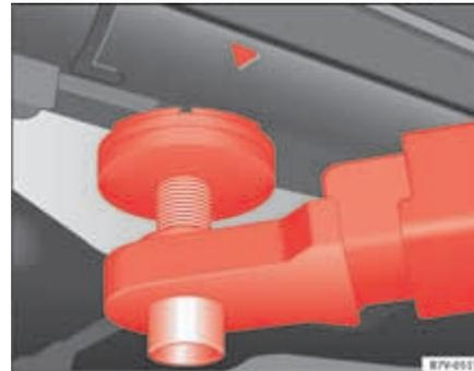
Fig. 168 Pontos de apoio traseiros para elevar o veículo com a plataforma elevatória ou com o macaco.
