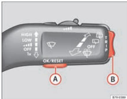
**Fig. 38** Em veículos sem volante multifunção: No manípulo do limpa pára-brisas: botão (A) para confirmar opções do menu, e botão basculante (B) para mudar de menu.
