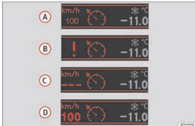
Fig. 158 Visor do painel de instrumentos: indicações do estado do GRA.
