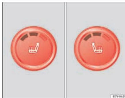
Fig. 85 Pormenor da consola central: comandos para o aquecimento dos bancos dianteiros, aqui com o segundo nível de temperatura ajustado.
