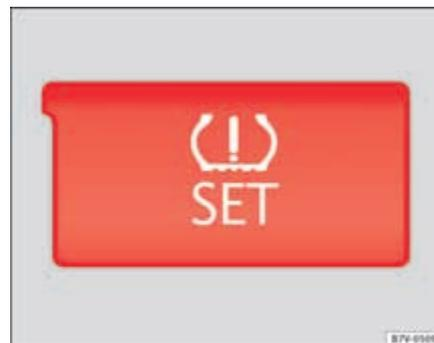
Fig. 161 Pormenor da consola central: botão do indicador da pressão dos pneus.
