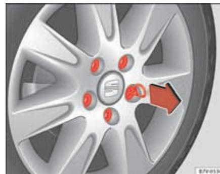
Fig. 189 Retirar os protectores dos parafusos da roda. ▶
