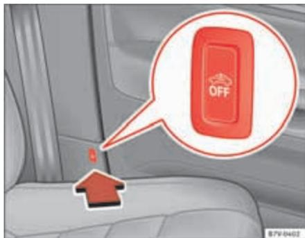
Fig. 51 Junto ao banco do condutor: botão para desactivar a vigilância do habitáculo e o sistema anti-reboque.
