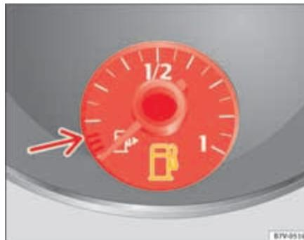
**Fig. 169** No painel de instrumentos: indicador do nível de combustível para gasolina e diesel. ▶
