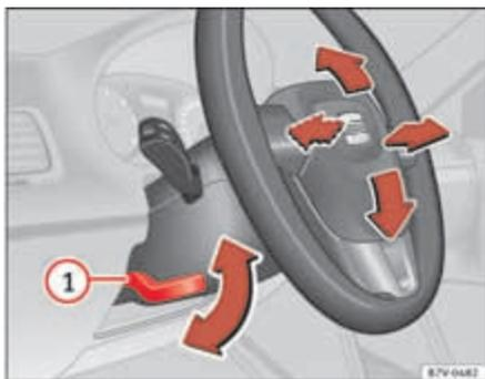
Fig. 133 Ajuste mecânico do volante.
