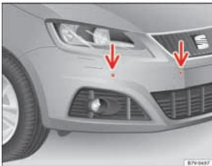
Fig. 149 Sensores do controlo de estacionamento no pára-choques dianteiro.
