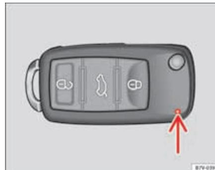
Fig. 42 Aviso de controlo na chave do veículo.
