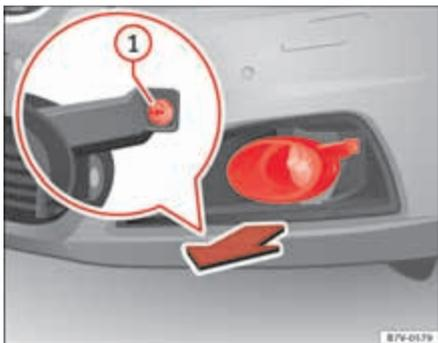
**Fig. 217** Na parte direita do pára-choques dianteiro: Desmontagem dos faróis.
