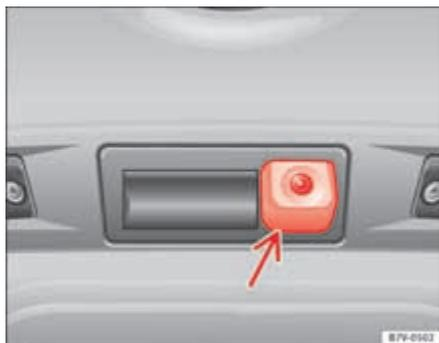
Fig. 154 Na porta da bagageira: localização da câmara do assistente para a marcha-atrás.
