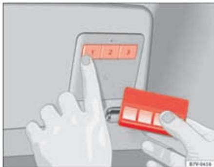
Fig. 65 Para programar: Pressione os botões do comando do portão da garagem e do comando à distância simultaneamente.
