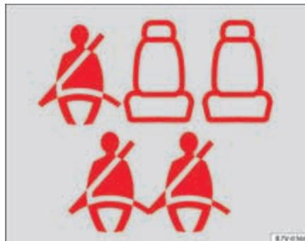
Fig. 4 Exemplo de indicação do estado do cinto nos lugares traseiros (aqui, num veículo de 7 lugares) no painel de instrumentos: por cima, a segunda fila; por baixo, a terceira fila de bancos. ►
