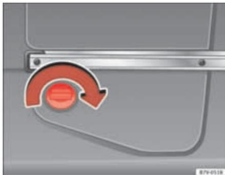
Fig. 171 Na parte traseira esquerda da bagageira: depósito de AdBlue, atrás de uma cobertura.
