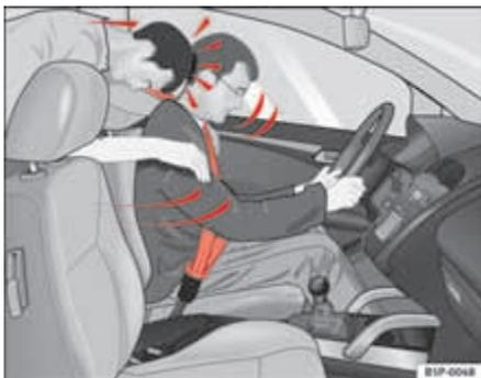
**Fig. 8** O ocupante do banco traseiro que não tiver colocado o cinto de segurança será projectado em frente, para cima do condutor que tem o cinto colocado.
