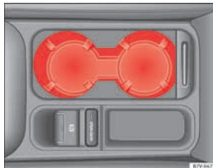
Fig. 122 Consola central à frente: suporte de bebidas.
