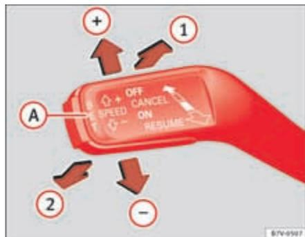
Fig. 159 À esquerda da coluna de direcção: manípulo de utilização do regulador de velocidade.
