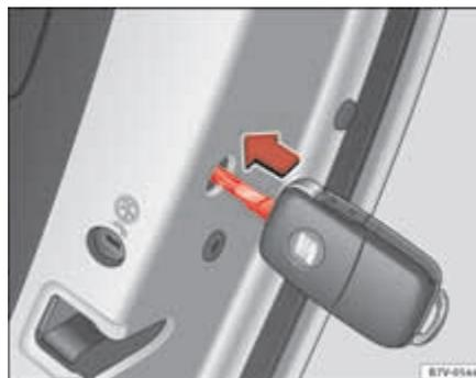
Fig. 199 Trancagem de emergência do veículo com a chave do veículo.
