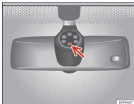
Fig. 76 Superfície sensível do sensor de chuva.
