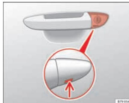
Fig. 197 Manípulo da porta do condutor: Canhão da fechadura oculto.
