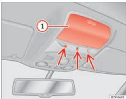
Fig. 52 Na consola do tecto: sensores de vigilância do habitáculo.
