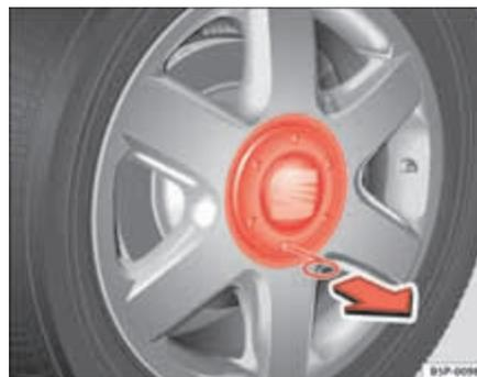
Fig. 186 Desmontagem do embelezador da roda.
