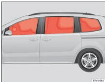
Fig. 23 Airbags da cabeça activados
