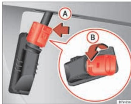
Fig. 224 Luz da matrícula: Desmontar o porta-lâmpadas.
