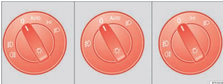
Fig. 67 Ao lado do volante: representação de algumas variantes do comando das luzes.
