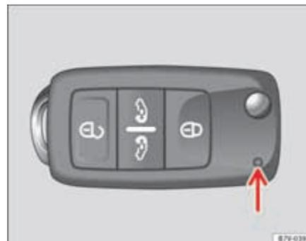
Fig. 43 Aviso de controlo na chave de veículos com portas correções eléctricas.
