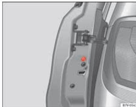
Fig. 198 Na parte frontal da porta do passageiro: Trancagem de emergência, oculto por uma junta de borracha.
