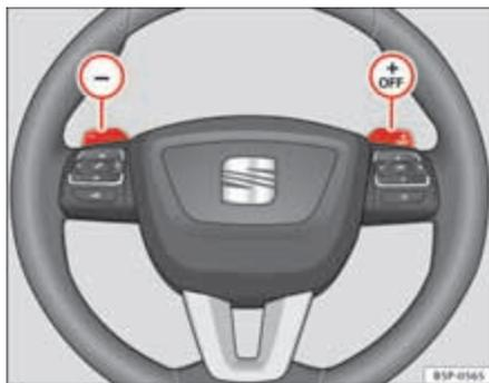
Fig. 142 Volante com duas patilhas para o Tiptronic.
