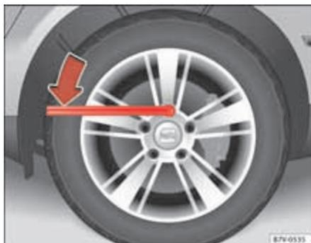
Fig. 190 Substituição de roda: alivie os parafusos da roda.
