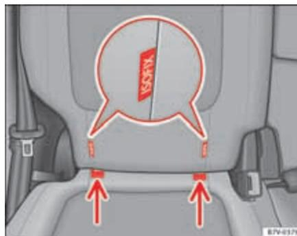
Fig. 28 Versão 2: identificação dos pontos de ancoragem para a cadeira de criança no banco do veículo.
