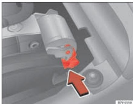
Fig. 205 Destrancagem de emergência do bloqueio da alavanca selectora.
