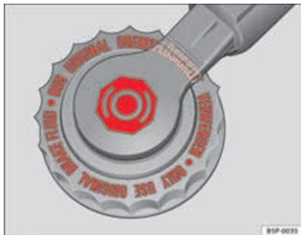
Fig. 145 No compartimento do motor: tampão do reservatório do líquido dos travões
