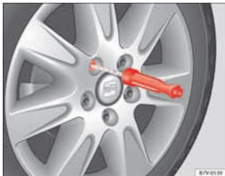
Fig. 194 Substituição de roda: desapertar os parafusos da roda com o punho da chave de parafusos.
