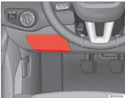
Fig. 209 No painel de instrumentos do lado do condutor: tampa da caixa de fusíveis.
