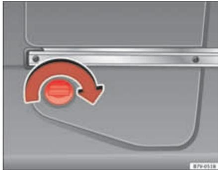
Fig. 171 Dans la partie arrière gauche du coffre: réservoir d'AdBlue, derrière un couvercle.
