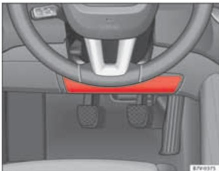
Fig. 24 Côte conducteur : emplacement de l'airbag de genoux.
