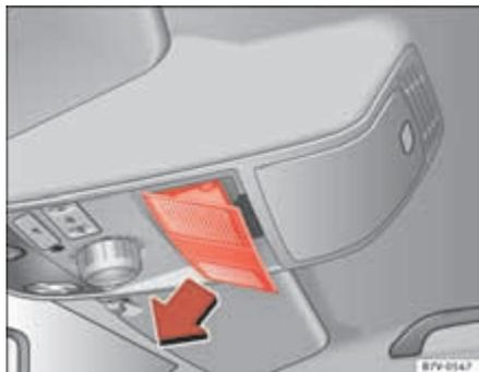
Fig. 202 Dans le ciel de pavillon : retirez le cache.
