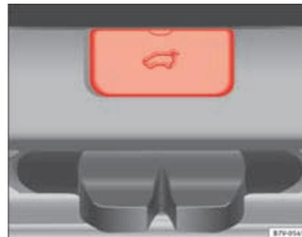
Fig. 200 Dans le coffre à bagages : démontage du cache du hayon.
