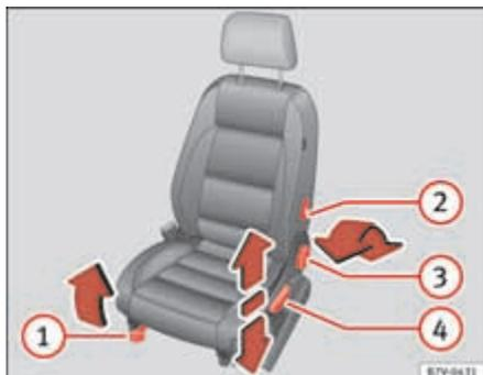
Fig. 81 Commandes du siège avant gauche.
