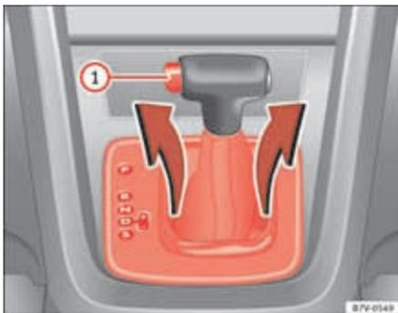
Fig. 204 Démontez le revêtement du champ d'indication des vitesses.
