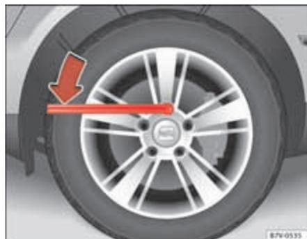
Fig. 190 Changement de roue : desserrez les boulons de la roue.
