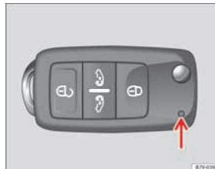
Fig. 43 Témoin de contrôle sur la clé du véhicule pour les véhicules à portes coulissantes électriques.
