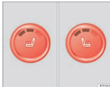
Fig. 85 Détail de la console centrale : commandes pour le chauffage des sièges avant, dans notre cas avec le second niveau de température activé.
