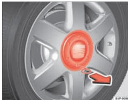
Fig. 186 Démontage de l'enjoliveur de la roue.
