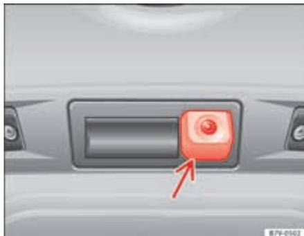
**Fig. 154** Dans le hayon arrière : emplacement de la caméra de l'assistant de marche arrière.
