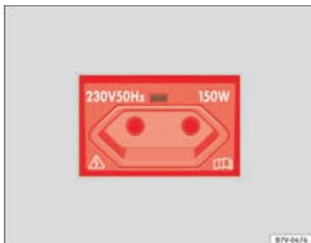
Fig. 127 Détail de la console centrale arrière : Prise de courant européenne de 230 volts.
