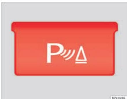
Fig. 148 Détail de la console centrale : touche pour activer ou désactiver le système d'aide au stationnement.
