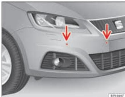
Fig. 149 Capteurs du système d'aide au stationnement dans le pare-chocs avant.
