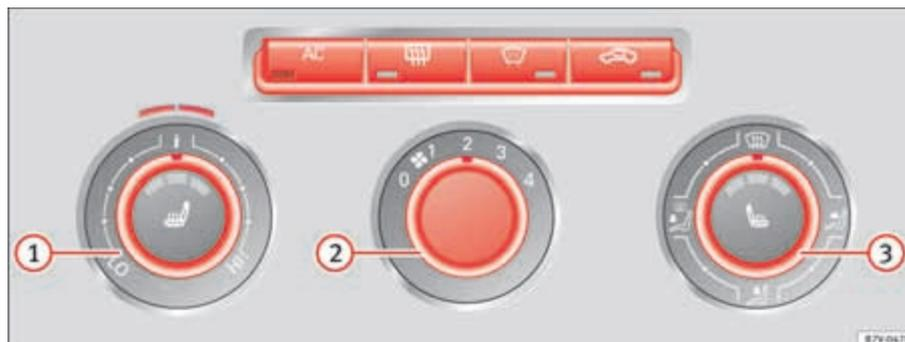
Fig. 129 Détail de la console centrale : Commandes du Climatic.
