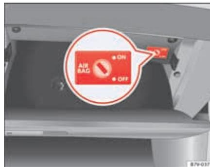
Fig. 19 Dans la boîte à gants, côté passager : commande à clé pour activer et désactiver l'airbag frontal côté passager.
