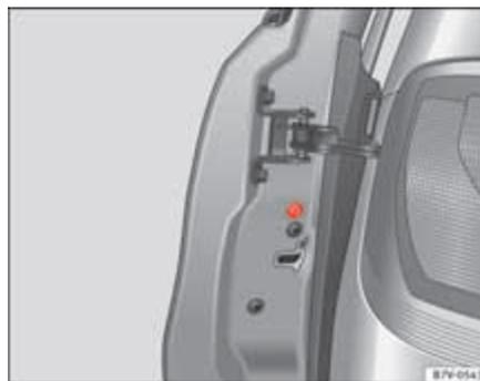
Fig. 198 Sur la face avant de la porte du passager : verrouillage de secours, caché par un joint en caoutchouc.
