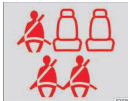
Fig. 4 Exemple d'indication de l'état de la ceinture pour les places arrière (dans le cas présent, véhicule à 7 places) sur le tableau de bord. en haut, deuxième rangée ; en bas, troisième rangée de sièges. ▶
