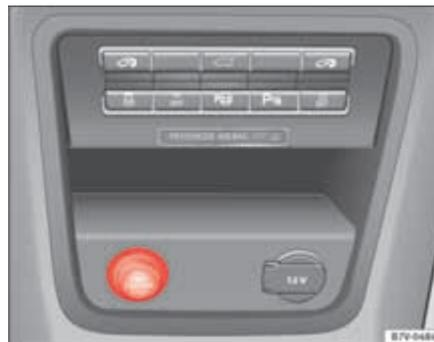
**Fig. 135** Détail de la console centrale : système de fermeture de démarrage KESSY : touche de démarrage.
