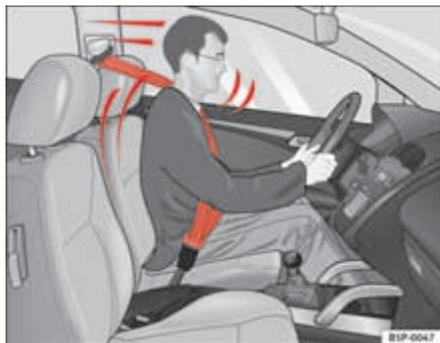
**Fig. 9 Les conducteurs qui ont correctement bouclé leur ceinture de sécurité ne seront pas projetés en cas de coups de frein soudains.**
