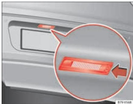
Fig. 223 Sur le pare-chocs arrière : éclairage de la plaque d'immatriculation.
