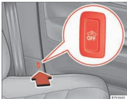
Fig. 51 À côté du siège du conducteur : touche de désactivation de la protection volumétrique et de la protection anti-soulèvement.
