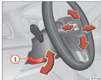
Fig. 133 Réglage mécanique du volant.
