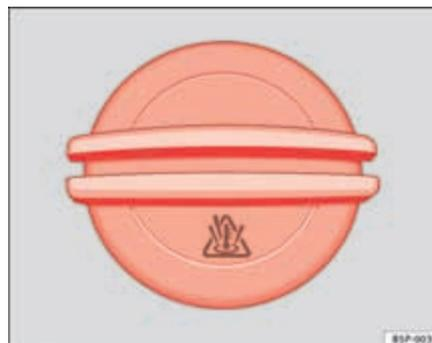
**Fig. 179** Dans le compartiment-moteur : bouchon du vase d'expansion du liquide de refroidissement.
