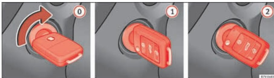
Fig. 134 Positions de la clé du véhicule.
