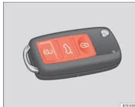
Fig. 46 Touches sur la clé du véhicule.
