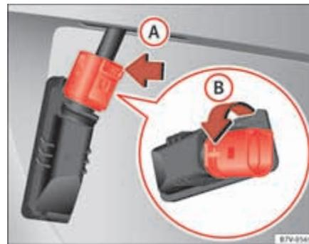
Fig. 224 Feu de plaque d'immatriculation : démonter le porte-ampoule.
