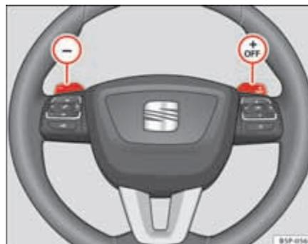
Fig. 142 Volant à deux commandes pour le Tiptronic.
