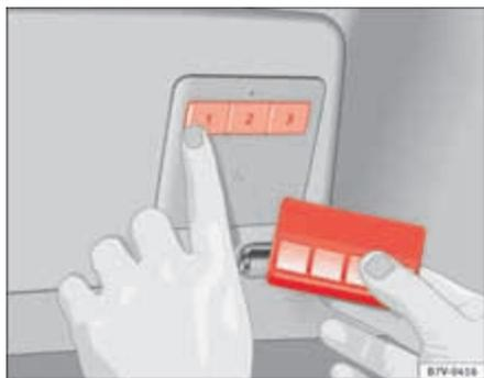
Fig. 65 Pour programmer : Appuyez simultanément sur les touches de la commande de la porte du garage et de la radiocommande.
