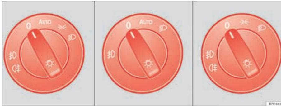
Fig. 67 Côté volant : représentation de certaines variantes de la commande des feux.
