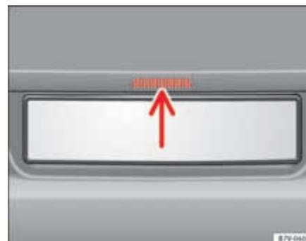
Fig. 57 Ouverture du hayon arrière depuis l'extérieur.
