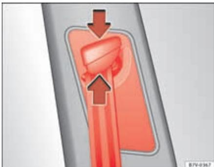
**Fig. 15** Près des sièges avant : dispositif de réglage en hauteur de la ceinture.
