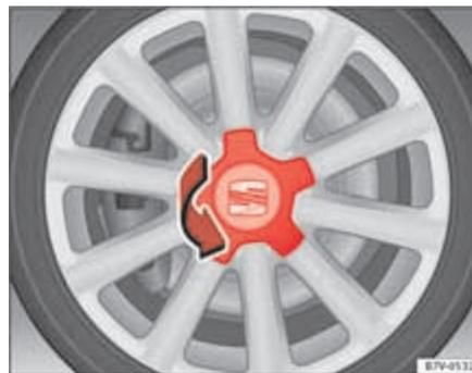
Fig. 187 Démontage des enjoliveurs en les tournant vers l'extérieur.
