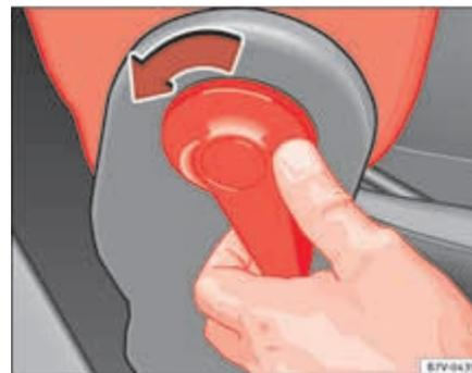
Fig. 89 Débloquer le dossier rabattable du siège du passager avant.
