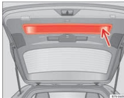
Fig. 58 Hayon arrière ouvert : cavité pour tirer.
