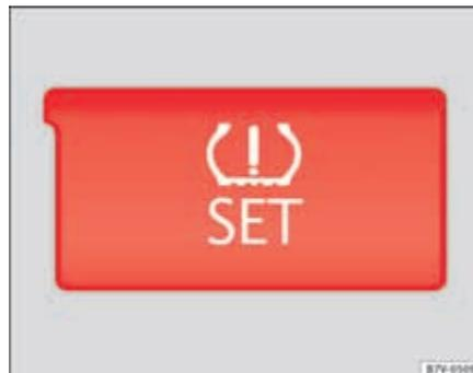
Fig. 161 Détail de la console centrale : touche de l'indicateur de pression des pneus. ▶
