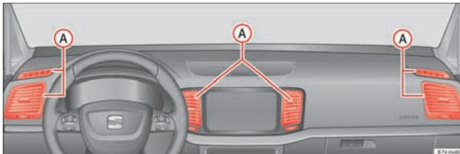
Fig. 131 Diffuseurs d'air sur la planche de bord.
