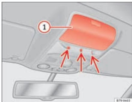
Fig. 52 Sur la console du pavillon : capteurs de protection volumétrique.
