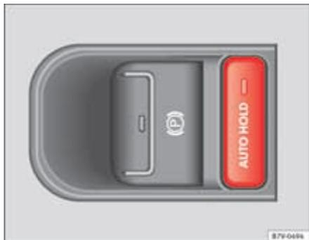
Fig. 146 Détail de la console centrale : touche de l'Auto Hold
