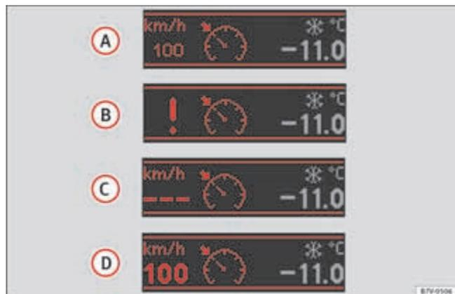
Fig. 158 Afficheur du tableau de bord indications d'état du GRA.
