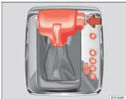
Fig. 140 Véhicules avec volant à droite : levier sélecteur de la BV automatique avec touche de blocage (flèche).
