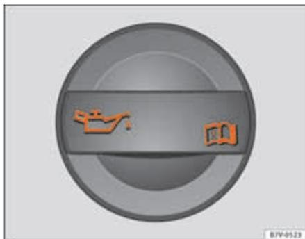
Fig. 176 Dans le compartiment-moteur : Bouchon de la goulotte de remplissage de l'huile moteur.
