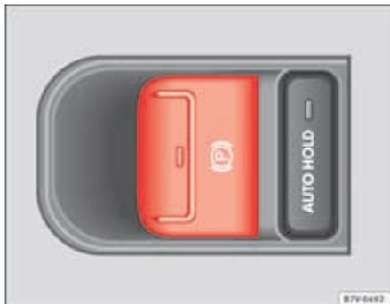
Fig. 143 Détail de la console centrale : contacteur du frein de stationnement électronique.
