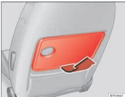
Fig. 118 Tablette escamotable du siège avant.
