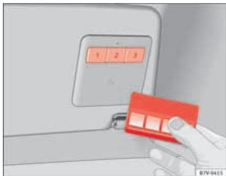
Fig. 64 Radiocommande par radiofréquence et boutons de la commande de la porte du garage sur le store.
