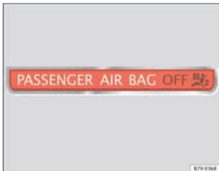
Fig. 16 Témoin de contrôle sur la planche de bord indiquant la désactivation de l'airbag frontal du passager avant.
