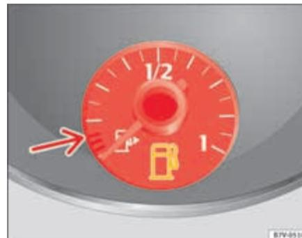
Fig. 169 Sur le tableau de bord : indicateur de niveau de carburant pour essence et diesel. ▶
