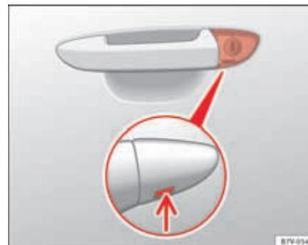
Fig. 197 Poignée de la porte du conducteur : barillet de serrure caché. ►
