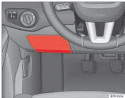
Fig. 209 Sur le tableau de bord côté conducteur : cache du boîtier de fusibles.
