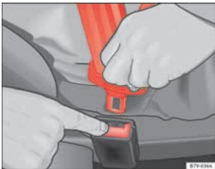
Fig. 11 Retirez le pêne du boîtier de verrouillage.
