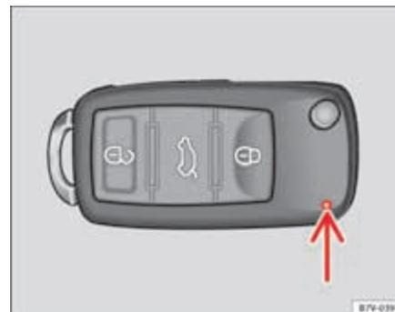
Fig. 42 Témoin de contrôle sur la clé du véhicule.
