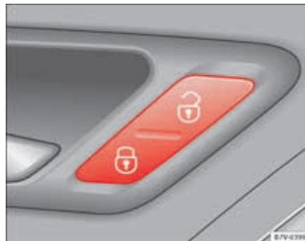
Fig. 48 Sur la porte du conducteur : touche de verrouillage centralisé.
