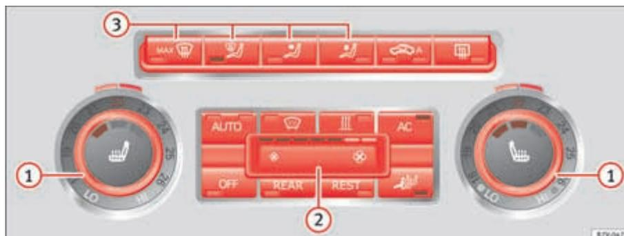
Fig. 130 Détail de la console centrale : Commandes du Climatronic.
