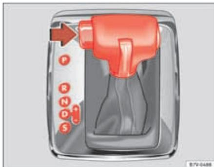
Fig. 139 Véhicules avec direction à gauche : levier sélecteur de la BV automatique avec touche de blocage (flèche).
