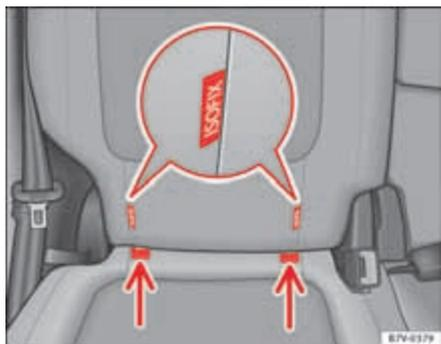
Fig. 28 Version 2 : identification des points d'ancrage du siège pour enfant sur le siège du véhicule.
