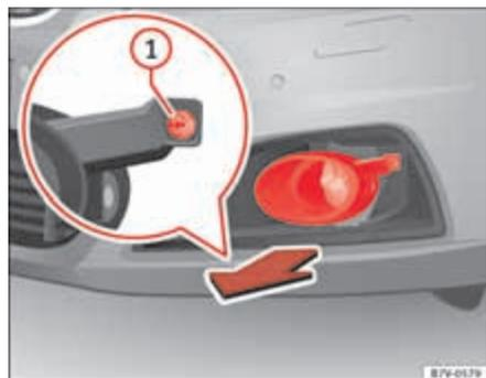
Fig. 217 Sur la partie droite du pare-chocs avant : dépose des projecteurs.
