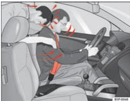
**Fig. 8** Le passager arrière n'ayant pas bouclé sa ceinture est projeté en avant et vient heurter le conducteur qui a bouclé sa ceinture.
