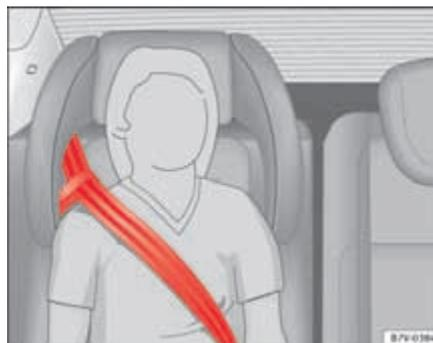
Fig. 33 Siège intégré pour enfants : parcours de la sangle de la ceinture avec poignée de guidage. ►
