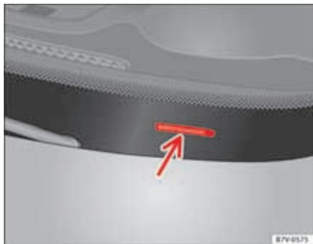
Fig. 230 Numéro d'identification du véhicule
