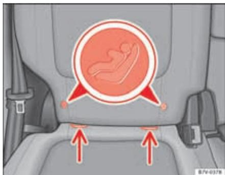
Fig. 27 Version 1 : identification des points d'ancrage du siège pour enfant sur le siège du véhicule.
