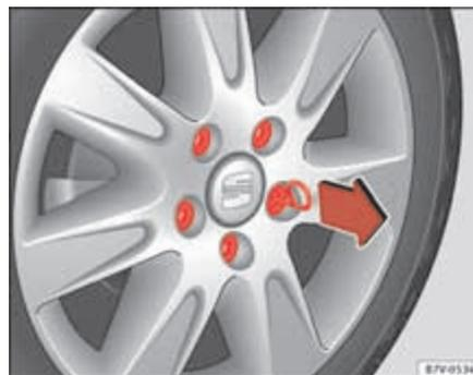
Fig. 189 Retirez les capuchons des boulons de la roue.
