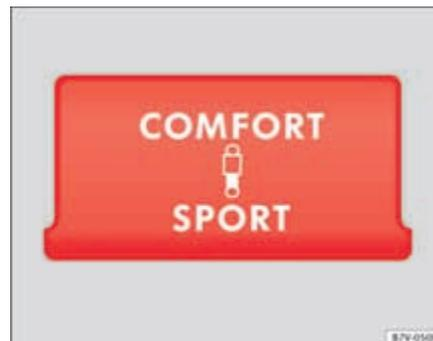
Fig. 160 Détail de la console centrale : touche de réglage de la suspension adaptative.
