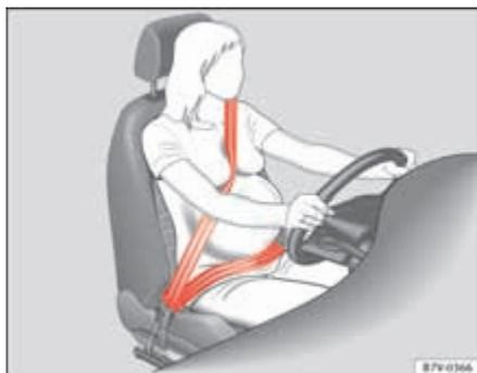
**Fig. 14 Positionnement de la sangle recommandé pour les femmes enceintes.**
