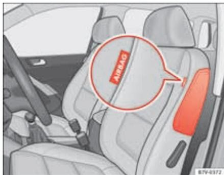
Fig. 20 Sur le côté du siège avant : emplacement de l'airbag latéral.
