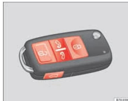
Fig. 47 Touches sur la clé de véhicules à portes coulissantes électriques. ►
