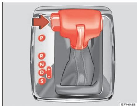
Abb. 139 Linkslenker: Wählhebel des automatischen Getriebes mit Sperrtaste (Pfeil).
