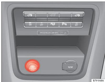
**Abb. 135 Ansicht der Mittelkonsole: Schließ- und Startsystem KESSY: Starterknopf.**
