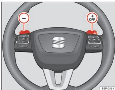
Abb. 142 Lenkrad mit zwei Schaltwippen für die Tiptronic.
