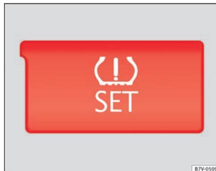
Abb. 161 Ansicht der Mittelkonsole: Taste für die Reifenkontrollanzeige.
