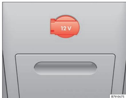
Abb. 126 In der Mittelkonsole hinten: 12-Volt-Steckdose.
