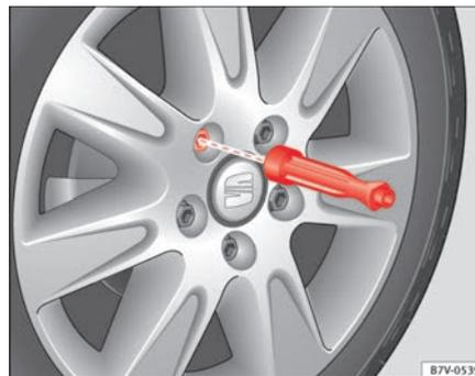
Abb. 194 Radwechsel: Radschrauben mit dem Schraubendrehergriff abschrauben.
