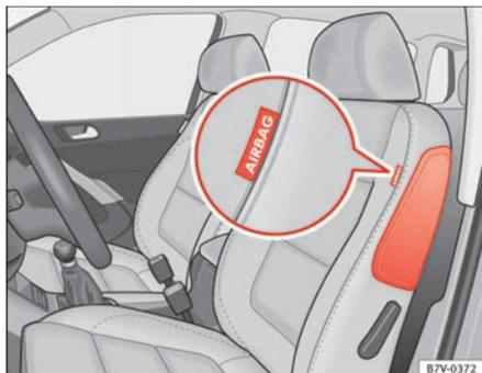
Abb. 20 Seitlich im Vordersitz: Einbauort des Seitenairbags.
