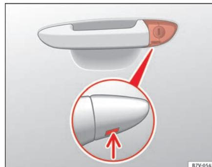
Abb. 197 Türgriff an der Fahrtür: verdeckter Schließzylinder. ▶
