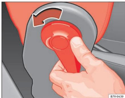
Abb. 89 Klappbare Beifahrersitzlehne entriegeln.
