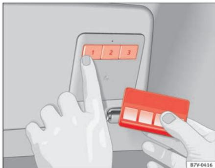
Abb. 65 Zum Programmieren: Taste für den Garagentoröffner und die Funk-Fernbedienung gleichzeitig drücken.
