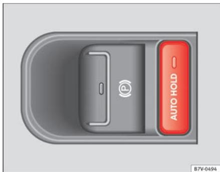
Abb. 146 Ansicht der Mittelkonsole: Taste für Auto Hold.
