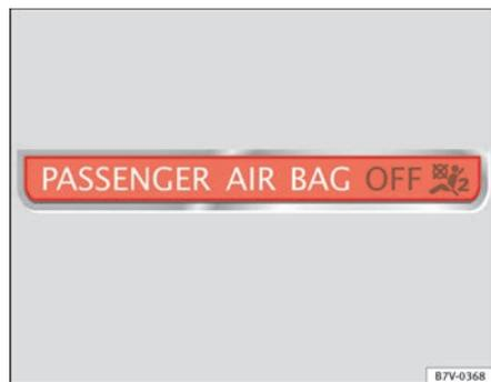
Abb. 16 Kontrollleuchte in der Instrumententafel für abgeschalteten Beifahrer-Frontairbag.
