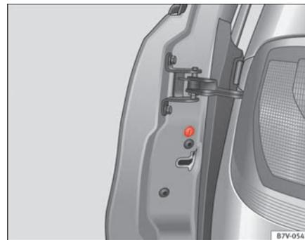
Abb. 198 In der Stirnseite der Beifahrertür: Notverriegelung, durch eine Gummidichtung abgedeckt.
