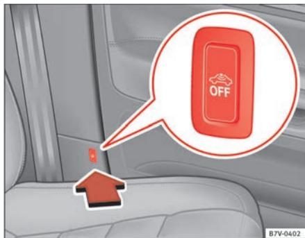
Abb. 51 Neben dem Fahrersitz: Taste zum Ausschalten der Innenraumüberwachung und des Abschleppschutzes.
