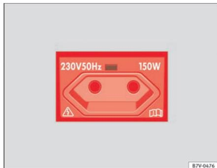
Abb. 127 Mittelkonsole hinten: 230-Volt-Eurosteckdose.
