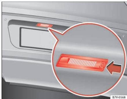
Abb. 223 Im Stoßfänger hinten: Kennzeichenleuchte.
