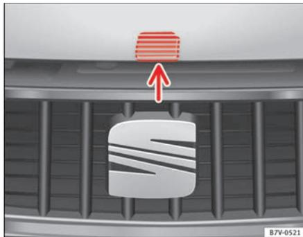
Abb. 174 Entriegelungshebel zum Öffnen der Motorraumklappe im Kühlergrill.
