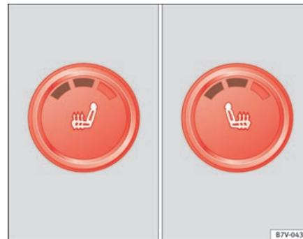
Abb. 85 Ansicht der Mittelkonsole: Regler für die Sitzheizung der Vordersitze, hier bei eingestellter zweiter Heizstufe.
