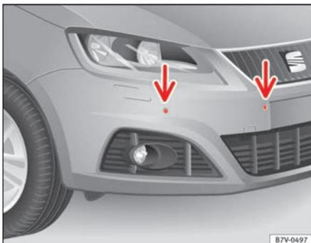
Abb. 149 Sensoren der Parkdistanzkontrolle vorn im Stoßfänger.
