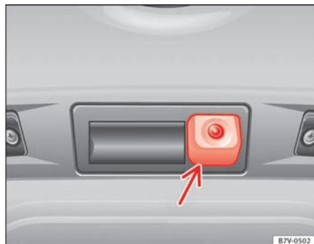
**Abb. 154** In der Heckklappe: Einbauort der Kamera des Rückfahrassistenten.
