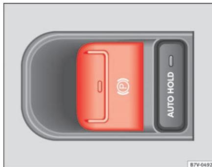
Abb. 143 Ansicht der Mittelkonsole: Taste für die elektronische Parkbremse.
