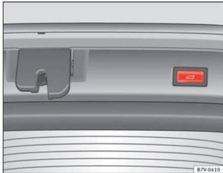
Abb. 59 Taste in der geöffneten Heckklappe.
