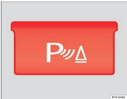
Abb. 148 Ansicht der Mittelkonsole: Taste zum Ein- oder Ausschalten der Parkdistanzkontrolle.
