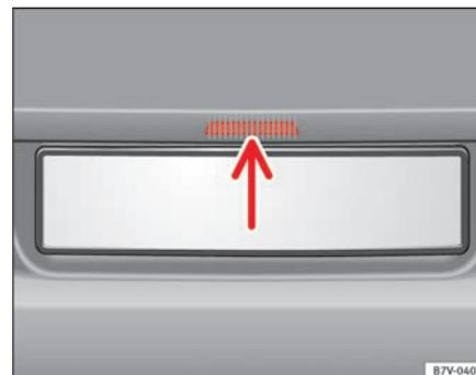
Abb. 57 Heckklappe von außen öffnen.
