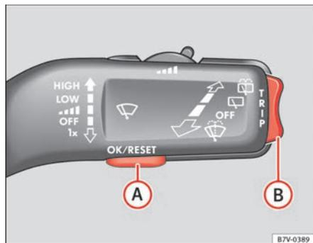
**Abb. 38 Fahrzeuge ohne Multifunktionslenkrad: Im Scheibenwischerhebel:** Taste **A** zum Bestätigen von Menüpunkten und Wippe **B** zum Wechseln der Menüs.
