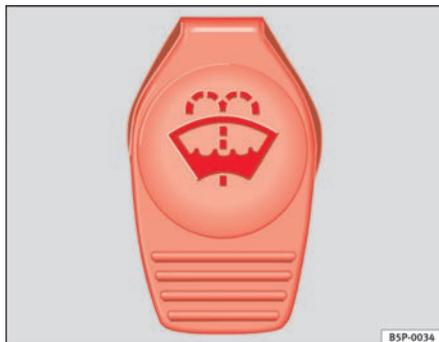
Abb. 77 Im Motorraum: Deckel des Scheibenwaschwasserbehälters.
