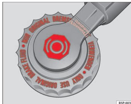
Abb. 145 Im Motorraum: Deckel des Bremsflüssigkeitsbehälters.
