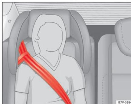
Abb. 33 Integrierter Kindersitz: Gurtbandverlauf mit Gurtführungsschlaufe.
