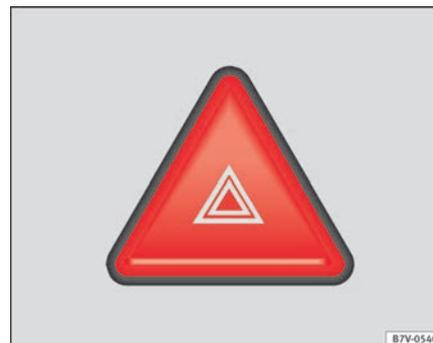
Abb. 195 In der Mitte der Instrumententafel: Schalter für die Warnblinkanlage.
