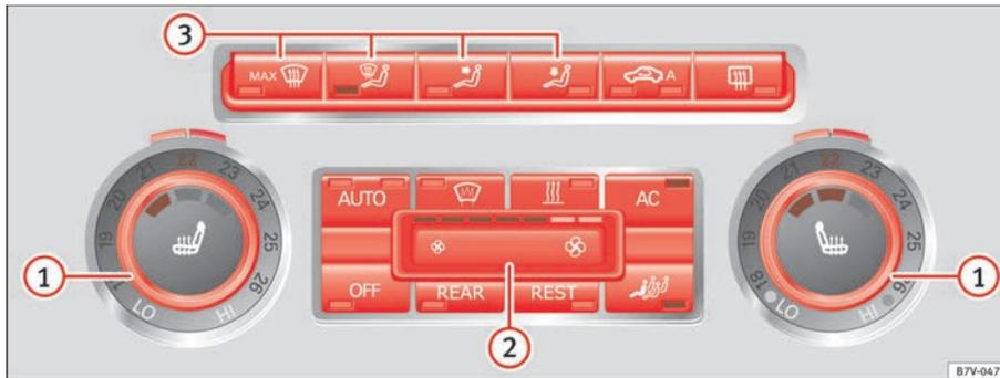
Abb. 130 Ansicht der Mittelkonsole: Bedienungselemente der Climatronic.
