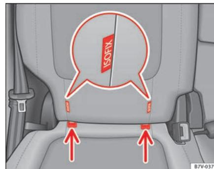
Abb. 28 Variante 2: Kennzeichnung der unteren Kindersitzverankerungspunkte am Fahrzeugsitz.
