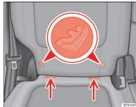
Abb. 27 Variante 1: Kennzeichnung der unteren Kindersitzverankerungspunkte am Fahrzeugsitz.
