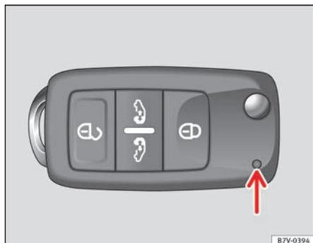
Abb. 42 Kontrollleuchte im Fahrzeugschlüssel bei Fahrzeugen mit elektrischen Schiebetüren.
