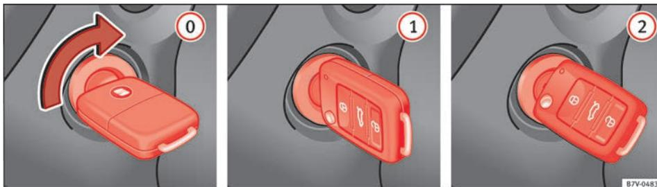
Abb. 127 Positionen des Fahrzeugschlüssels.
