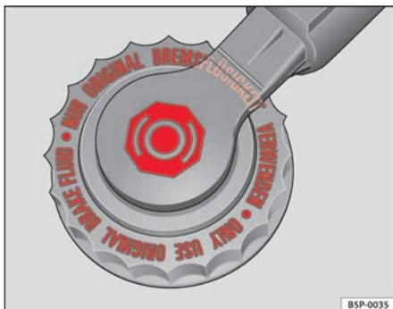
Abb. 137 Im Motorraum: Deckel des Bremsflüssigkeitsbehälters.
