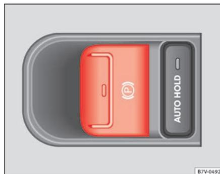
Abb. 135 Ansicht der Mittelkonsole: Taste für die elektronische Parkbremse.
