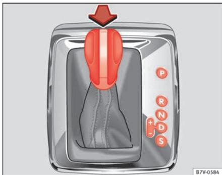
Abb. 132 Rechtslenker: Wählhebel des automatischen Getriebes mit Sperrtaste (Pfeil).
