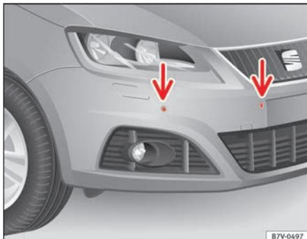
Abb. 141 Sensoren der Parkdistanzkontrolle vorn im Stoßfänger.
