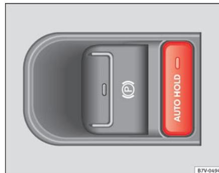
Abb. 138 Ansicht der Mittelkonsole: Taste für Auto Hold.
