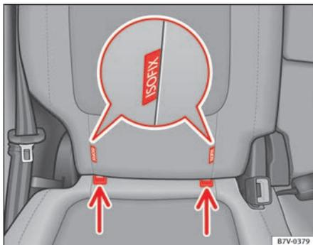
Abb. 27 Variante 2: Kennzeichnung der unteren Kindersitzverankerungspunkte am Fahrzeugsitz.
