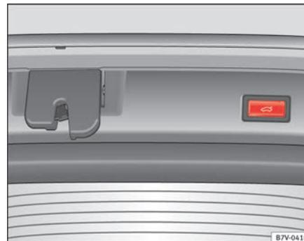
Abb. 56 Taste in der geöffneten Heckklappe.
