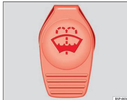
Abb. 71 Im Motorraum: Deckel des Scheibenwaschwasserbehälters.
