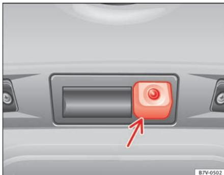
Abb. 146 In der Heckklappe: Einbauort der Kamera des Rückfahrassistenten.
