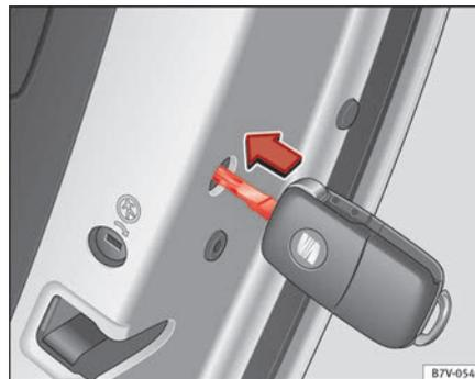
Abb. 190 Notverriegelung des Fahrzeugs mit dem Fahrzeugschlüssel.
