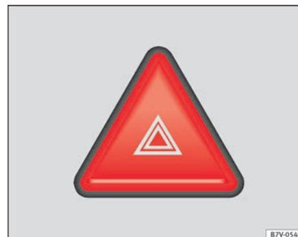
Abb. 186 In der Mitte der Instrumententafel: Schalter für die Warnblinkanlage.
