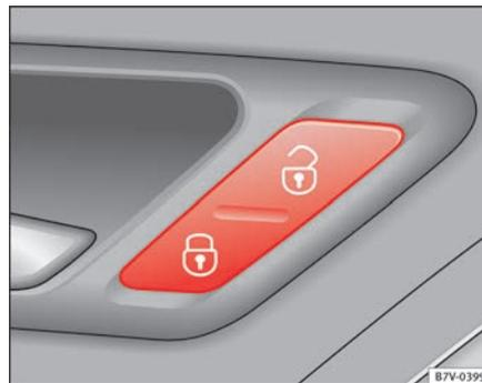
**Abb. 47** In der Fahrertür: Zentralverriegelungstaste.
