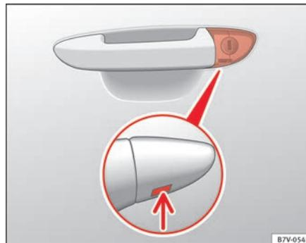
Abb. 188 Türgriff an der Fahrertür: verdeckter Schließzylinder.
