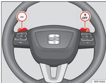
Abb. 134 Lenkrad mit zwei Schaltwippen für die Tiptronic.
