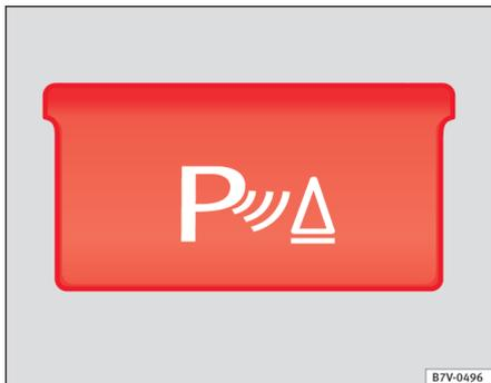
Abb. 140 Ansicht der Mittelkonsole: Taste zum Ein- oder Ausschalten der Parkdistanzkontrolle.
