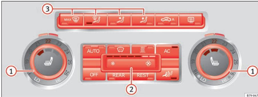
Abb. 122 Ansicht der Mittelkonsole: Bedienungselemente der Climatronic.
