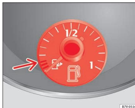
Abb. 162 Im Kombiinstrument: Kraftstoffvorratsanzeige für Benzin- und Dieselmotor.
