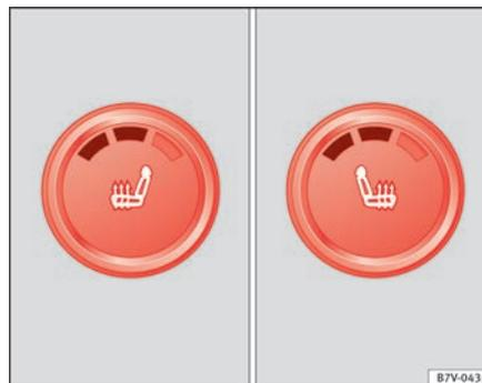
Abb. 79 Ansicht der Mittelkonsole: Regler für die Sitzheizung der Vordersitze, hier bei eingestellter zweiter Heizstufe.
