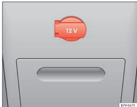
Abb. 119 In der Mittelkonsole hinten: 12-Volt-Steckdose.
