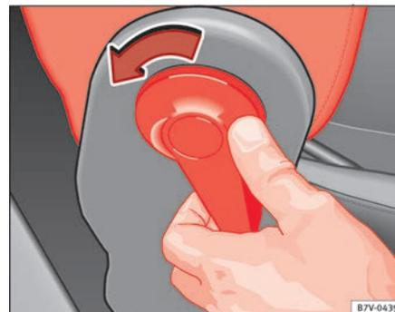
Abb. 83 Klappbare Beifahrersitzlehne entriegeln.
