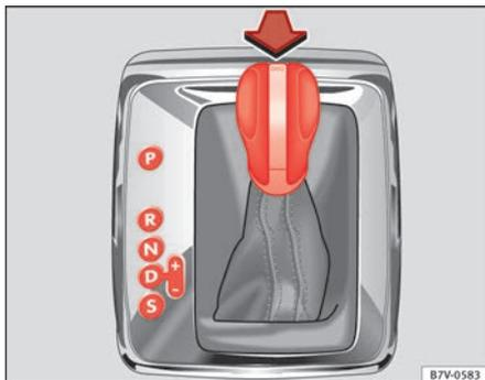
Abb. 131 Linkslenker: Wählhebel des automatischen Getriebes mit Sperrtaste (Pfeil).
