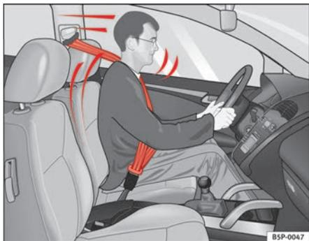
**Abb. 9** Angegurteter Fahrer, der bei einem plötzlichen Bremsmanöver vom richtig angelegten Sicherheitsgurt aufgefangen wird.
