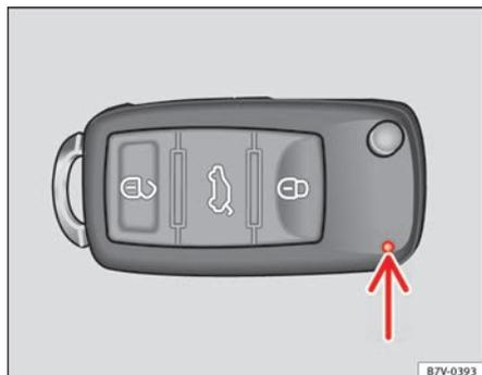
Abb. 41 Kontrollleuchte im Fahrzeugschlüssel.
