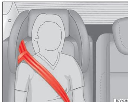
Abb. 32 Integrierter Kindersitz: Gurtbandverlauf mit Gurtführungsschleufe.
