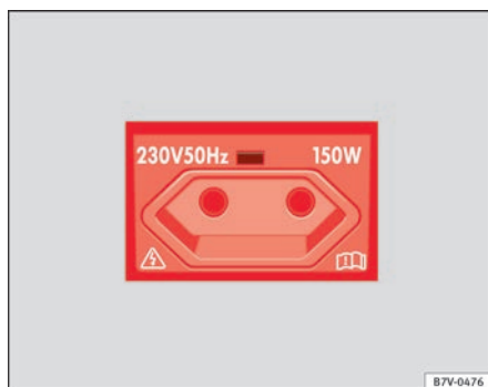
Fig. 120 Rear centre console: 230 Volt Euro socket.
