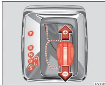
Fig. 134 Levier sélecteur sur la position Tiptronic (véhicules avec volant à gauche). Les véhicules avec le volant à droite sont disposés de manière symétrique.
