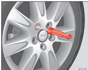
Fig. 187 Changement de roue : desserrer les boulons de la roue avec le manche du tournevis.
