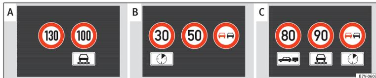
Fig. 154 Afficheur du tableau de bord exemples de limitations de vitesse ou d'interdictions de dépasser détectées avec les panneaux supplémentaires correspondants.
