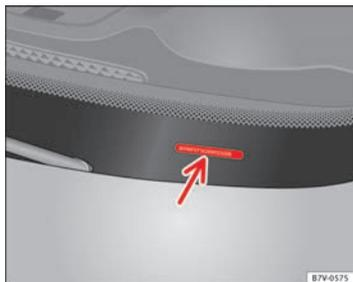
Fig. 222 Numéro d'identification du véhicule
