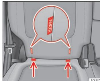
Fig. 27 Version 2 : identification des points d'ancrage du siège pour enfant sur le siège du véhicule.
