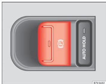
Fig. 136 Détail de la console centrale : contacteur du frein de stationnement électronique.
