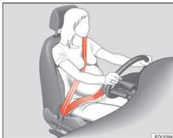
Fig. 14 Positionnement de la sangle recommandé pour les femmes enceintes.
