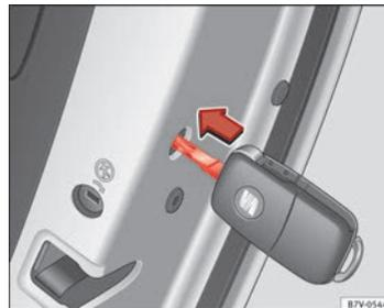
**Fig. 192** Verrouillage de secours du véhicule avec la clé de celui-ci.
