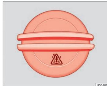
Fig. 174 Dans le compartiment moteur : bouchon du vase d'expansion du liquide de refroidissement.
