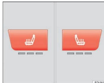
Fig. 79 Détail de la console centrale : commandes de chauffage des sièges avant sur les véhicules équipés de Climatic.
