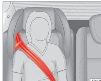
**Fig. 32** Siège intégré pour enfants : parcours de la sangle de la ceinture avec poignée de guidage.
