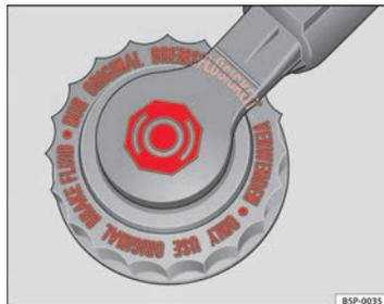
Fig. 138 Dans le compartiment moteur : bouchon du réservoir du liquide de frein
