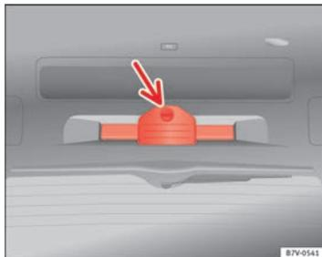
Fig. 189 Dans le hayon arrière : support du triangle de signalisation.
