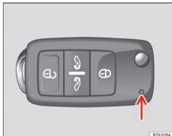
Fig. 42 Témoin de contrôle sur la clé du véhicule pour les véhicules à portes coulissantes électriques.
