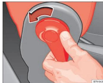
Fig. 83 Débloquent le dossier rabattable du siège du passager avant.
