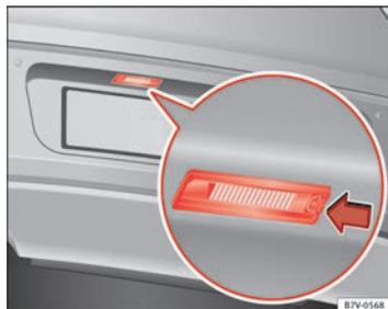
Fig. 215 Sur le pare-chocs arrière : éclairage de la plaque d'immatriculation.
