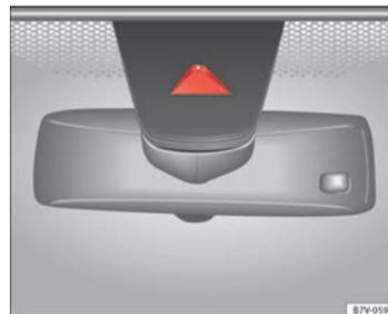
Fig. 153 Sur le pare-brise : Fenêtre de la caméra de l'assistant de maintien de voie.
