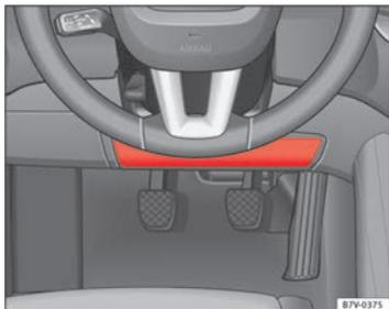
Fig. 24 Côté conducteur : emplacement de l'airbag de genoux.
