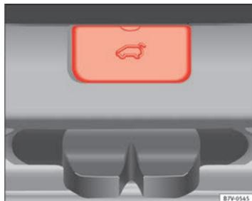
Fig. 193 Dans le coffre à bagages : démontage du cache du hayon.
