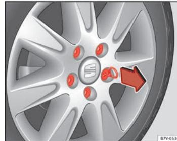
Fig. 182 Retirez les capuchons des boulons de la roue.
