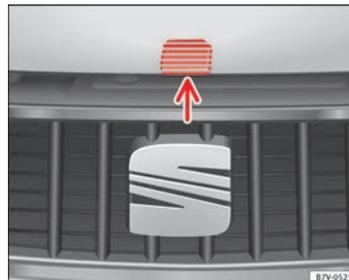
Fig. 169 Levier de déverrouillage pour l'ouverture du capot moteur au niveau de la grille du radiateur.
