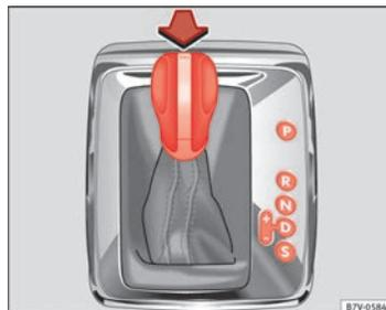
Fig. 133 Véhicules avec volant à droite : levier sélecteur de la BV automatique avec touche de blocage (flèche).
