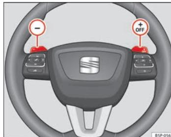
Fig. 135 Volant à deux commandes pour le Tiptronic.
