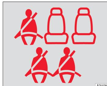
Fig. 4 Exemple d'indication de l'état de la ceinture pour les places arrière (dans le cas présent, véhicule à 7 places) sur le tableau de bord, en haut, deuxième rangée ; en bas, troisième rangée de sièges.
