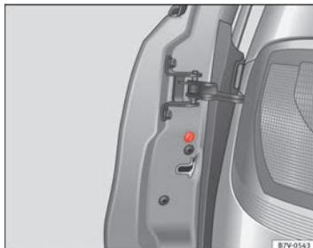
**Fig. 191** Sur la face avant de la porte du passager : verrouillage de secours, caché par un joint en caoutchouc.
