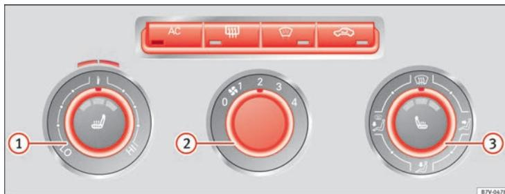
Fig. 122 Détail de la console centrale : commandes du Climatic.
