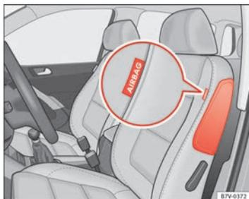
Fig. 20 Sur le côté du siège avant : emplacement de l'airbag latéral.
