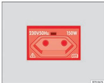
Fig. 121 Détail de la console centrale arrière : prise de courant européenne de 230 volts.
