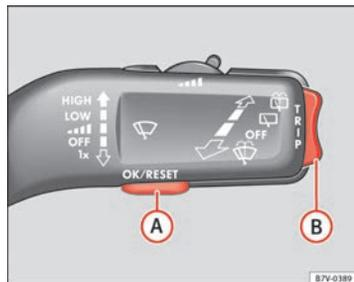
Fig. 37 Sur des véhicules sans volant multifonction : sur le levier des essuie-glaces : touche (A) pour confirmer les options du menu et la commande à bascule (B) pour changer de menu.
