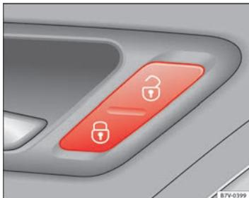
Fig. 47 Sur la porte du conducteur : touche de verrouillage centralisé.
