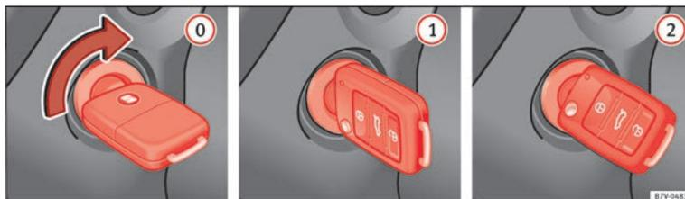
Fig. 128 Positions de la clé du véhicule.
