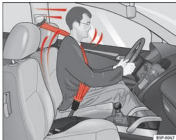
**Fig. 9 Les conducteurs qui ont correctement bouclé leur ceinture de sécurité ne seront pas projetés en cas de coups de frein soudains.**
