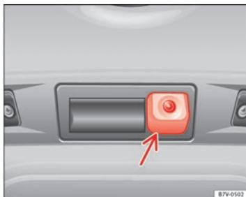
Fig. 147 Dans le hayon arrière : emplacement de la caméra de l'assistant de marche arrière.
