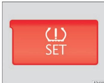
Fig. 156 Détail de la console centrale : touche de l'indicateur de pression des pneus.
