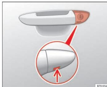
Fig. 190 Poignée de la porte du conducteur : barillet de serrure caché.
