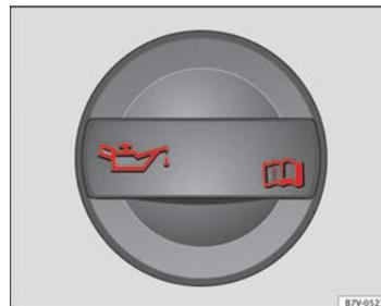
Fig. 171 Dans le compartiment moteur : bouchon de la goulotte de remplissage de l'huile moteur. ▶
