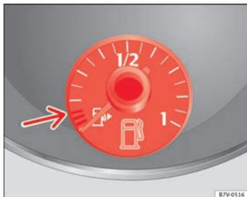
Fig. 164 Sur le tableau de bord : indicateur de niveau de carburant pour essence et diesel.
