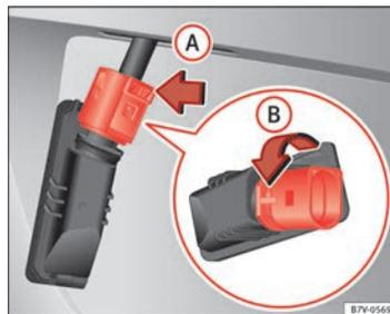
Fig. 216 Feu de plaque d'immatriculation : démonter le porte-ampoule.
