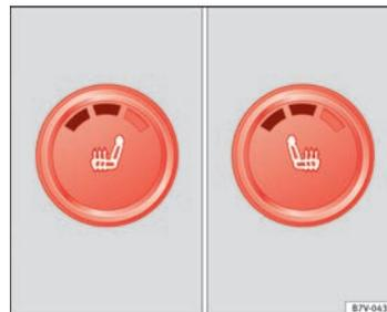
Fig. 78 Détail de la console centrale : commandes pour le chauffage des sièges avant, dans notre cas avec le second niveau de température activé.
