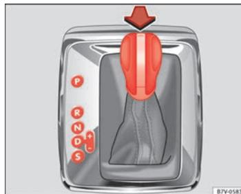
Fig. 132 Véhicules avec direction à gauche : levier sélecteur de la BV automatique avec touche de blocage (flèche).
