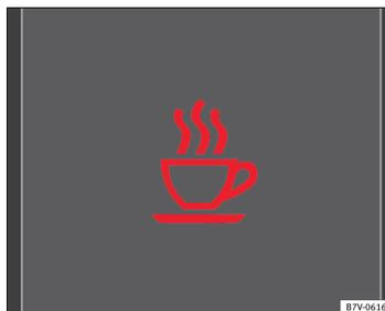
Fig. 155 Sur l'écran du tableau de bord : symbole de détection de la fatigue.
