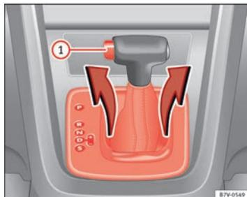
Fig. 197 Démonter le revêtement du champ d'indication des vitesses.
