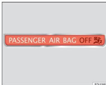
Fig. 16 Témoin de contrôle sur la planche de bord indiquant la désactivation de l'airbag frontal du passager avant.
