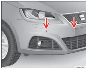
Fig. 142 Capteurs du système d'aide au stationnement dans le pare-chocs avant.
