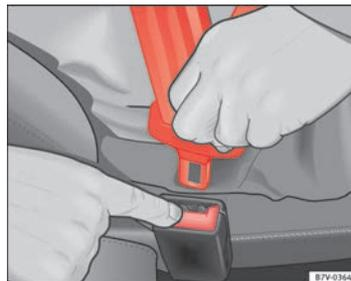
Fig. 11 Retirez le pêne du boîtier de verrouillage.
