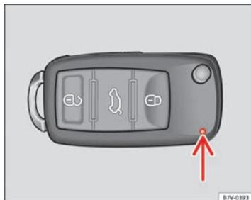
Fig. 41 Témoin de contrôle sur la clé du véhicule.
