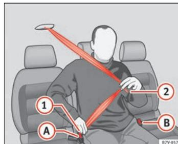
Fig. 12 Boucler la ceinture du siège central dans la seconde rangée.
