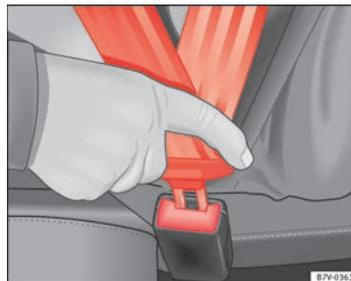
Fig. 10 Insérez le pêne de la ceinture de sécurité dans le boîtier de verrouillage.
