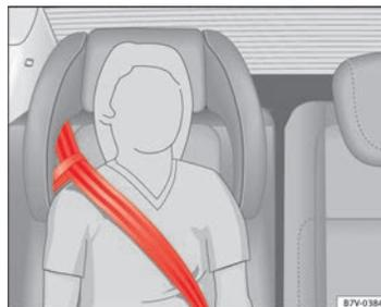
**Fig. 32** Asiento integrado para niños: recorrido de la banda del cinturón con asa-guía.
