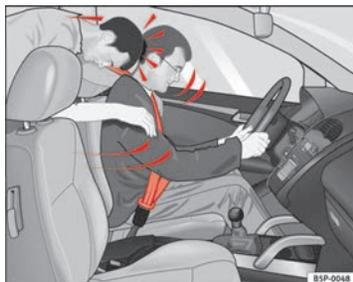
**Fig. 8 El ocupante del asiento trasero que no lleve puesto el cinturón de seguridad se verá lanzado hacia adelante, sobre el conductor que sí lleva el cinturón.**
