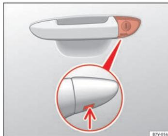
Fig. 190 Maneta de la puerta del conductor: Bombín de cierre oculto.
