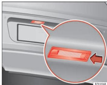
Fig. 215 En el parachoques trasero: iluminación de la matrícula.
