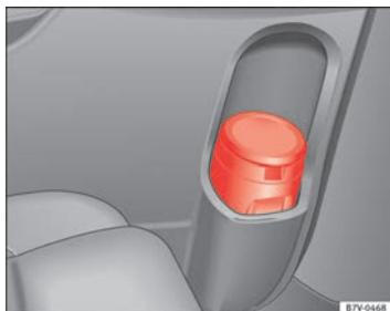
Fig. 113 Papelera portátil en el revestimiento de la puerta corrediza izquierda.
