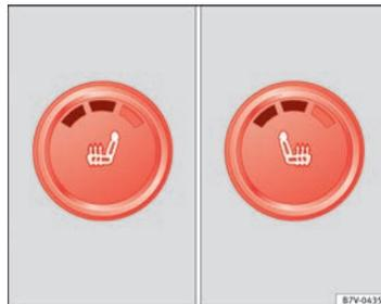
Fig. 78 Detalle de la consola central: mandos para la calefacción de los asientos delanteros, aquí con el segundo nivel de temperatura ajustado.
