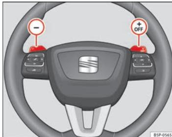
Fig. 135 Volante con dos levas para el Tiptronic.
