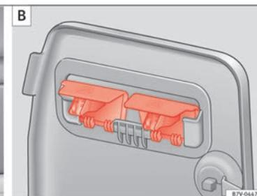
Fig. 92 Retire los soportes de la bandeja (B) y guárdela de forma segura (C).
