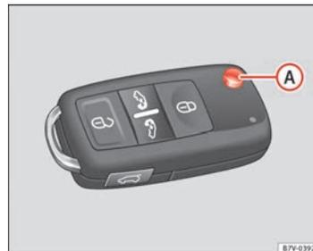
Fig. 40 Llave del vehículo para vehículos con puertas corredizas eléctricas.
