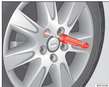
**Fig. 187 Cambio de rueda:** aflojar los tornillos de la rueda con el mango del destornillador.
