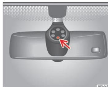
Fig. 69 Superficie sensible del sensor de lluvia.
