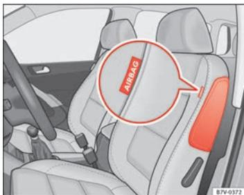
Fig. 20 En el lateral del asiento delantero: ubicación del airbag lateral.
