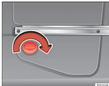
Fig. 166 En la parte trasera izquierda del maletero: depósito de AdBlue, detrás de una cubierta.
