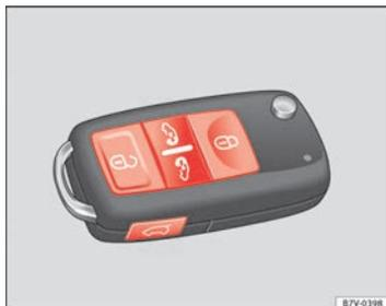
Fig. 46 Teclas en la llave de vehículos con puertas corredizas eléctricas.
