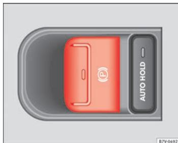
Fig. 136 Detalle de la consola central: conmutador del freno de estacionamiento electrónico. ▶
