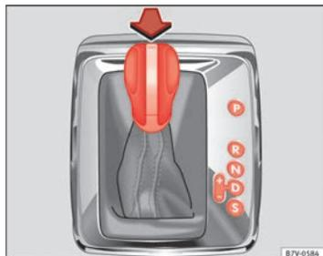
Fig. 133 Vehículos con volante a la derecha: Palanca selectora del cambio automático con tecla de bloqueo (flecha).
