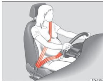
Fig. 14 Correcta colocación de la banda del cinturón en el caso de mujeres embarazadas.
