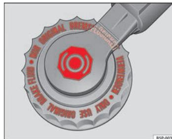
Fig. 138 En el vano motor: tapón del depósito del líquido de frenos
