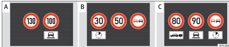
Fig. 154. Pantalla del cuadro de instrumentos: ejemplos de límites de velocidad o prohibiciones de adelantamiento detectados junto con las correspondientes señales adicionales.
