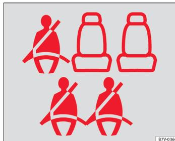
Fig. 4 Ejemplo de indicación del estado del cinturón en las plazas traseras (aquí, en un vehículo de 7 plazas) en el cuadro de instrumentos: arriba, la segunda hilera de asientos; abajo, la tercera hilera de asientos.
