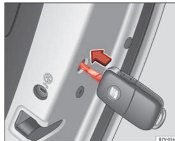
**Fig. 192** Bloqueo de emergencia del vehículo con la llave del vehículo.
