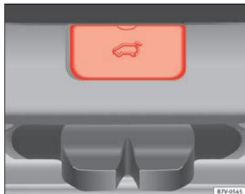
Fig. 193 Desde el maletero: Desmontaje de la tapa del portón trasero.
