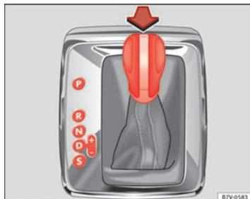
Fig. 132 Vehículos con volante a la izquierda: Palanca selectora del cambio automático con tecla de bloqueo (flecha).
