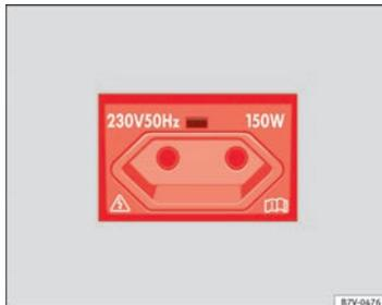
Fig. 121 Detalle de la consola central trasera: Toma de corriente europea de 230 voltios.
