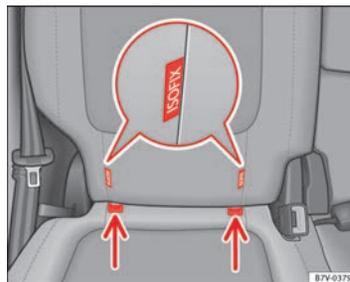
Fig. 27 Versión 2: identificación de los puntos de anclaje para el asiento para niños en el asiento del vehículo.
