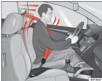
**Fig. 9 Los conductores que lleven el cinturón de seguridad correctamente abrochado no saldrán despedidos en caso de frenazos repentinos.**
