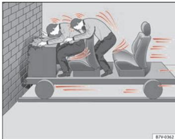
**Fig. 6 Un vehículo colisiona contra un muro con los ocupantes sin abrochar el cinturón.**
