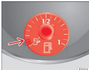
Fig. 164 En el cuadro de instrumentos: indicador del nivel de combustible para gasolina y diésel.
