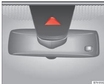
Fig. 153 En el parabrisas: Área de campo visual de la cámara del sistema de aviso de salida del carril.
