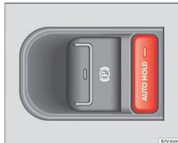
Fig. 139 Detalle de la consola central: tecla del Auto Hold.
