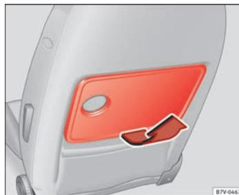
Fig. 112 Mesita plegable en el asiento delantero.
