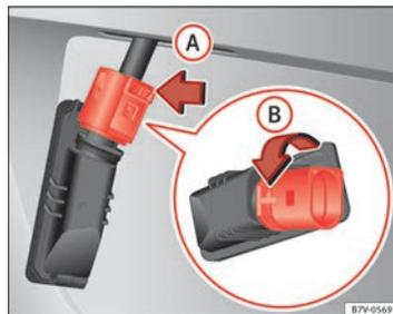
Fig. 216 Luz de la matrícula: Desmontar el portalámparas.
