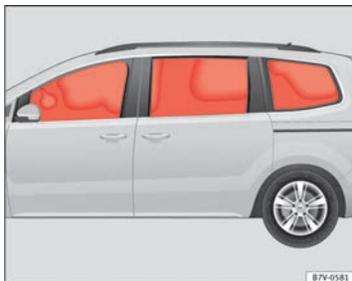
Fig. 23 Airbags para la cabeza inflados
