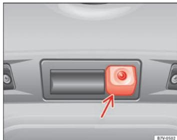
Fig. 147 En el portón trasero: ubicación de la cámara del asistente de marcha atrás.
