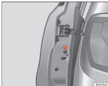
**Fig. 191** En la parte frontal de la puerta del acompañante: Bloqueo de emergencia, oculto por una junta de goma.
