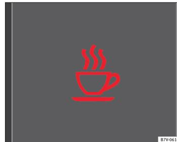
Fig. 155 En la pantalla del cuadro de instrumentos: símbolo de detección del cansancio.
