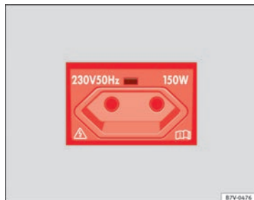
Fig. 121 Rear centre console: 230 Volt Euro power socket
