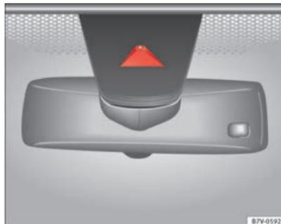
Abb. 154 An der Frontscheibe: Kamerasichtfenster des Spurhalteassistenten.
