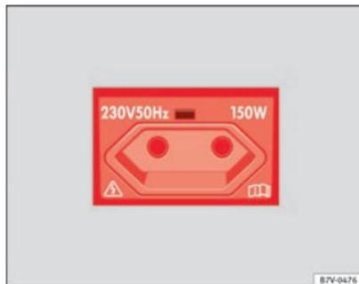
Abb. 122 Mittelkonsole hinten: 230-Volt-Eurosteckdose.
