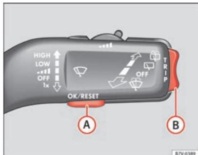
Abb. 37 Fahrzeuge ohne Multifunktionslenkrad: Taste (A) im Scheibenwischerhebel zum Bestätigen von Menüpunkten und Wippe (B) zum Wechseln der Menüs.
