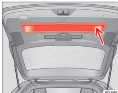
Abb. 55 Offene Heckklappe: Griffmulde zum Zuziehen
