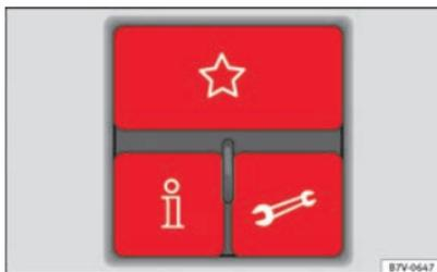
Abb. 39 Drei-Tasten-Modul im Himmel: Bedienelemente des Telefonsteuerungssystems.
