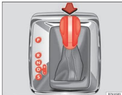
Abb. 133 Linkslenker: Wählhebel des automatischen Getriebes mit Sperrtaste (Pfeil).
