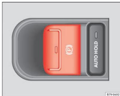
Abb. 137 Ansicht der Mittelkonsole: Taste für die elektronische Parkbremse.
