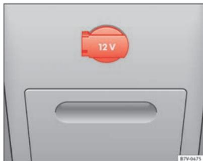
Abb. 121 In der Mittelkonsole hinten: 12-Volt-Steckdose.
