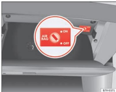
Abb. 19 Im Handschuhfach, auf der Beifahrerseite: Schlüsselschalter zum Ab- und Einschalten des Beifahrer-Frontairbags.
