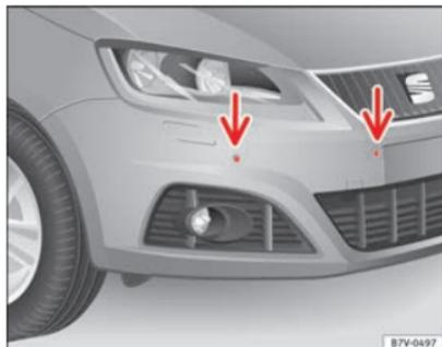
Abb. 143 Sensoren der Parkdistanzkontrolle vorn im Stoßfänger.
