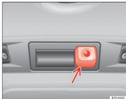
Abb. 148 In der Heckklappe: Einbauort der Kamera des Rückfahrassistenten.
