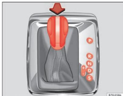
Abb. 134 Rechtslenker: Wählhebel des automatischen Getriebes mit Sperrtaste (Pfeil).
