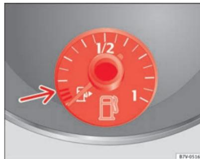
Abb. 165 Im Kombiinstrument: Kraftstoffvorratsanzeige für Benzin- und Dieseldieselkraftstoff. ▶
