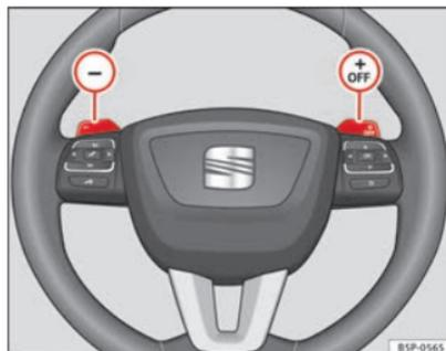
Abb. 136 Lenkrad mit zwei Schaltwippen für die Tiptronic.
