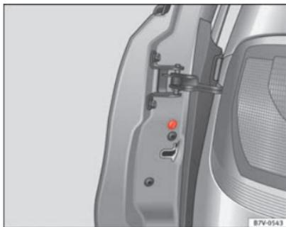
Abb. 192 In der Stirnseite der Beifahrertür: Notverriegelung, durch eine Gummidichtung abgedeckt.
