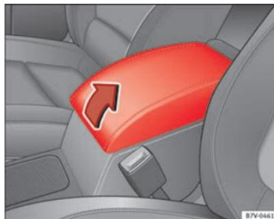
Abb. 107 Ablagefach in der Mittelarmlehne vorn.
