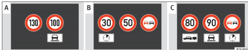
Abb. 155 Im Display des Kombiinstrument: Beispiel für erkannte Geschwindigkeitsbegrenzungen bzw. Überholverbote und der entsprechenden Zusatzbeschilderung.
