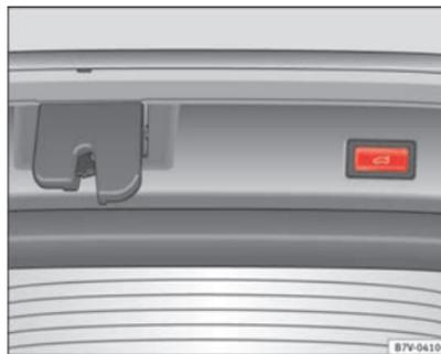
Abb. 56 Taste in der geöffneten Heckklappe.
