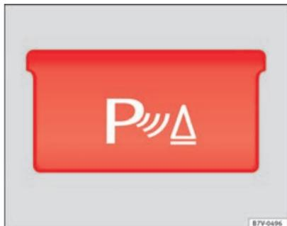
Abb. 142 Ansicht der Mittelkonsole: Taste zum Ein- oder Ausschalten der Parkdistanzkontrolle.
