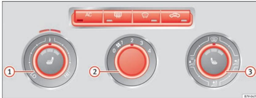
Abb. 123 Ansicht der Mittelkonsole: Bedienelemente der manuellen, elektrischen Klimaanlage
