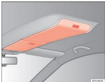
Abb. 104 In der Dachkonsole: Ablagefach.
