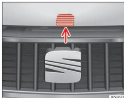
Abb. 170 Entriegelungshebel zum Öffnen der Motorraumklappe im Kühlergrill.
