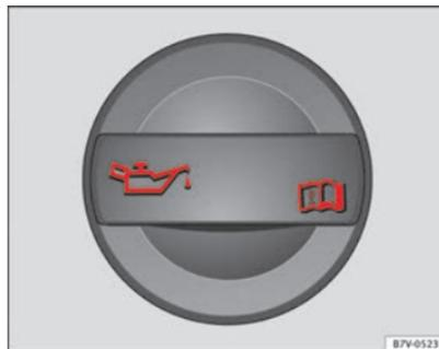
Abb. 172 Im Motorraum: Deckel der Motoröleinfüllöffnung.
