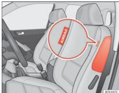
Abb. 20 Im Seitenteil des Vordersitzes: Einbauort des Seitenairbags.
