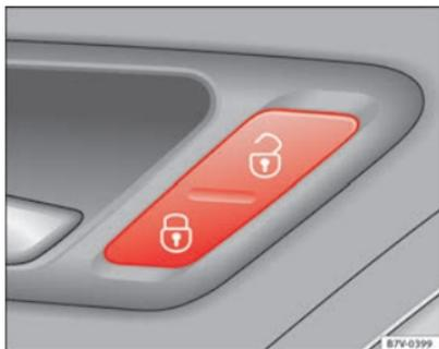
Abb. 48 An der Fahrertür: Zentralverriegelungstaste.
