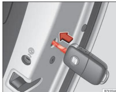
Abb. 193 Notverriegelung des Fahrzeugs mit dem Fahrzeugschlüssel.
