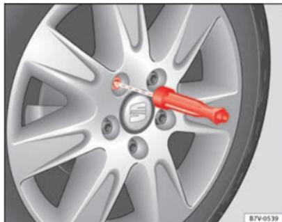
**Abb. 188 Radwechsel:** Radschrauben mit dem Schraubendrehergriff abschrauben.
