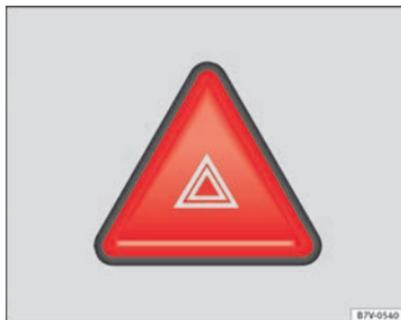
Abb. 189 In der Mitte der Instrumententafel: Schalter für die Warnblinkanlage.
