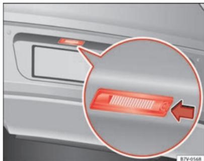
Abb. 216 Im Stoßfänger hinten: Kennzeichenleuchte.
