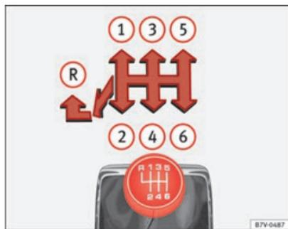
Abb. 132 Schaltschema des 6-Gang-Schaltgetriebes.
