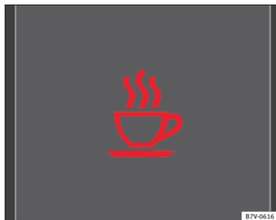
Abb. 156 Im Display des Kombiinstruments: Symbol der Müdigkeitserkennung.
