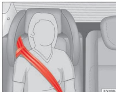
Abb. 32 Integrierter Kindersitz: Gurtbandverlauf mit Gurtführungsschleufe.
