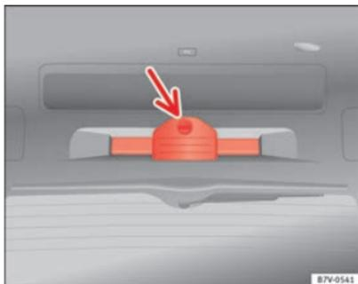
Abb. 190 In der Heckklappe: Halterung für das Warndreieck.
