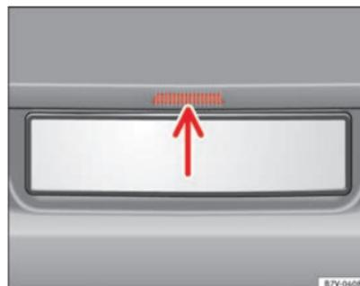
Abb. 54 Heckklappe von außen öffnen.
