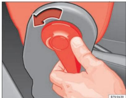
Abb. 84 Klappbare Beifahrersitzlehne entriegeln.
