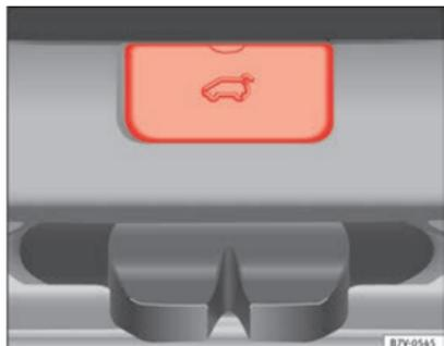
Abb. 194 Vom Gepäckraum aus: Abdeckkappe in der Heckklappe abnehmen.
