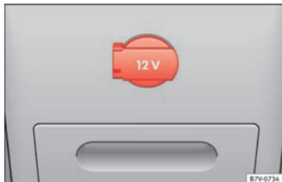
**Fig. 193** Parte posterior da consola central: tomada de corrente de 12 Volts.
