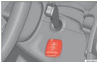
**Fig. 200** Arranque de emergência em veículos com Keyless Access.
