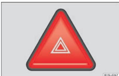
**Fig. 42** Painel de instrumentos: interruptor das luzes de emergência.
