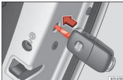
Fig. 5 Trancagem de emergência do veículo com a chave do veículo.
