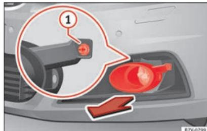
**Fig. 109** Na parte direita do para-choques dianteiro: desmontagem dos faróis.
