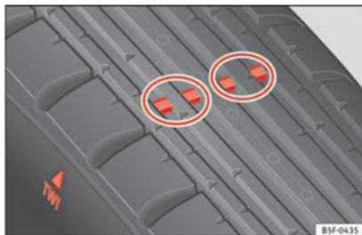
Fig. 252 Perfil do pneu: indicadores de desgaste.
