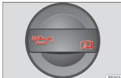
**Fig. 55** Tampão do bocal de enchimento do óleo do motor no compartimento do motor.
