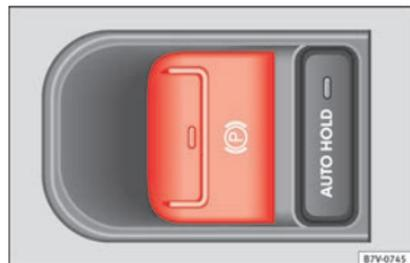
**Fig. 201** Pormenor da consola central: comutador do travão de estacionamento eletrónico.
