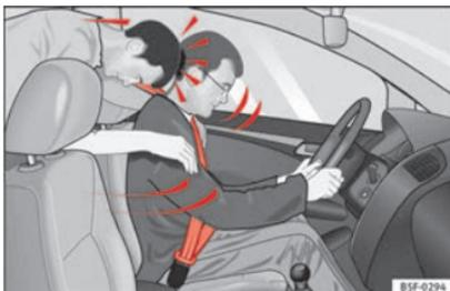
**Fig. 86** O ocupante do banco traseiro que não tiver o cinto de segurança colocado será projetado para a frente, para cima do condutor que tem o cinto colocado.
