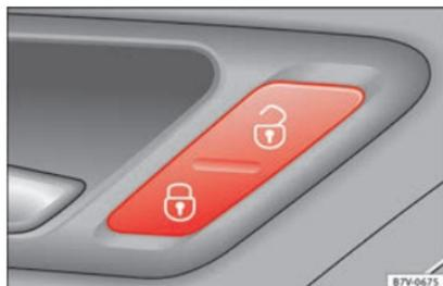
**Fig. 130** Na porta do condutor: botão do fecho centralizado.
