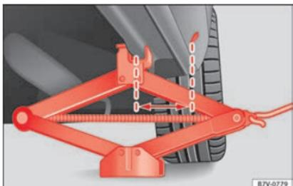
Fig. 70 Macaco colocado na parte traseira esquerda do veículo.
