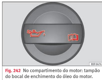
Fig. 242 No compartimento do motor: tampa do bocal de enchimento do óleo do motor.
