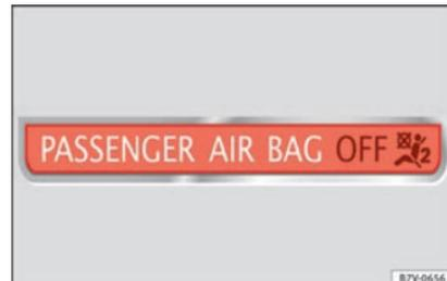
**Fig. 91** Luz de controlo, no painel de instrumentos, da desativação do airbag dianteiro do passageiro.
