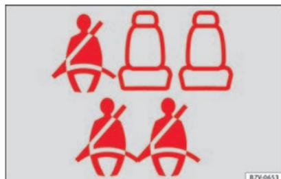
Fig. 83 Exemplo de indicação do estado do cinto nos lugares traseiros (aqui, num veículo de 7 lugares) no painel de instrumentos: por cima, a segunda fila; por baixo, a terceira fila de bancos.
