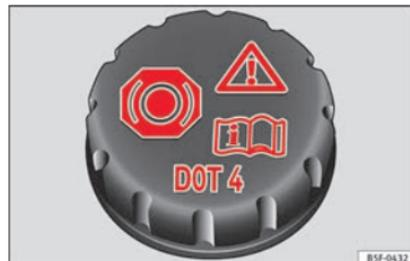
**Fig. 246** No compartimento do motor: tampão do depósito do líquido dos travões.
