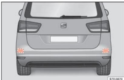
**Fig. 221** Vista traseira do veículo: zonas dos sensores de radar.
