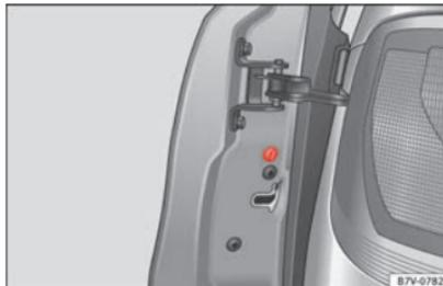
Fig. 4 Na parte frontal da porta deslizante: trancagem de emergência, oculta por uma junta de borracha.
