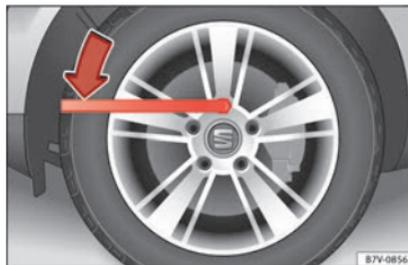
Fig. 67 Substituição de roda: alivie os parafusos da roda.
