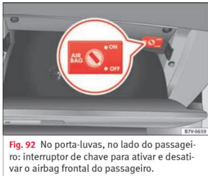
**Fig. 92** No porta-luvas, no lado do passageiro: interruptor de chave para ativar e desativar o airbag frontal do passageiro.
