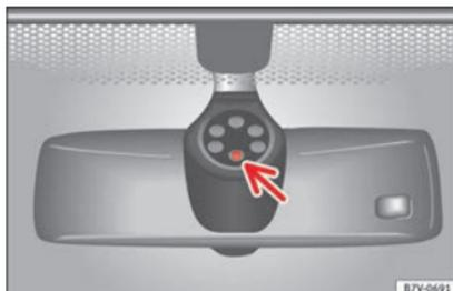
Fig. 145 Superfície sensível do sensor de chuva.
