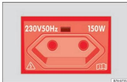
**Fig. 194** Pormenor da consola central traseira: tomada de corrente europeia de 230 Volts.
