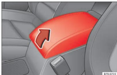
**Fig. 179** Compartimento porta-objetos no apoio de braços central dianteiro.
