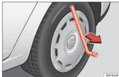
**Fig. 65** Desmontar o tampão integral.
