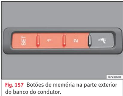
Fig. 157 Botões de memória na parte exterior do banco do condutor.
