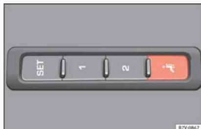
Fig. 156 Na lateral do banco dianteiro: botão para a função de massagem lombar.
