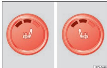
Fig. 154 Pormenor da consola central: comandos para o aquecimento dos bancos dianteiros, aqui com o segundo nível de temperatura ajustado.
