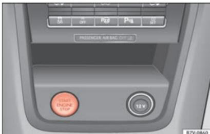
**Fig. 199** Na consola central: botão de arranque do sistema de fecho e arranque sem chave Keyless Access. Nos veículos com direção à direita, a disposição é simétrica.
