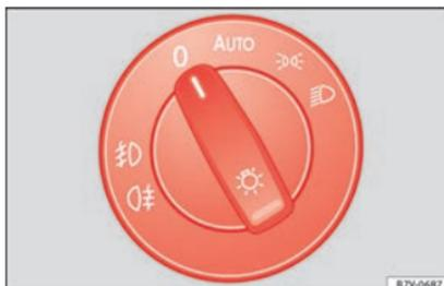
**Fig. 40** Painel de instrumentos: comando das luzes.
