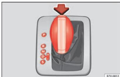
Fig. 202 Alavanca seletora da caixa automática com botão de bloqueio (seta).
