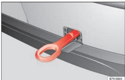
Fig. 73 No para-choques traseiro, no lado direito: argola de reboque enroscada.
