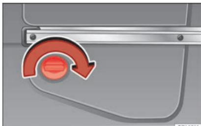
**Fig. 236** Na parte traseira esquerda do porta-bagagens: depósito de AdBlue, atrás de uma cobertura.
