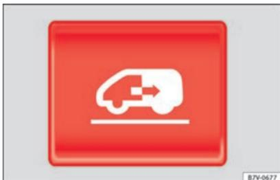
**Fig. 135** No painel de instrumentos, na chave do veículo e no revestimento interior da porta de correr: botão para abrir e fechar uma porta de correr elétrica.
