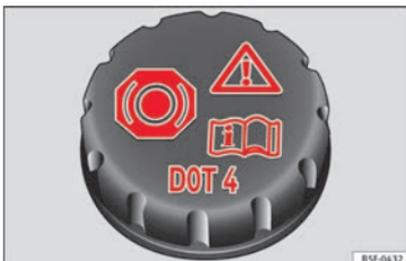
**Fig. 57** Compartimento do motor: tampão do depósito do líquido dos travões.
