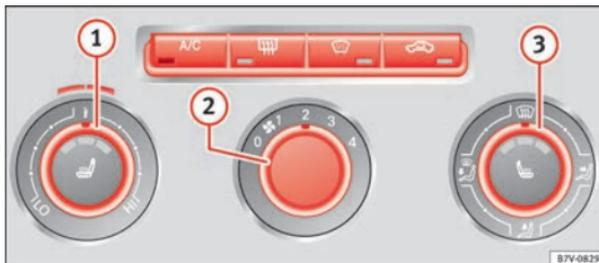
Fig. 51 Pormenor da consola central: Comandos do Ar condicionado manual elétrico.
