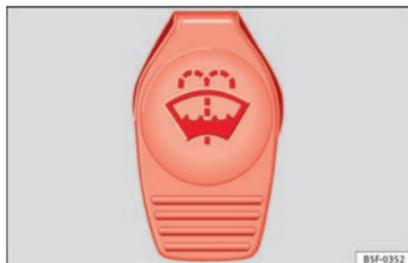
**Fig. 247** No compartimento do motor: tampa do reservatório do lava-vidros.
