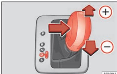
**Fig. 203** Alavanca seletora na posição Tiptronic (veículos com volante à esquerda). Os veículos com o volante à direita estão dispostos de forma simétrica.
