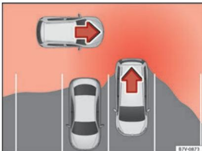
**Fig. 224** Representação esquemática do assistente de saída do estacionamento: zona vigiada ao redor do veículo que está a sair do estacionamento.
