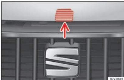
**Fig. 239** Manípulo de destrancamento para a abertura do capô do motor na grelha do radiador.
