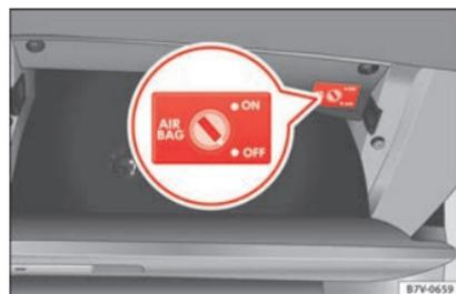
**Fig. 27** No porta-luvas, no lado do passageiro: interruptor de chave para ativar e desativar o airbag frontal do passageiro.
