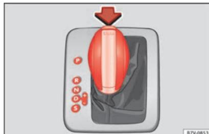
**Fig. 48** Caixa de velocidades automática: posições da alavanca de seleção.
