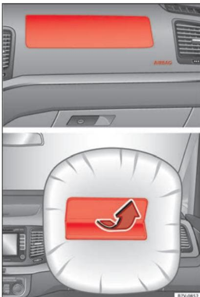
**Fig. 26** Localização e campo de ação do airbag dianteiro do passageiro.
