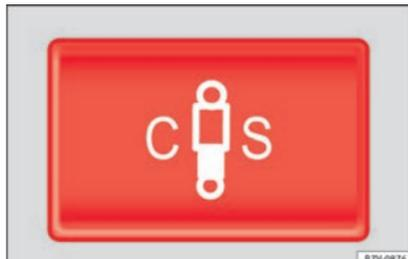
**Fig. 227** Na consola central: botão para ajustar a suspensão adaptativa.
