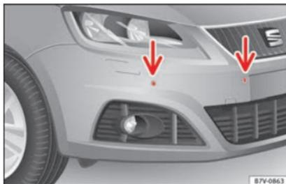
**Fig. 209** Sensores do controlo de estacionamento no para-choques dianteiro.
