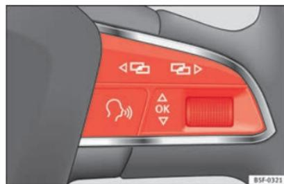
**Fig. 45** Volante multifunções: botões para utilizar os menus do painel de instrumentos.
