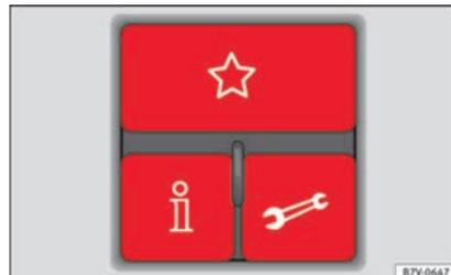
**Fig. 123** Módulo de três botões no teto: comandos do sistema de gestão do telefone.
