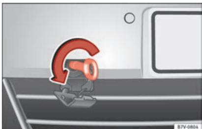
Fig. 72 Na parte direita do para-choques dianteiro: enroscar a argola de reboque.
