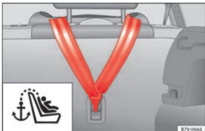
**Fig. 38** Cinto de fixação superior enganchado na bagageira.
