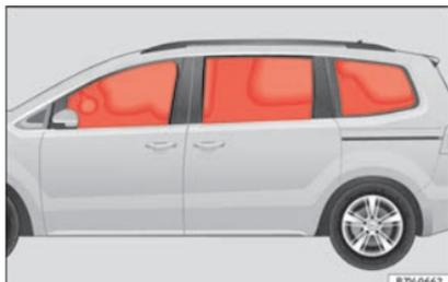
**Fig. 33** Airbags da cabeça insuflados.
