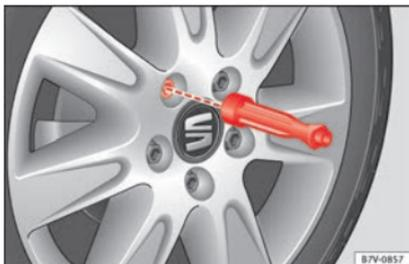
**Fig. 71** Substituição de roda: desapertar os parafusos da roda com o punho da chave de parafusos.
