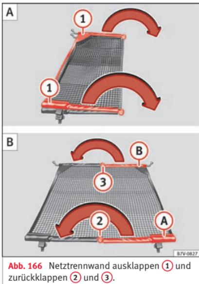
**Abb. 166** Netztrennwand ausklappen ① und zurückklappen ② und ③.
