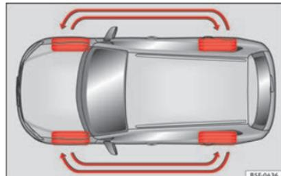
**Abb. 250** Schema für das Tauschen der Räder.
