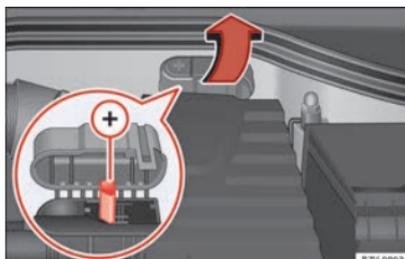
Abb. 74 Im Motorraum: Starthilfe Pluspol (+).
