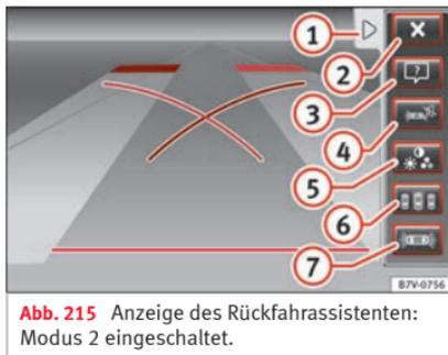
**Abb. 215** Anzeige des Rückfahrassistenten: Modus 2 eingeschaltet.
