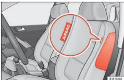
**Abb. 30** Seitlich im Vordersitz: Einbauort des Seitenairbags.
