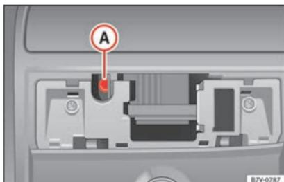
Abb. 16 Innensechskantschraube zum Schließen des Panorama-Schiebedachs.
