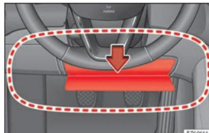
**Abb. 29** Auf der Fahrerseite: Wirkungsbereich des Knieairbags.
