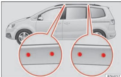
**Abb. 174** Befestigungspunkte für Grundträger und Dachgepäckträger.
