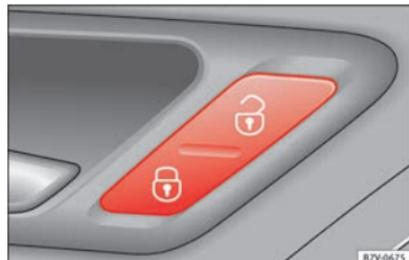
Abb. 130 An der Fahrertür: Zentralverriegelungstaster.
