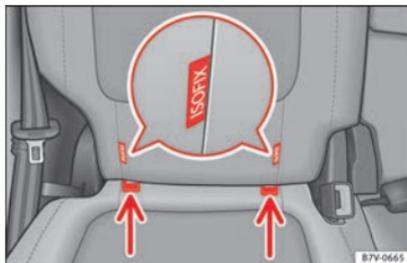
**Abb. 37** Version 2: Kennzeichnung der unteren Kindersitzverankerungspunkte am Fahrzeugsitz.
