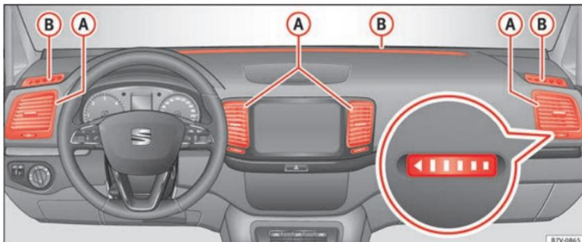
Abb. 196 Luftaustrittsdüsen in der Instrumententafel.
