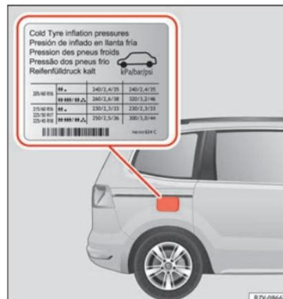
Abb. 251 Einbauort des Reifenfülldruckaufklebers.
