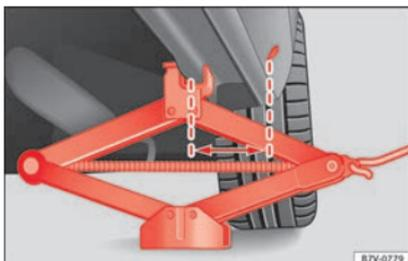
**Abb. 70** Wagenheber hinten an der linken Fahrzeugseite angesetzt.
