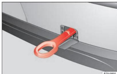
**Abb. 73** Im Stoßfänger hinten rechts: Eingeschraubte Abschleppöse.
