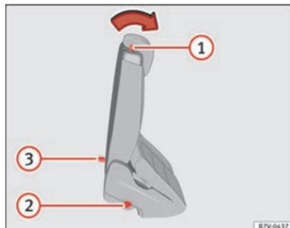
**Abb. 158** Zweite Sitzreihe: Bedienungselemente der Einstiegsilfe.
