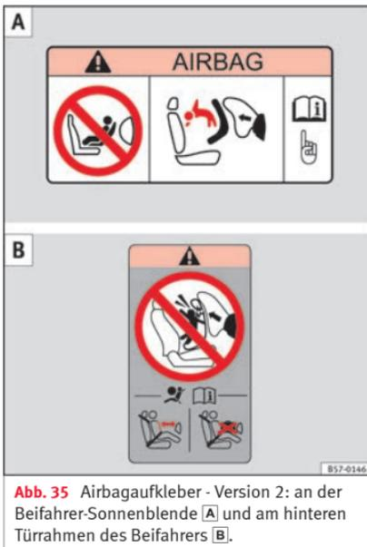
Abb. 35 Airbagaufkleber - Version 2: an der Beifahrer-Sonnenblende [A] und am hinteren Türrahmen des Beifahrers [B].
