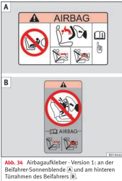
Abb. 34 Airbagaufkleber - Version 1: an der Beifahrer-Sonnenblende [A] und am hinteren Türrahmen des Beifahrers [B].
