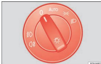
Abb. 40 Instrumententafel: Bedienelement Licht
