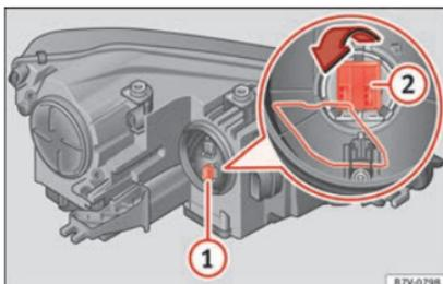
**Abb. 108** Blinklichtlampenhalter (1) und Abbiegelicht (2).
