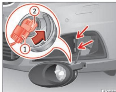
**Abb. 110** Glühlampe im Scheinwerfer auswechseln.
