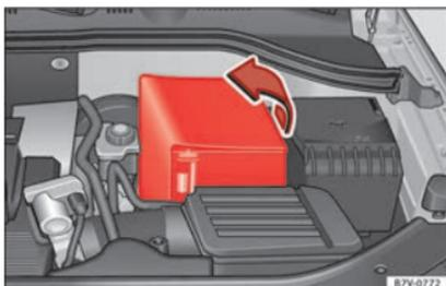
**Abb. 249** Im Motorraum: Manschette für die Fahrzeugbatterie abnehmen.
