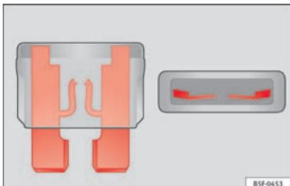
Abb. 61 Darstellung einer durchgebrannten Sicherung.
