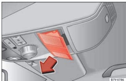
Abb. 15 Im Dachhimmel: Abdeckung entfernen.
