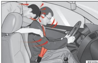
**Abb. 86** Der nicht angegurtete Mitfahrer auf dem Rücksitz schleudert nach vorn auf den angegurteten Fahrer.
