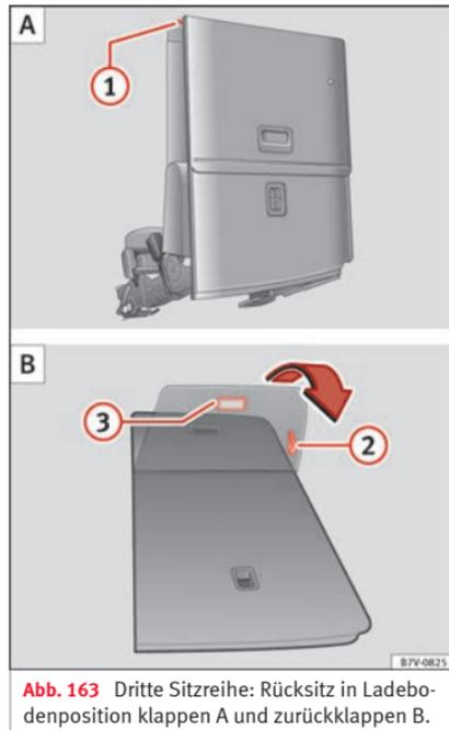
**Abb. 163** Dritte Sitzreihe: Rücksitz in Ladebodenposition klappen A und zurückklappen B.
