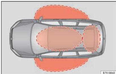
**Abb. 131** Schlüsselloses Schließ- und Startsystem Keyless Access: Näherungsbereiche.
