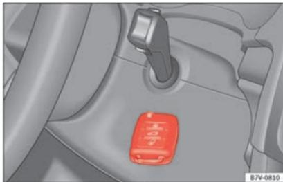
**Abb. 200** Notstart bei Fahrzeugen mit Keyless Access.
