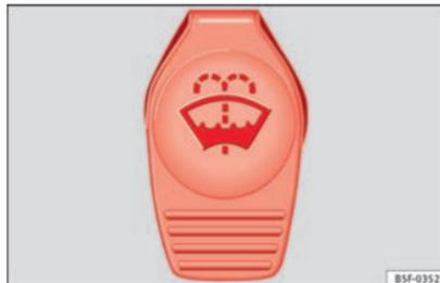
Abb. 58 Im Motorraum: Deckel des Scheibenwaschbehälters.
