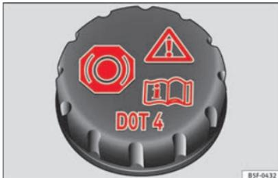
Abb. 246 Im Motorraum: Deckel des Bremsflüssigkeitsbehälters
