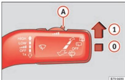
Abb. 144 Scheibenwischerhebel: Regensensor **A** einstellen
