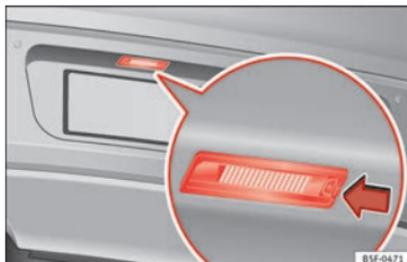
**Abb. 115** Im Stoßfänger hinten: Kennzeichenbeleuchtung.
