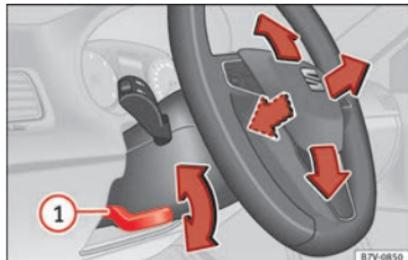
**Abb. 24** Lenkradposition mechanisch einstellen.
