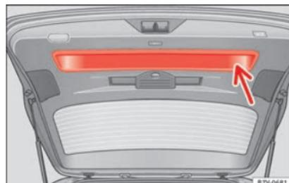
**Abb. 137** Offene Heckklappe: Griffmulde zum Zuziehen
