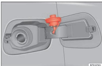
Abb. 53 Tankklappe mit aufgestecktem Tankverschluss.
