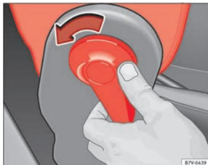
Abb. 160 Klappbare Beifahrersitzlehne entriegeln.
