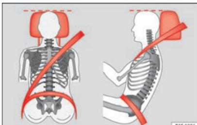
**Abb. 81** Richtiger Gurtbandverlauf und richtige Kopfstützeinstellung.
