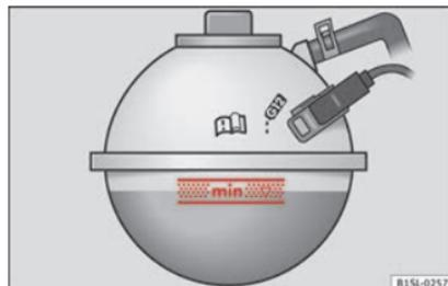
**Abb. 244** Im Motorraum: Markierung am Kühlmittelausgleichsbehälter.
