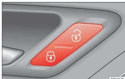
Abb. 2 An der Fahrertür: Zentralverriegelungstaster.
