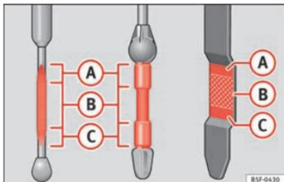
Abb. 241 Ölmesstab mit Motorölstandsmarkierungen.
