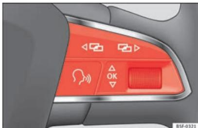
**Abb. 45** Multifunktionslenkrad: Tasten zum Bedienen der Menüs im Kombiinstrument.
