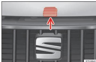
**Abb. 11** Hebel unter der Motorraumklappe.
