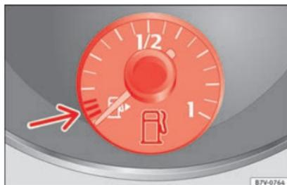
Abb. 234 Im Kombiinstrument: Kraftstoffvorratsanzeige für Benzin und Diesel.
