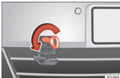
**Abb. 103** Im Stoßfänger vorn rechts: Abschleppöse einschrauben.
