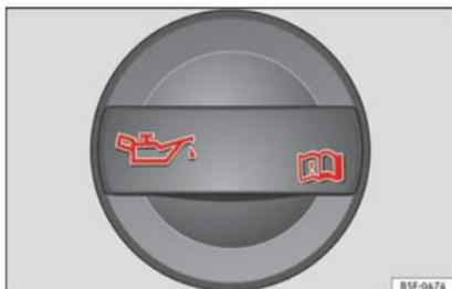
Abb. 242 Im Motorraum: Deckel der Motoröleinfüllöffnung.
