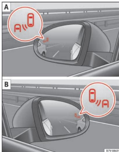
**Abb. 220** In den Außenspiegeln: Anzeige des Blind-Spot-Assistenten.
