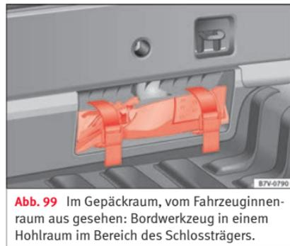
**Abb. 99** Im Gepäckraum, vom Fahrzeuginnenraum aus gesehen: Bordwerkzeug in einem Hohlraum im Bereich des Schlossträgers.
