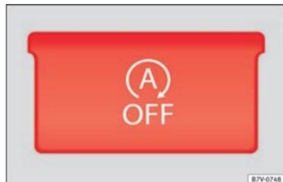
Abb. 207 Detail der Mittelkonsole: Schalter für Start-Stopp-Betrieb »»
