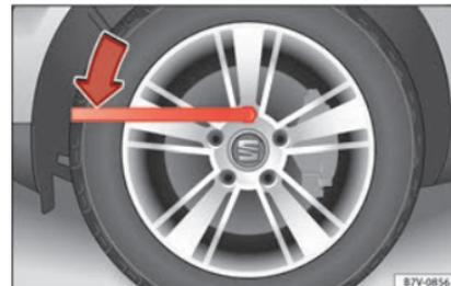
**Abb. 67** Radwechsel: Radschrauben lockern.
