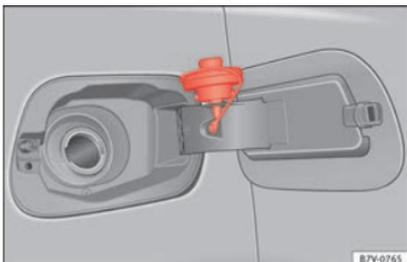
Abb. 235 Geöffnete Tankklappe mit eingehängtem Tankverschluss.
