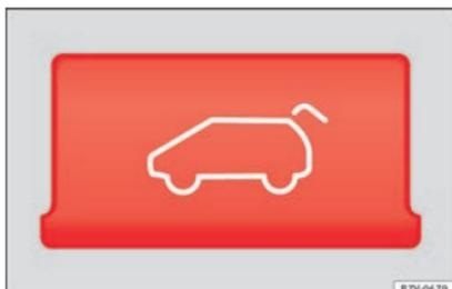
Abb. 6 Ausschnitt aus Mittelkonsole: Entriegelungstaste für Heckklappe.
