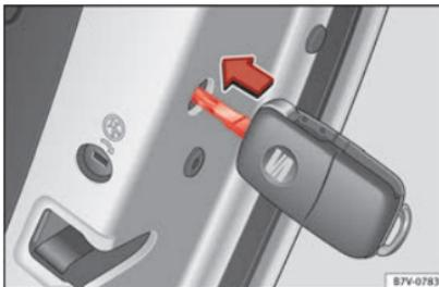
**Abb. 5** Notverriegelung des Fahrzeugs mit dem Fahrzeugschlüssel.
