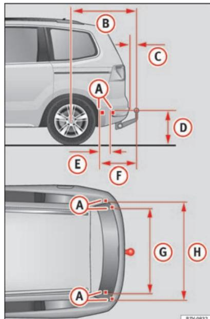
**Abb. 231** Maße und Befestigungspunkte zum Nachrüsten einer Anhängervorrichtung.
