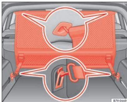
**Abb. 167** Im Gepäckraum: Netztrennwand hinter der zweiten Sitzreihe einbauen
