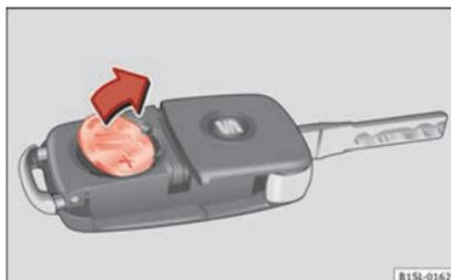
**Abb. 128** Fahrzeugschlüssel: Batterie herausnehmen.
