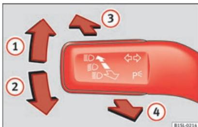
Abb. 41 Blinker- und Fernlichthebel.
