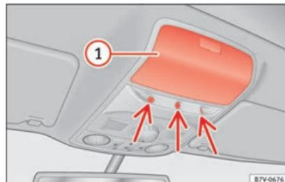
**Abb. 133** In der Dachkonsole: Sensoren der Innenraumüberwachung.
