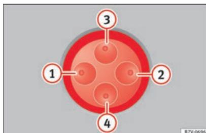
**Abb. 19** Lendenwirbelstütze einstellen.
