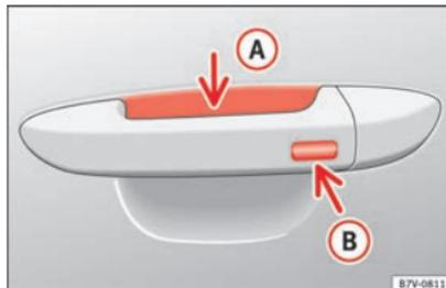
**Abb. 132** Schlüsselloses Schließ- und Startsystem Keyless Access: Sensorfläche **A** zur Entriegelung auf der Innenseite des Türgriffs und Sensorfläche **B** zur Verriegelung auf der Außenseite des Türgriffs.
