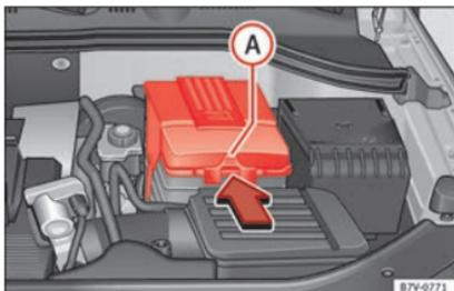
**Abb. 248** Im Motorraum: Abdeckung für die Fahrzeugbatterie abnehmen.
