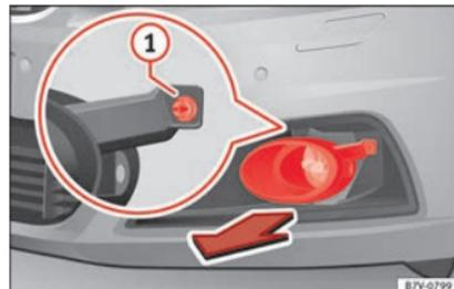
**Abb. 109** Im Stoßfänger vorn rechts: Ausbau der Scheinwerfer.
