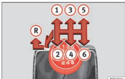
**Abb. 47** Schaltschema des 6-Gang-Schaltgetriebes.
