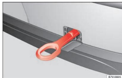
**Abb. 104** Im Stoßfänger hinten rechts: Eingeschraubte Abschleppöse.
