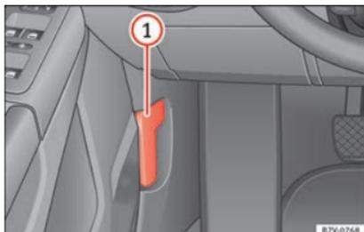
**Abb. 10** Entriegelungshebel im Fahrerfußraum.
