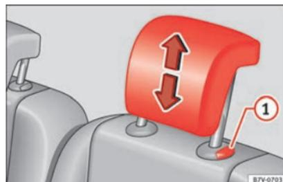
**Abb. 151** Kopfstützeinstellung der zweiten der dritten Sitzreihe.
