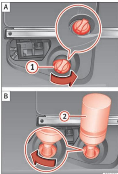
**Abb. 237** AdBlue-Tank mit Verschluss des Tankeinfüllstutzens und Nachfüllflasche.
