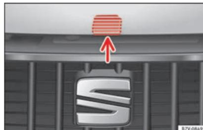
**Abb. 239** Entriegelungshebel zum Öffnen der Motorraumklappe im Kühlergrill.
