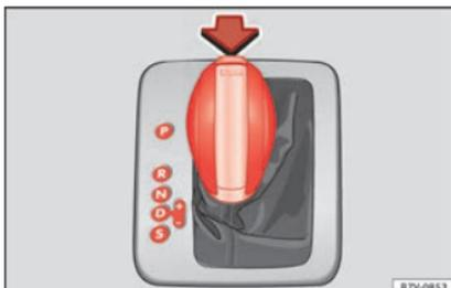
Abb. 48 Automatisches Getriebe: Wählhebelsstellungen.
