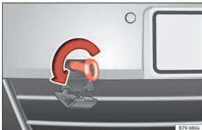
**Abb. 72** Im Stoßfänger vorn rechts: Abschleppöse einschrauben.
