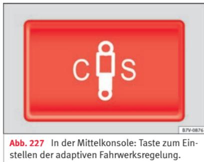
**Abb. 227** In der Mittelkonsole: Taste zum Einstellen der adaptiven Fahrwerksregelung.
