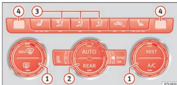
Abb. 52 Detail in der Mittelkonsole: Bedienelemente der Climatronic.
