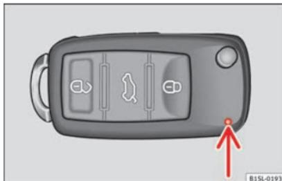
**Abb. 126** Kontrollleuchte im Fahrzeugschlüssel.
