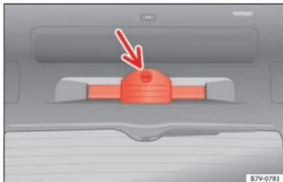
**Abb. 98** An der Heckklappe: Warndreieckhalter.
