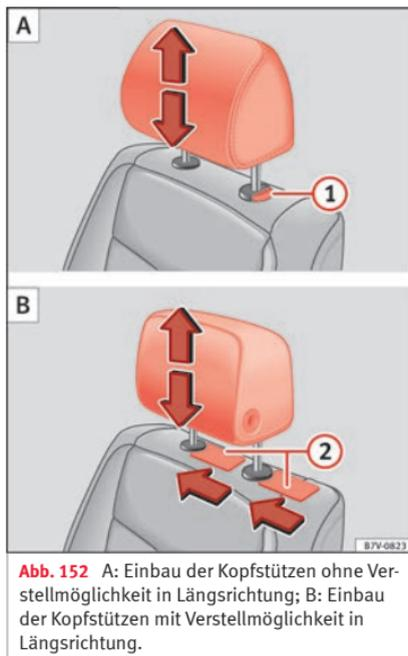
**Abb. 152** A: Einbau der Kopfstützen ohne Verstellmöglichkeit in Längsrichtung; B: Einbau der Kopfstützen mit Verstellmöglichkeit in Längsrichtung.
