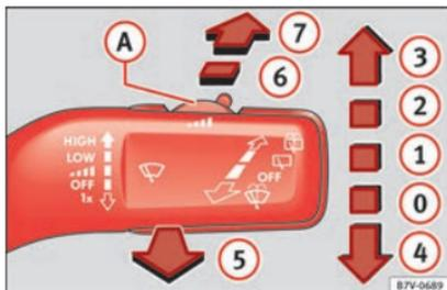
Abb. 43 Bedienung von Windschutz- und Heckscheibenwischer
