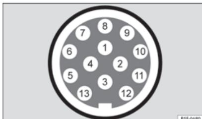
**Abb. 230** Schematische Darstellung: Zuweisung der Steckverbinderstifte für Anhängerstrom.
