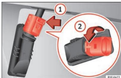
**Abb. 116** Kennzeichenleuchte: Lampenträger ausbauen.
