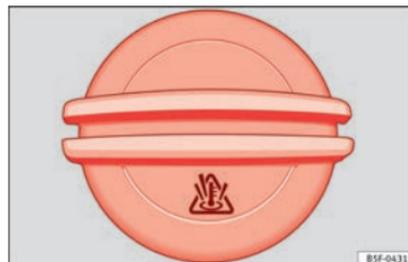
**Abb. 56** Motorraum: Deckel des Motor Kühlmittelausgleichsbehälters
