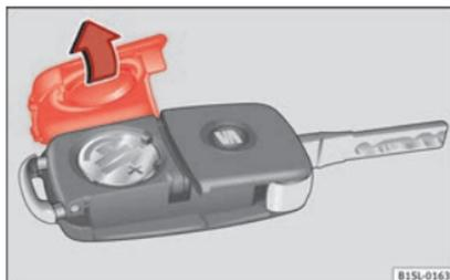
**Abb. 127** Fahrzeugschlüssel: Deckel für Batteriefach.
