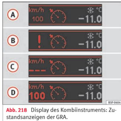
**Abb. 218** Display des Kombiinstrument: Zustandsanzeigen der GRA.
