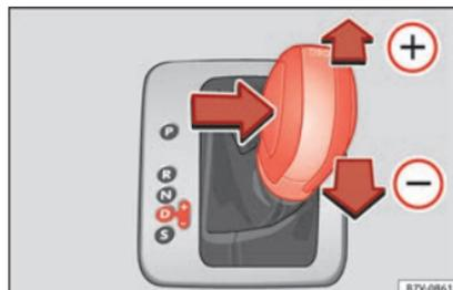
Abb. 203 Wählhebel in Tiptronic-Stellung (Linkslenker). Rechtslenker spiegelbildlich.
