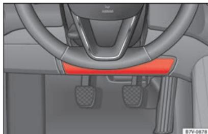
**Abb. 28** Auf der Fahrerseite: Einbauort des Knieairbags.
