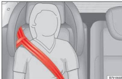
**Abb. 96** Integrierter Kindersitz: Gurtbandverlauf mit Gurtführungsschleufe.
