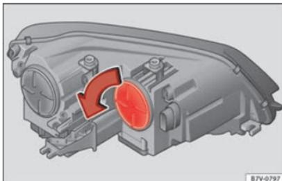
**Abb. 107** Im Motorraum: Blinkerabdeckung.
