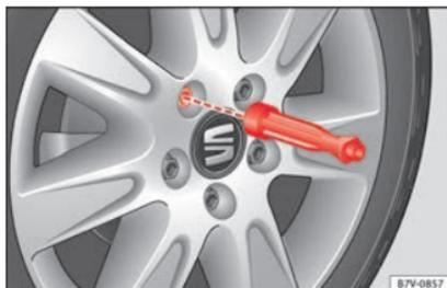
Abb. 71 Radwechsel: Radschrauben mit dem Schraubendrehergriff abschrauben.
