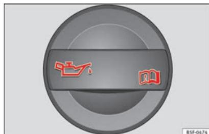
Abb. 55 Deckel der Motoröl-Einfüllöffnung im Motorraum
