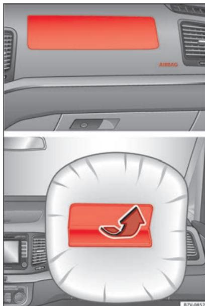
**Abb. 26** Einbauort und Wirkungsbereich des Beifahrer-Frontairbags.
