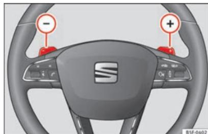
Abb. 204 Lenkrad mit zwei Schaltwippen für die Tiptronic.
