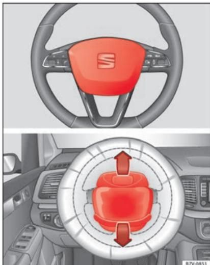
**Abb. 25** Einbauort und Wirkungsbereich des Fahrer-Frontairbags.
