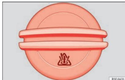
**Abb. 245** Im Motorraum: Deckel des Kühlmittelausgleichsbehälters.
