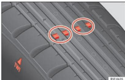
Abb. 252 Reifenprofil: Verschleißanzeiger.
