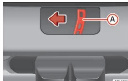
Abb. 9 Vom Gepäckraum aus: Heckklappe notentriegeln.
