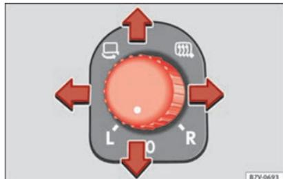
**Abb. 23** An der Fahrertür: Drehknopf für die Außenspiegel.
