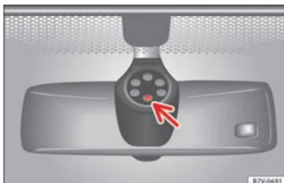
Abb. 145 Sensitive Fläche des Regensensors.
