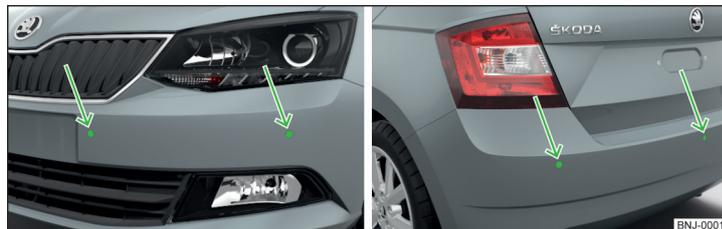
Илл. 133 Место установки датчиков с левой стороны автомобиля: спереди/сзади
