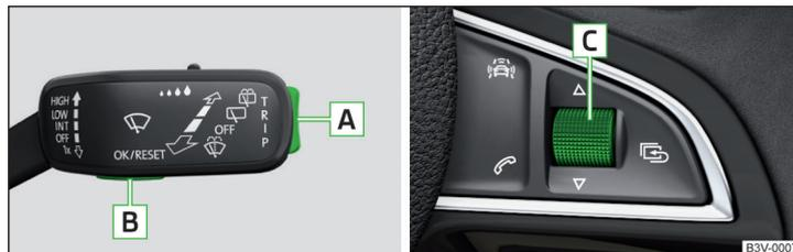
Илл. 28 Клавиши/регулятор на подрулевом переключателе/многофункциональном рулевом колесе
