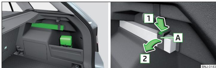
Илл. 176 Расположение аптечки и знака аварийной остановки — вариант 2/снятие крепёжной ленты
