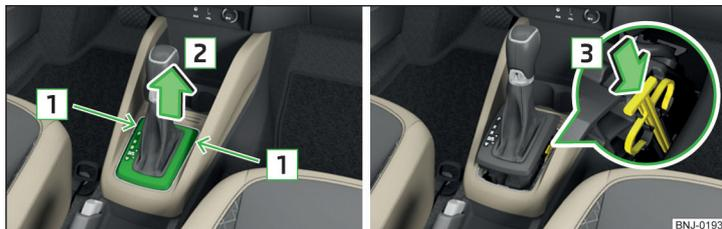
Илл. 196 Аварийная разблокировка рычага селектора
