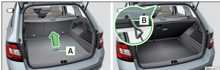
Илл. 109 Подъём/фиксация трансформируемого фальшпола багажного отсека
