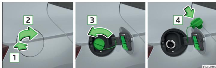
Илл. 164 Открыть лючок/отвернуть пробку заливной горловины/насадить пробку на крышку лючка
