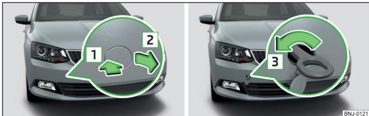
Илл. 190 Снятие крышки/установка буксирной проушины
