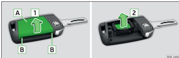
Илл. 192 Ключ: Снятие крышки/извлечение элемента питания
