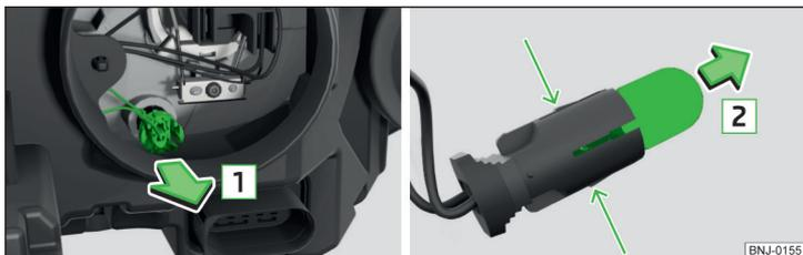
Fig. 208 Sostituzione della lampadina della luce di posizione
