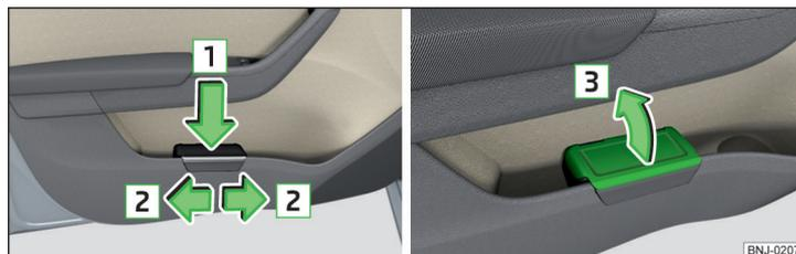
Fig. 78 Portarifiuti: inserimento e spostamento / apertura
