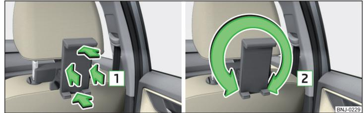
Fig. 92 Piegare e ruotare il supporto
