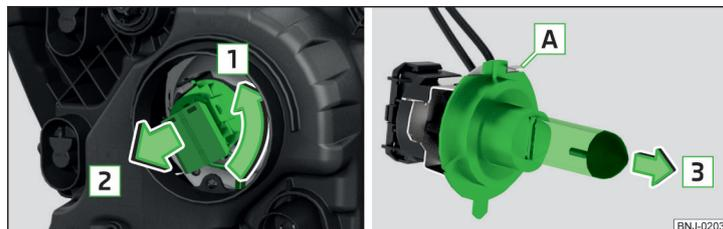
Fig. 211 Sostituzione della lampadina per gli abbaglianti
