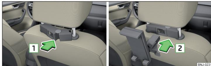
Fig. 90 Applicazione dell'adattatore / montaggio del supporto
