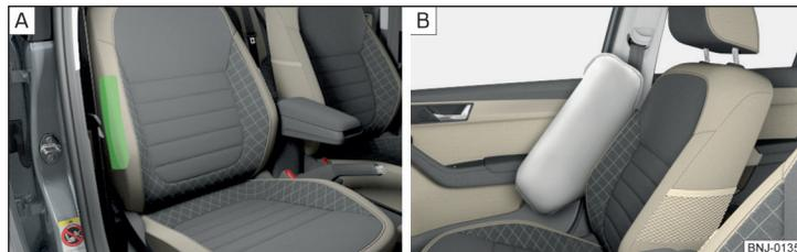
Fig. 10 Ubicazione dell'airbag laterale nel sedile anteriore / Airbag riempito con gas
