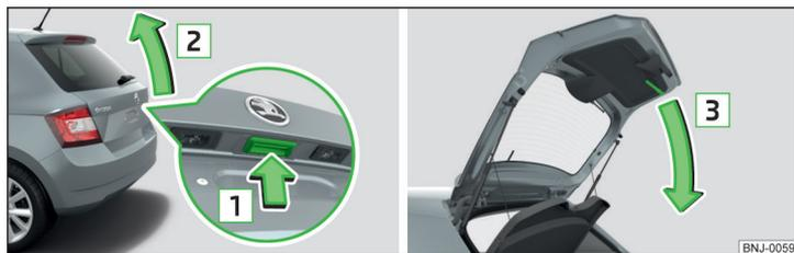
Fig. 43 Apertura/chiusura del portellone bagagliaio
