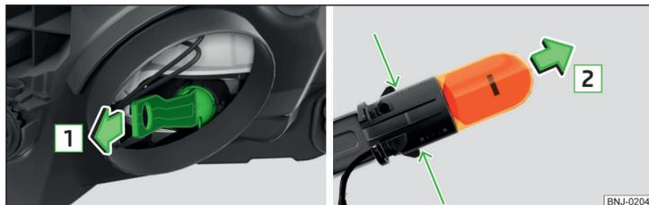
Fig. 212 Sostituzione della lampadina per l'indicatore di direzione
