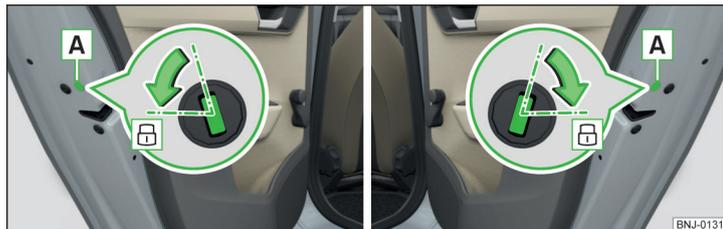
Fig. 194 Bloccaggio di emergenza: porta posteriore sinistra/destra
