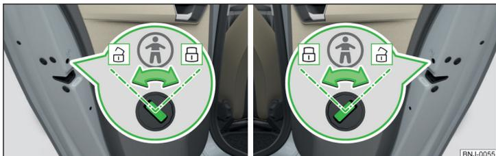
Fig. 41 Porta posteriore: inserimento/disinserimento sicurezza bambini
