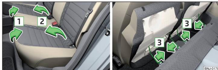
Fig. 66 Ribaltamento in avanti del divano posteriore / Estrazione del divano posteriore diviso
