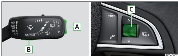
Fig. 28 Tasti/manopola di regolazione: sulla leva di comando / sul volante multifunzione
