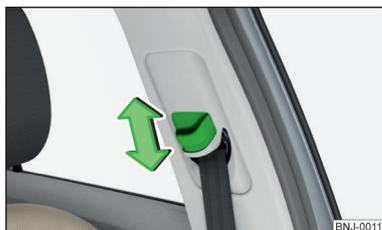
Fig. 6 Sedile anteriore: regolazione dell'altezza della cintura
