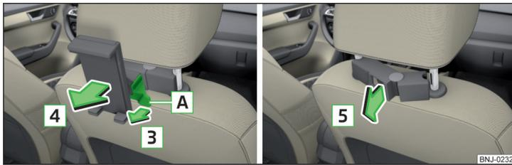
Fig. 91 Smontaggio del supporto / rimozione dell'adattatore
