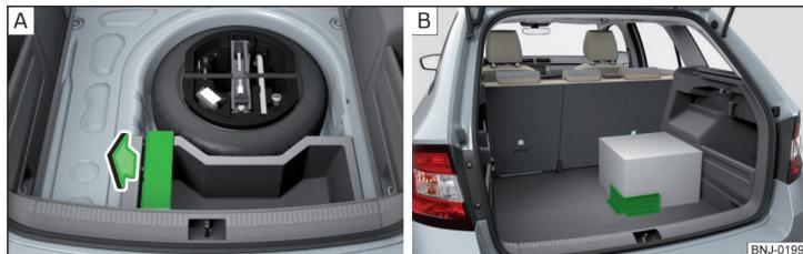
Fig. 104 Estrazione elemento Cargo / esempio di fissaggio del carico mediante l'elemento Cargo
