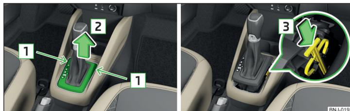
Fig. 196 Sbloccaggio d'emergenza della leva selettoria
