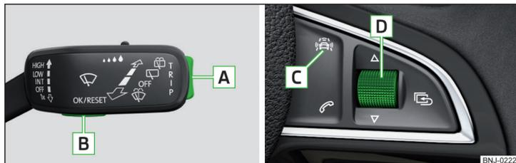
Fig. 147 Tasti/manopola di regolazione: sulla leva di comando / sul volante multifunzione
