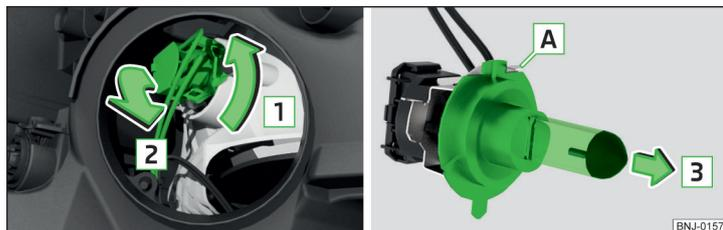
Fig. 210 Sostituzione della lampadina delle luci anabbaglianti
