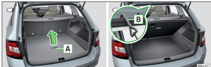
Fig. 109 Sollevamento del piano di carico variabile / fissaggio del piano di carico variabile
