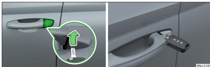
Fig. 193 Maniglia della porta lato conducente: cilindro di chiusura coperto / cilindro di chiusura con chiave
