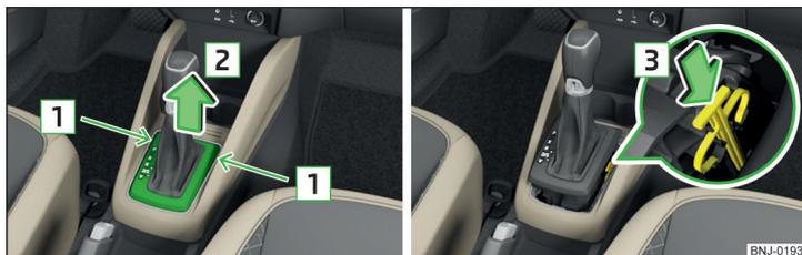
Fig. 196 Déverrouillage de secours du levier sélecteur
