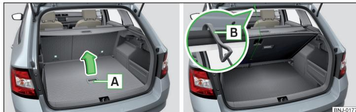
Fig. 109 Soulevez le plancher de chargement variable / fixez le plancher de chargement variable
