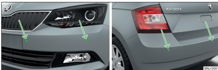
Fig. 133 Lieu d'installation des capteurs sur le côté gauche du véhicule : avant/arrière
