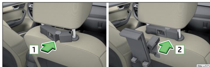
Fig. 90 Fixez l'adaptateur / monter le support
