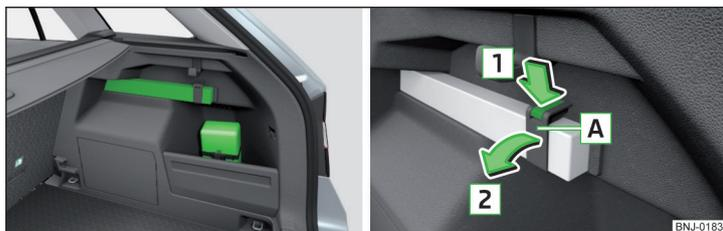
Fig. 176 Emplacement de la trousse de secours et du triangle de signalisation version 2 / retirer la lanière
