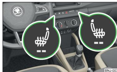
Fig. 63 Touches pour le chauffage des sièges avant
