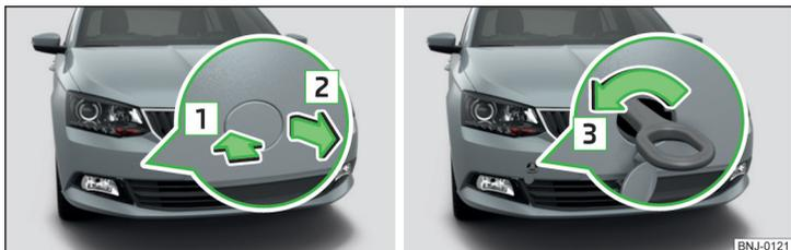
Fig. 190 Démontage du cache/montage de l'œillet de remorquage
