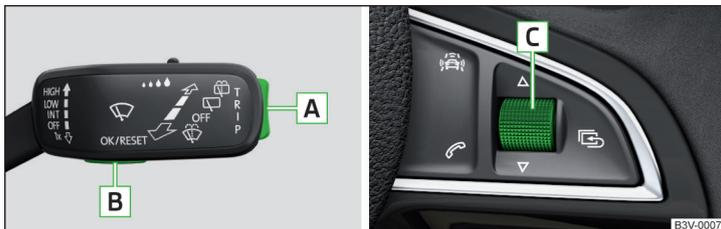
Fig. 28 Touches / molette de réglage : sur la manette de commande / sur le volant multi-fonction
