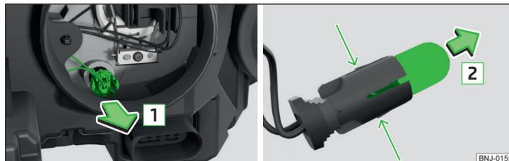
Fig. 208 Remplacement de l'ampoule du feu de position
