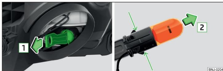
Fig. 212 Remplacement de l'ampoule du clignotant
