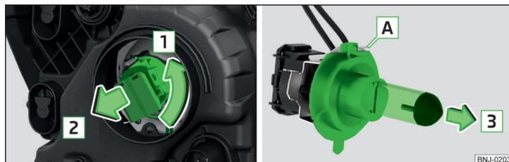
Fig. 211 Remplacement de l'ampoule des feux de route
