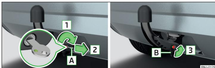
Fig. 156 Verrouiller le verrou et retirer la clé / enficher le cache sur le verrou
