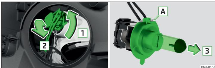
Fig. 210 Remplacement de l'ampoule du feu de croisement
