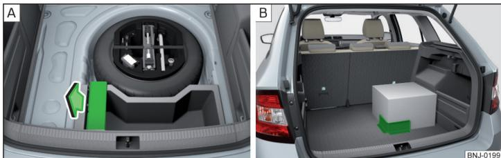
Fig. 104 Enlevez les éléments Cargo / Exemple de fixation d'un charge-ment à l'aide des éléments Cargo
