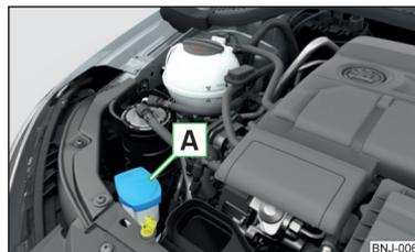
Fig. 167 Depósito de agua del lavacristales
