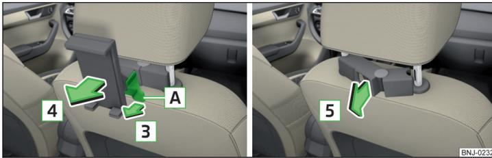
Fig. 91 Desinstalar el soporte / retirar el adaptador
