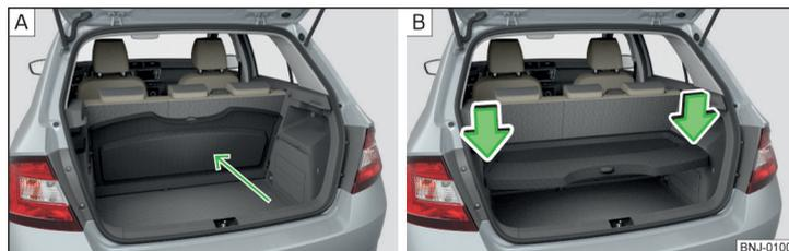
Fig. 101 Cubierta del maletero: Detrás del respaldo/ guardado en la posición inferior
