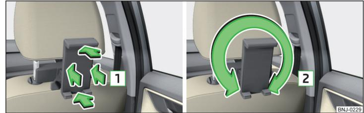
Fig. 92 Voltear y girar el soporte
