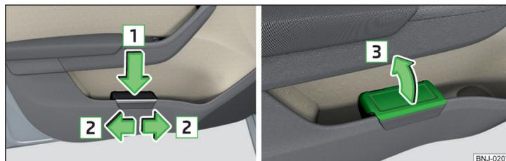
Fig. 78 Cubo de basura: colocar y mover / abrir
