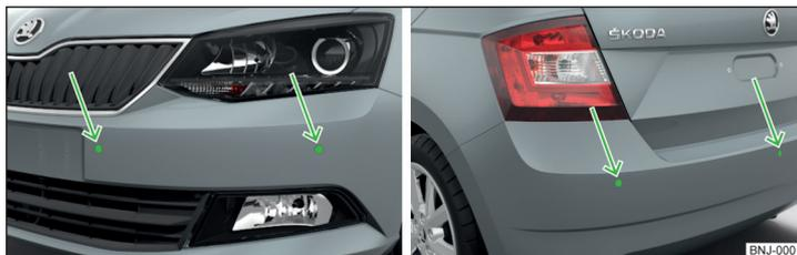
Fig. 133 Lugar de instalación de los sensores del lado izquierdo del vehículo: delantero / trasero
