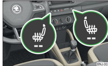
Fig. 63 Teclas para la calefacción de asientos delanteros
