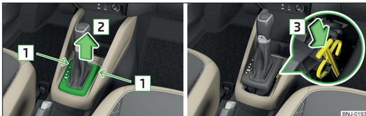
Fig. 196 Desbloqueo de emergencia de la palanca selectora
