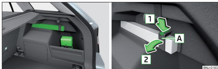
Fig. 176 Posicionamiento del botiquín y triángulo reflectante de advertencia Variante 2 / Soltar la banda de fijación
