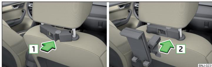
Fig. 90 Colocar el adaptador / instalar el soporte
