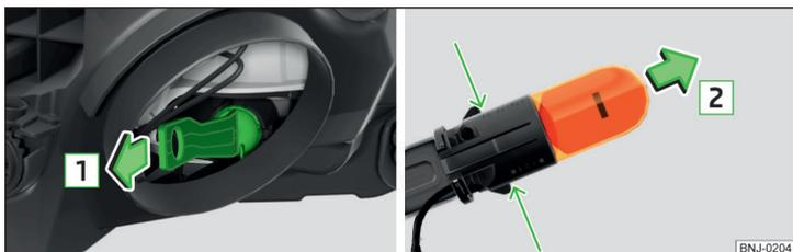
Fig. 212 Cambiar la bombilla para luz intermitente
