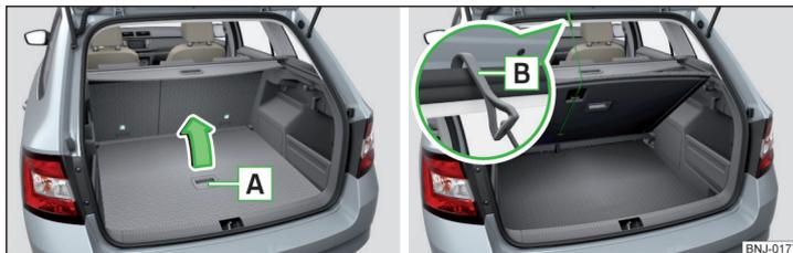
Fig. 109 Subir el suelo de carga variable / fijar el suelo de carga variable
