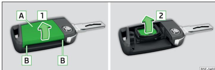
Fig. 192 Llave con mando a distancia: Desmontar la tapa / extraer la pila
