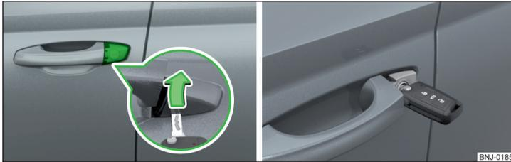
Fig. 193 Tirador en la puerta del conductor: bombín de cierre tapado / bombín de cierre con llave
