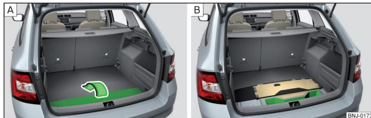
Fig. 103 Abatir el suelo / compartimento guardaobjetos debajo del suelo
