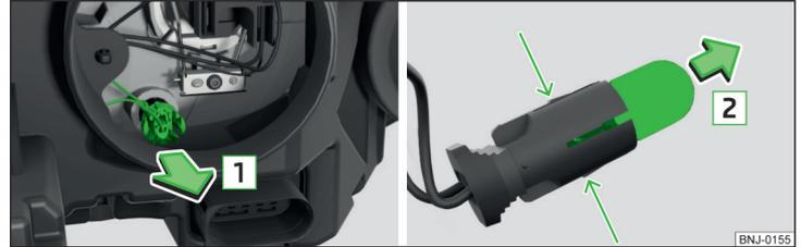
Fig. 208 Cambiar la bombilla de la luz de posición
