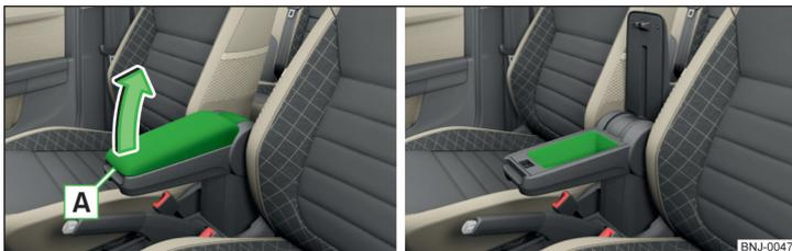
Fig. 81 Abrir el compartimento guardaobjetos/Compartimento guardaobjetos
