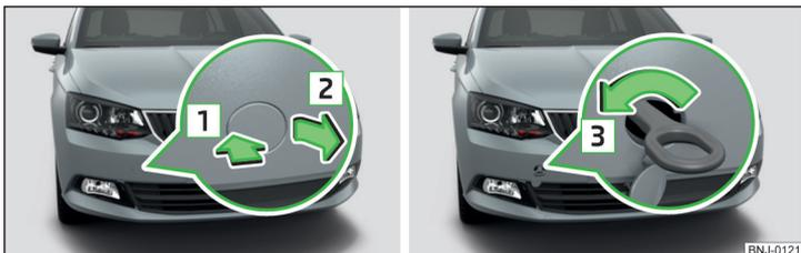
Fig. 190 Desmontaje de la caperuzita protectora / montaje de la argolla de remolque
