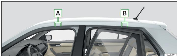
Fig. 115 Puntos de fijación
