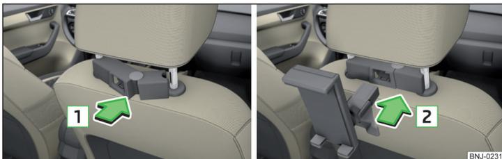
Fig. 85 Instalar: adaptador / suporte
