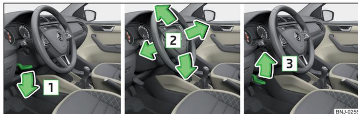
Fig. 3 Ajustar a posição do volante
