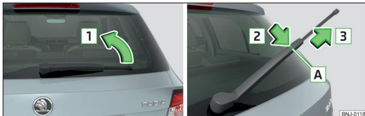
Fig. 199 Substituir a escova do limpa-vidros do vidro traseiro
