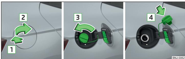
Fig. 166 Abrir a tampa do depósito / desenroscar a fechadura do depósito / encaixar a fechadura do depósito na tampa do depósito
