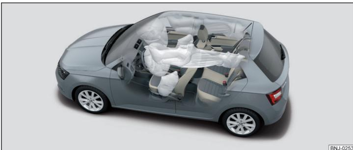
Fig. 8 Airbags insuflados com gás
