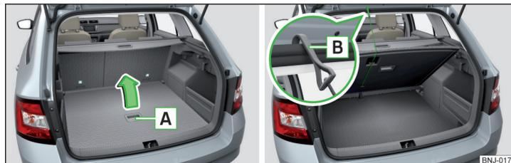
Fig. 104 Levantar o piso de carga variável / fixar o piso de carga variável
