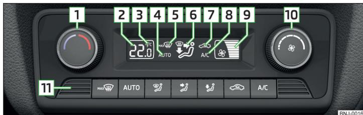
Fig. 112 Elementos de comando do Climatronic
