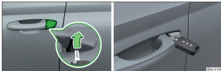
Fig. 193 Manipulo na porta do condutor: abrir tampa do canhão / canhão de fecho com chave
