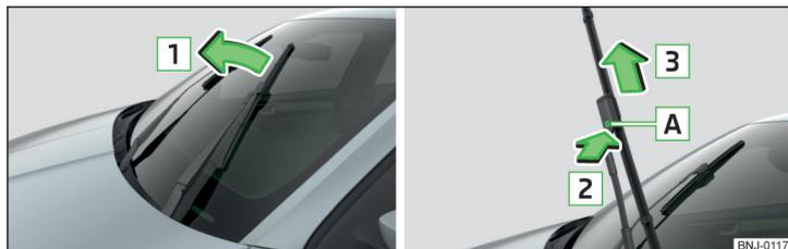
Fig. 198 Substituir a escova do limpavidros do para-brisas
