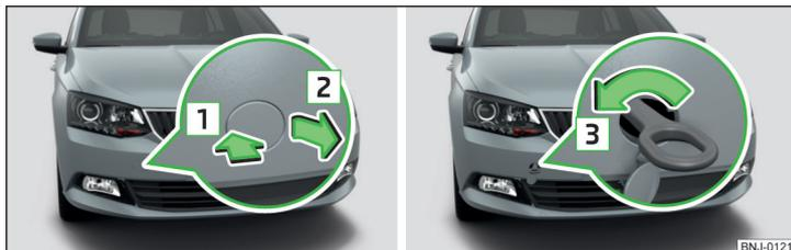
Fig. 190 Retirar a tampa / montar o anel de reboque
