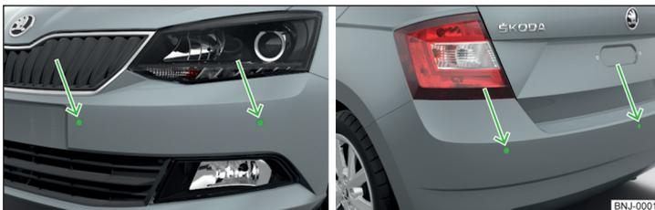
Fig. 127 Local de instalação dos sensores no lado esquerdo do veículo: à frente/atrás
