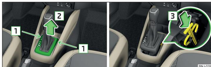
Fig. 196 Remover a tampa / Desbloquear a alavanca seletora
