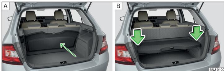
Fig. 96 Cobertura da bagageira: atrás dos encostos dos bancos traseiros / arrumada na posição inferior
