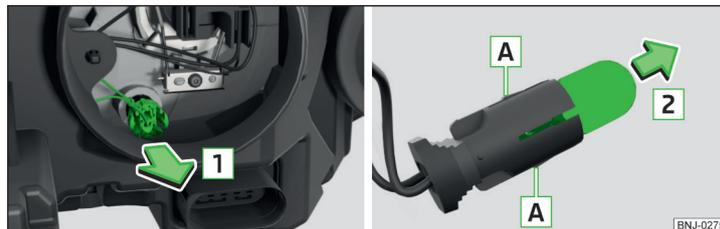
Fig. 210 Substituição da lâmpada incandescente dos mínimos
