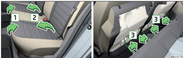
Fig. 57 Rebatendo o banco traseiro para frente / retirando o banco traseiro dividido
