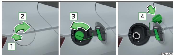
Fig. 166 Abrir a tampa do depósito / desenroskar a fechadura do depósito / encaixar a fechadura do depósito na tampa do depósito
