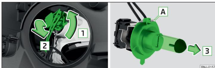
Fig. 212 Substituição da lâmpada incandescente de médios
