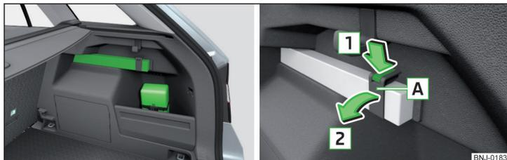
Fig. 177 Localização da caixa de primeiros socorros e triângulo de sinalização - Variante 2 / soltar o triângulo de sinalização
