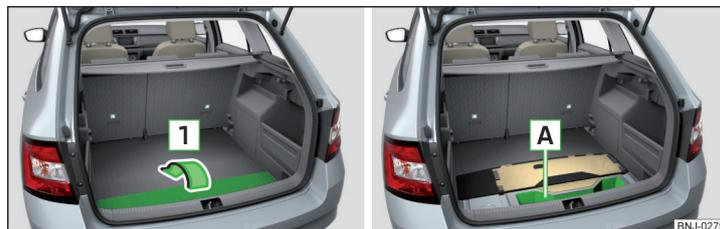
Fig. 99 Virar o piso / compartimento de arrumação por baixo do piso
