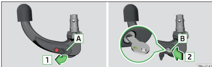
Fig. 151 Retire a capa do fecho / meter a chave no fecho
