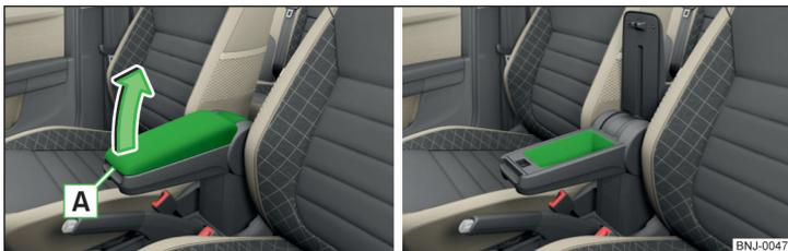
Fig. 75 Abrir o compartimento de arrumação / Compartimento de arrumação
