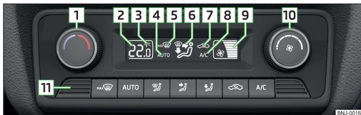
Fig. 112 Elementos de comando do Climatronic
