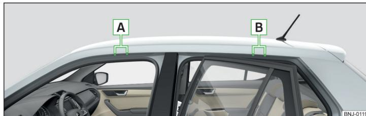
Fig. 110 Pontos de fixação
