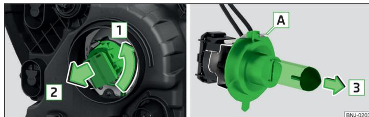
Fig. 213 Substituição da lâmpada incandescente dos máximos
