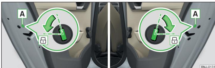
Fig. 194 Trancamento de emergência: Porta traseira esquerda/direita
