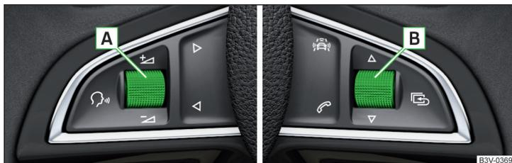
Fig. 25 Teclas/rodas de ajuste: no volante multifunções
