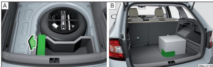
Fig. 100 Retirar el elemento de carga / Ejemplo de fijación de la carga por medio del elemento de carga
