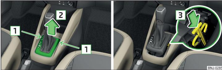
Fig. 196 Retirar la tapa / desbloquear la palanca selectora
