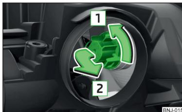
Fig. 209 Cambiar la bombilla para luz intermitente delantera
