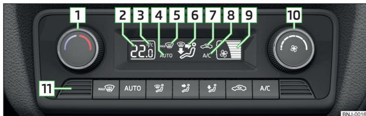
Fig. 112 Elementos de mando del Climatronic
