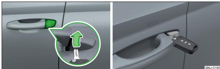
Fig. 193 Tirador en la puerta del conductor: Abrir el cubrimiento del cierre / Bombín de cierre con llave
