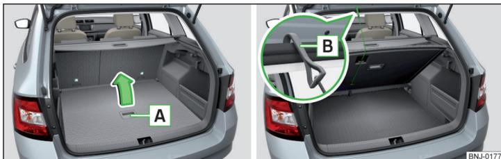
Fig. 104 Subir el suelo de carga variable / fijar el suelo de carga variable
