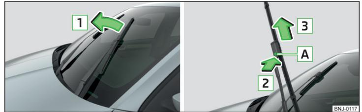
Fig. 198 Cambiar la escobilla limpiacristales del parabrisas
