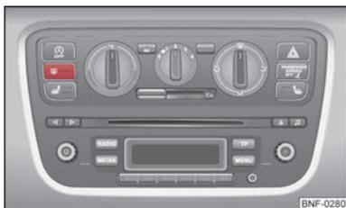
Abb. 27 Schalter für Heckscheibenbeheizung
