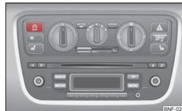
Abb. 64 Taste für das START-STOPP-System
