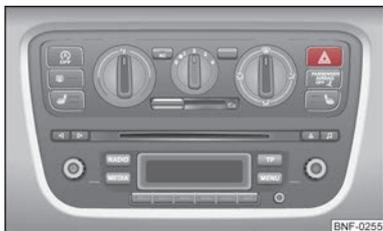
Abb. 23 Schalttafel: Schalter für Warnblinkanlage
