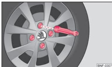
Abb. 105 Radwechsel: Radschrauben mit dem Schraubendrehergriff lockern
