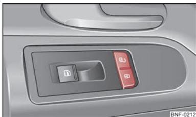
Abb. 12 Zentralverriegelungstaste
