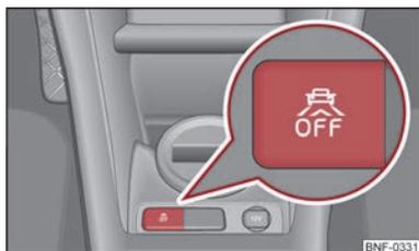
Abb. 66 Unterer Teil der Mittelkonsole: Taste für das City Safe Drive-System.
