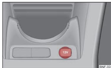
Abb. 44 Mittelkonsole: 12-Volt-Steckdose
